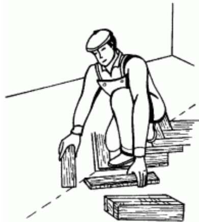
Рис. 17. Укладка маячной елки.
