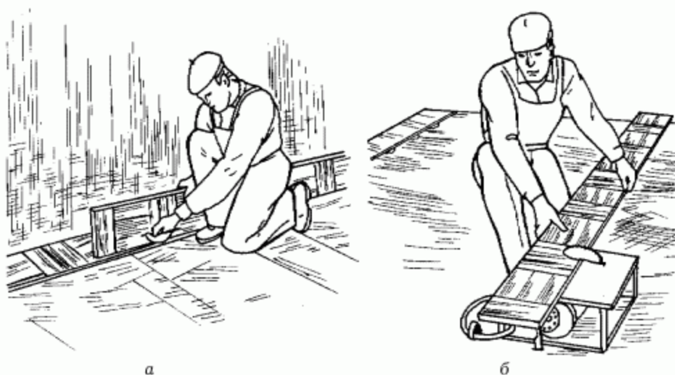
Рис. 43. Разметка (а) и отпиливание (б) второй доски.
