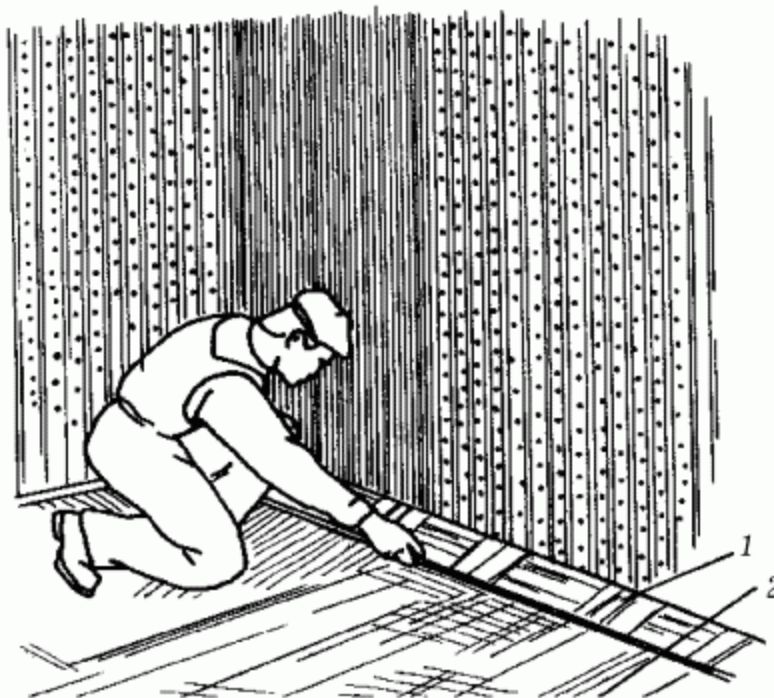
Рис. 42. Настил первого ряда досок: 1 – паркетная доска; 2 – древесно-волокнуистая плита.
