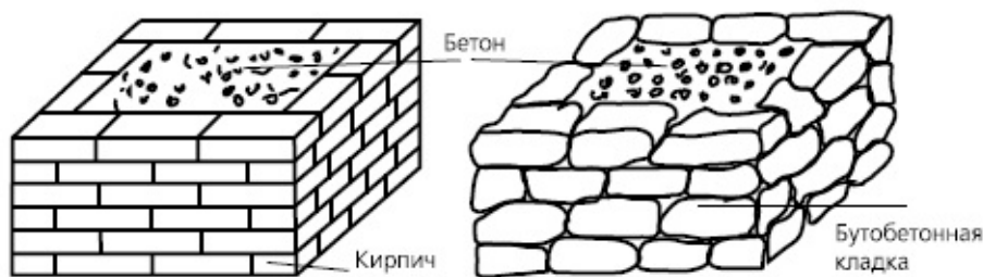
Рисунок 2. Устройство наземной части фундамента
