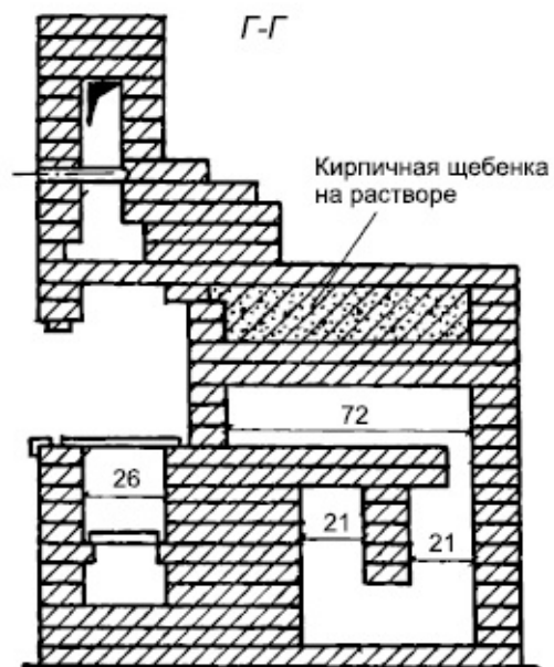
Рисунок 51 (окончание). Устройство печи «Экономка»
