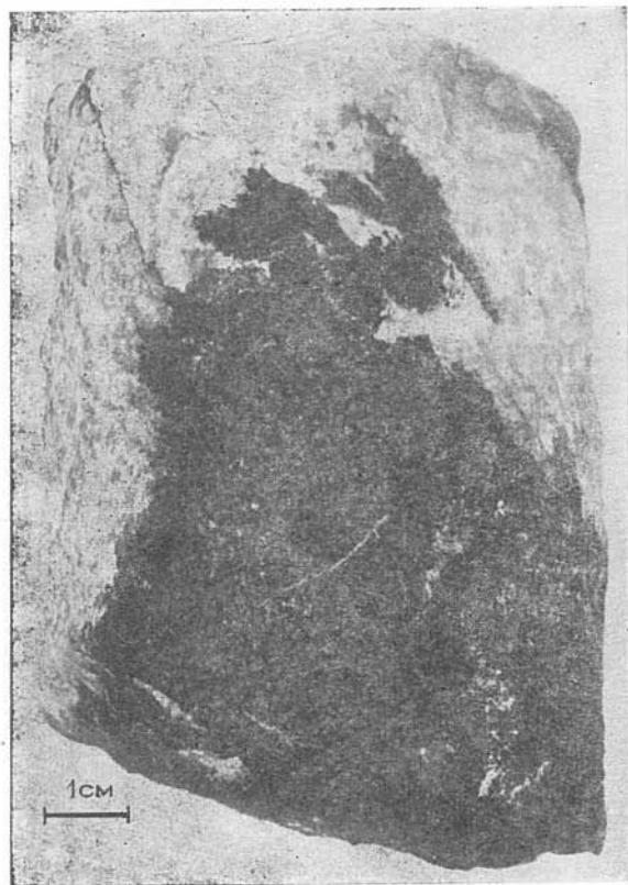
Рис. 5. Кайма магнетита (черное) на контакте пироксенового скарна с мрамором. Фото штуфа керна, обр. 90, скв. 44, глуб. 113 м.
