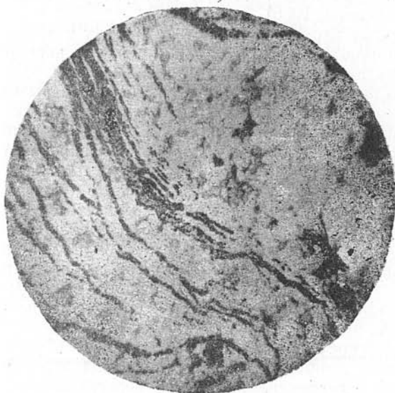
Рис. 41. Цепочковидные агрегаты перекристаллизованного магнетита (черное) среди кальцит-кварцевой массы (светлое).
