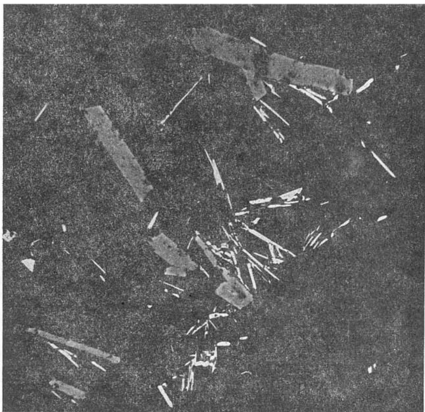
Рис. 31. Выделения мушкетовита (серое) и гематита (светлое) в кварце (темное — основная масса). Характерно, что тонкие пластинки гематита не несут признаков восстановления в магнетит. Полированный шлиф. Увел. 170.
