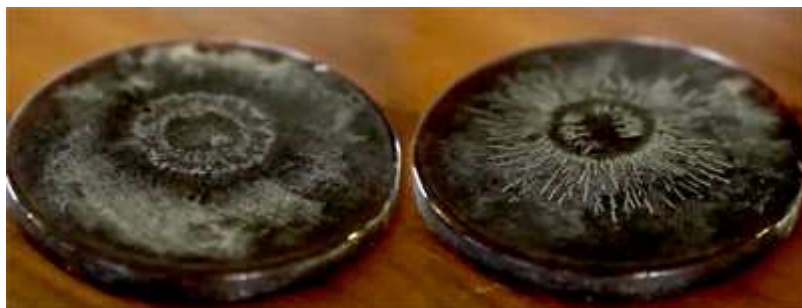
Рис. 9-9-2. Пылевые фигуры от положительного и отрицательного круглого электрода.
