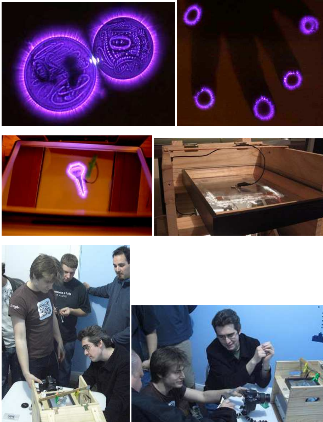
Рис. 15-5-8. Кирлиан-фотографии автор Mechatronics Guy . 2009. Фотографии сделаны с помощью самодельной Кирлиан-камеры. Снимки сделаны с использованием камеры EX-Z1200 (Casio Computer Co., LTD.) в режиме 800 ISO.
