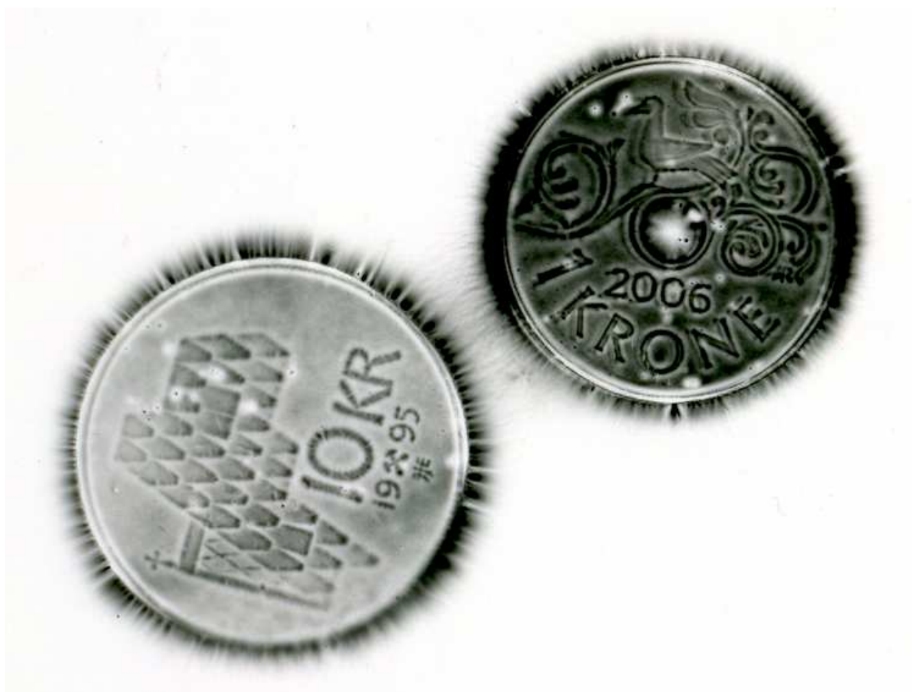
Рис. 15-5-24. Кирлиан-фотографии автор Heather . 2008. Для регистрации разряда использует газовую пьезозажигалку.
