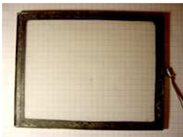
Рис. 15-4-11. Прозрачный электрод для регистрации свечения.
