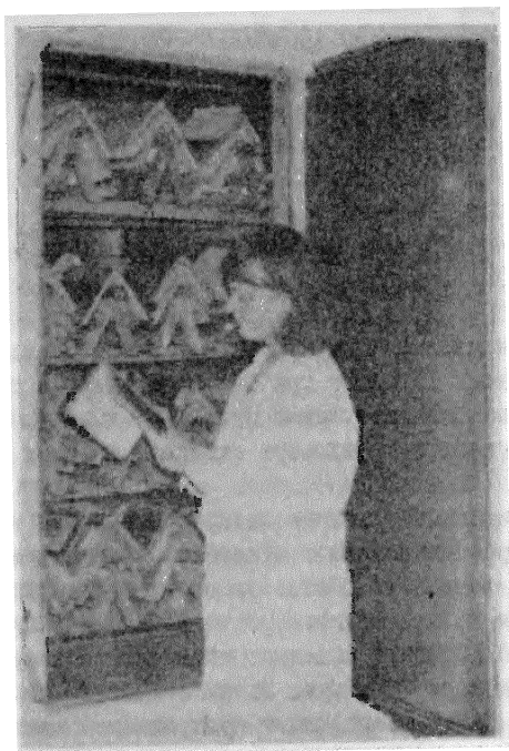
Рис. 2. Дезинфекция книг в электрической камере
