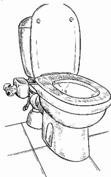
Рис. 4. Унитаз-компакт со специальным устройством для слива воды.
