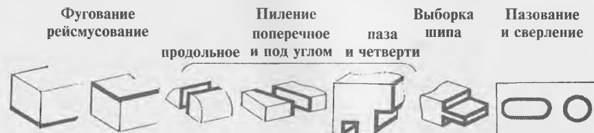
Рис. 81. Схемы выполняемых операций на комбинированных станках
