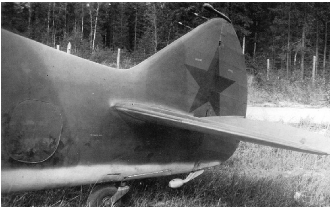
Хвостовое оперение ЛаГГ-3 7-й серии; видны весовые балансиры руля направления сверху и снизу.
