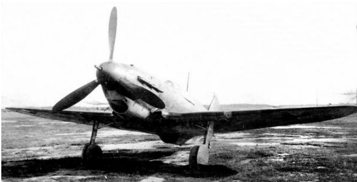
ЛаГГ-3 № 31213445 с мотором М-105ПФ и винтом ВИШ-105СВ. Он был вооружён пушкой НС-37 и пулемётом БС. Государственные испытания, август 1942 г.
