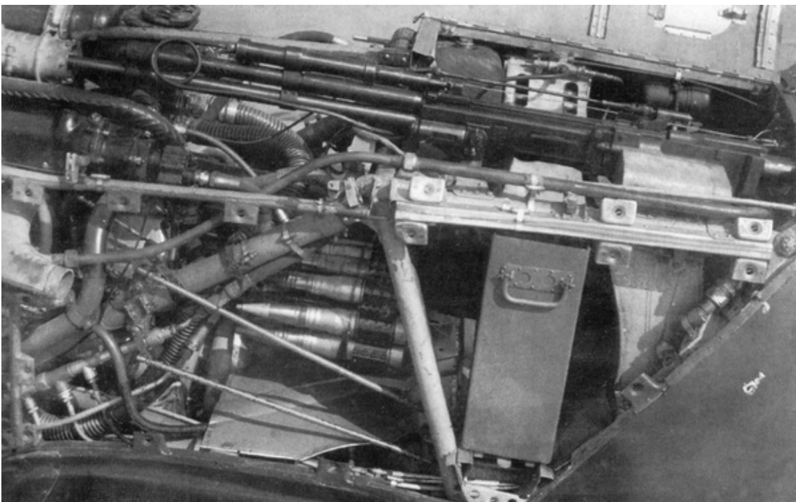
Установка 37-мм пушки НС-37 и 12,7-мм пулемёта БС. Панели капота сняты.
