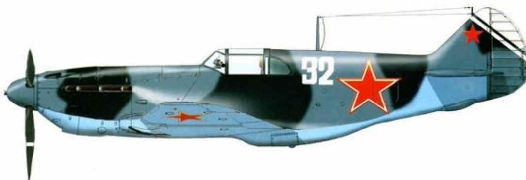
ЛаГГ-3 66-й серии завода № 31, 9-й иап ВВС Черноморского флота. Самолёт имеет стандартный камуфляж образца 1943 г.
