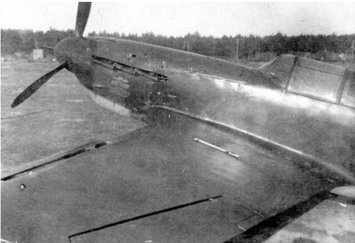
Носовая часть самолёта № 31213445. Хорошо видны выпущенные предкрылки и индивидуальные выхлопные патрубки.
