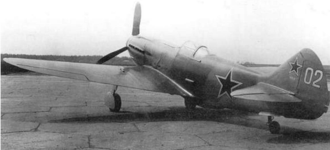
Самолёт «105-2» с мотором М-105ПФ-2 и винтом ВИШ-105СВ на испытаниях, 1944 г.
