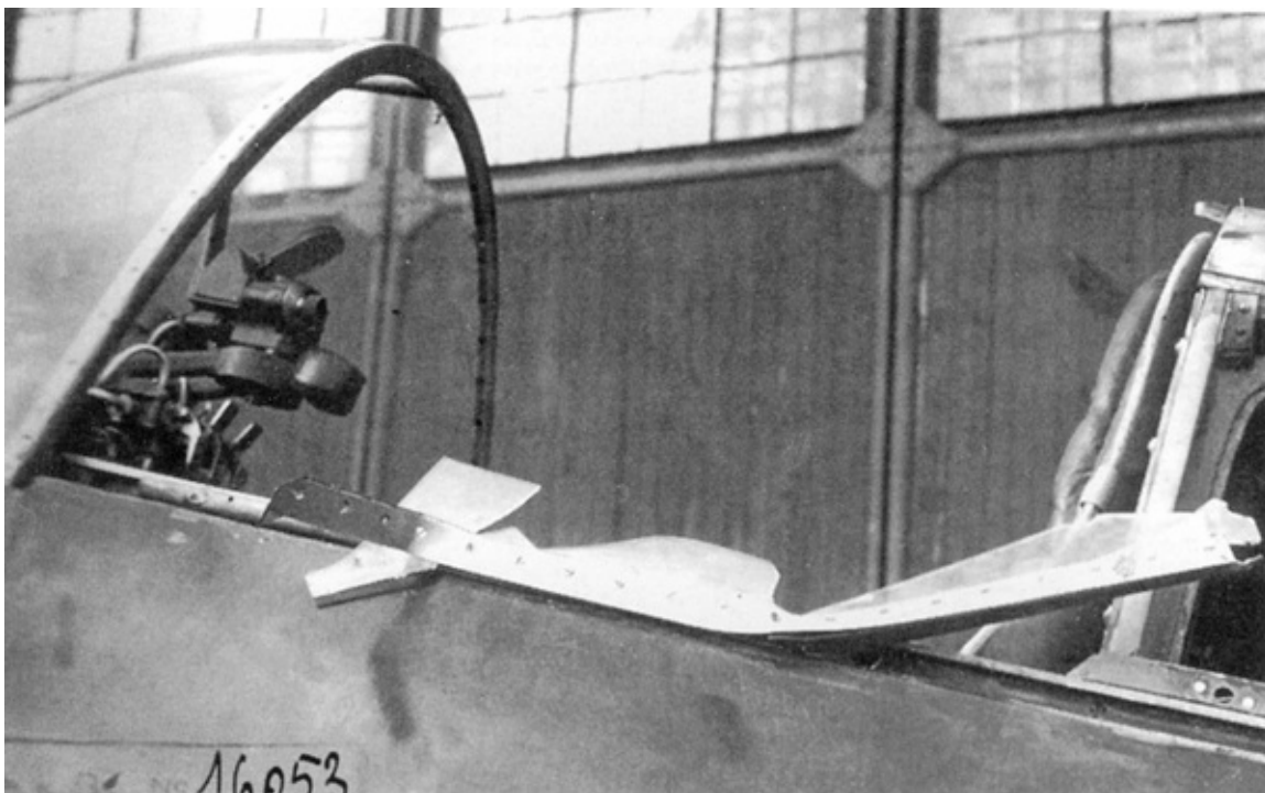
Кабина ЛаГГ-3 (№ 3121226), с которого 13 июня 1941 г. в полёте сорвало фонарь; машину пилотировал К. Груздев.
