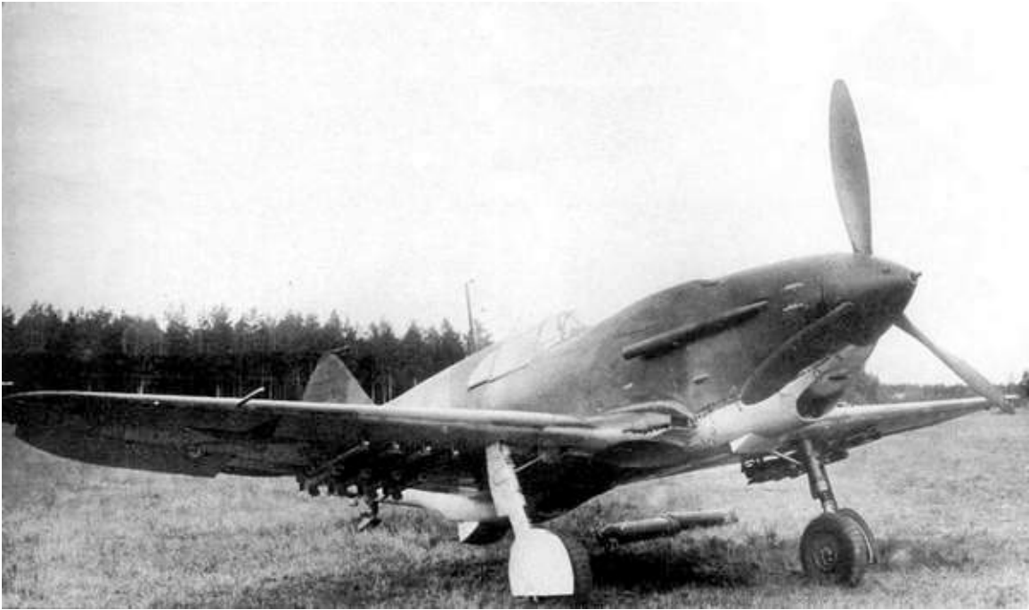
ЛаГГ-3 № 3121422 с подвеской реактивных снарядов РС-82. Фото сделано в августе — сентябре 1941 г.
