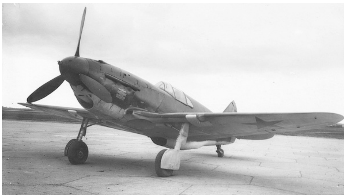
ЛаГГ-3 29-й серии с мотором М-105ПФ на испытаниях в мае 1942 г.
