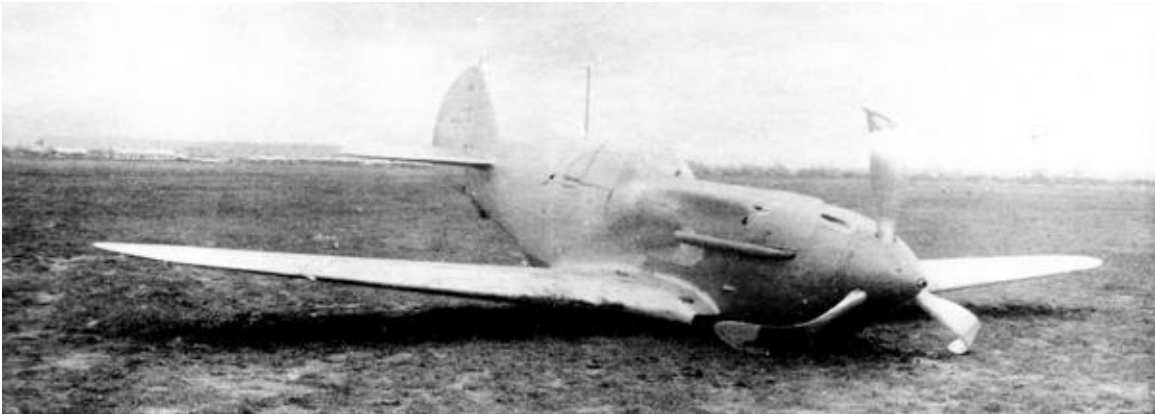
Истребитель № 3121321 (из 3-й серии завода № 21) потерпел аварию после сдаточного полёта 26 мая 1941 г. На посадке пилот А. Г. Вишенков не смог выпустить одну из стоек шасси. Хорошо видно, что балансир на руле направления отсутствует.
