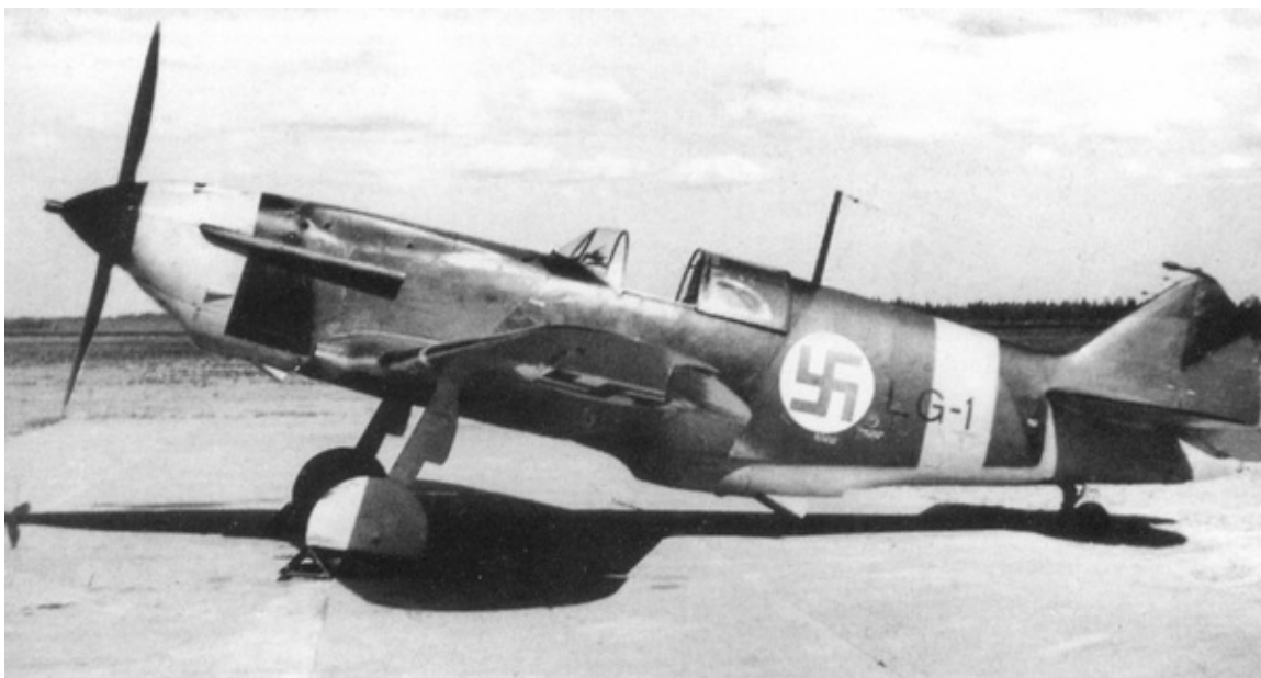
ЛаГГ-3 финских ВВС, эскадрилья LeLv 32, 1943 г. Это самолёт 4-й серии завода № 21, на котором финский завод VL переделал закрылки.
