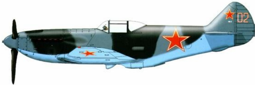
Самолёт «105-2» с мотором ВК-105ПФ2 и винтом ВИШ-105СВ, весна 1944 г.
