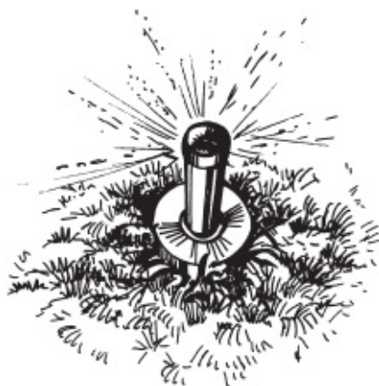
Рисунок 62. Погружаемый дождевальный аппарат
