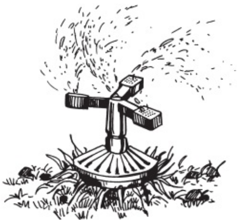
Рисунок 59. Круговой дождевальнй аппарат для полива клумб и газонов округлой формы
