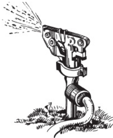
Рисунок 60. Импульсный дождевальнй аппарат
