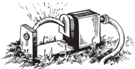
Рисунок 61. Маятниковый дождевальный аппарат
