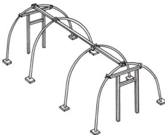
Рисунок 2. Арочная теплица, установка опор
