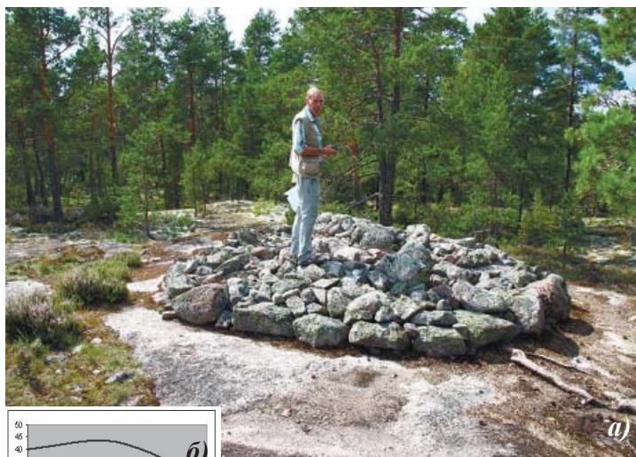
Избр. 9.12. Измерения на «безымянной» насыпи: а) А.Г.Зверев проводит измерения РИ в центре насыпи; б) \beta - и \gamma -составляющие РИ в районе насыпи
