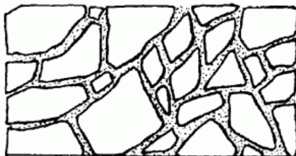
Рис. 68. Мозаичная кладка из бутового камня.
