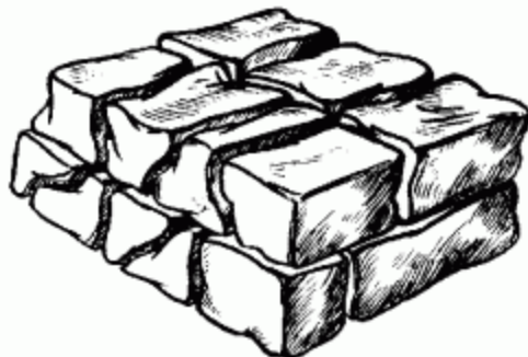
Рис. 46. Кладка, разрезанная вертикальными плоскостями камней.
