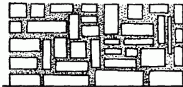
Рис. 66. Классическая кладка бутового камня.
