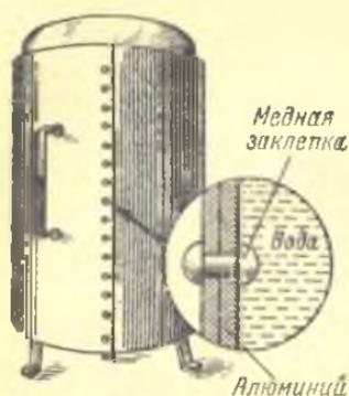
Рис. 30. Крупный гальванический элемент на металлической конструкции.
