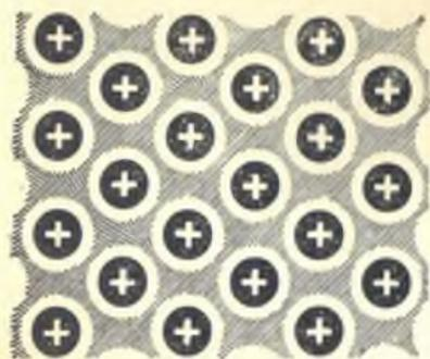
Рис. 11. Схема строения металла. В узлах решетки положительно заряженные ионы. В промежутках находятся свободные электроны.
