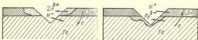
Рис. 47. Коррозия оцинкованного и луженого железа.
