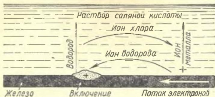
Рис. 21. Схема растворения железа (электрохимический процесс).
