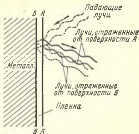
Рис. 15. Метод определения толщины оксидных пленок.
