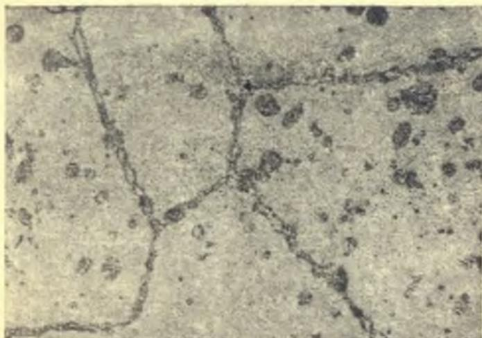
Рис. 41. Межкристаллитная коррозия нержавеющей стали.
