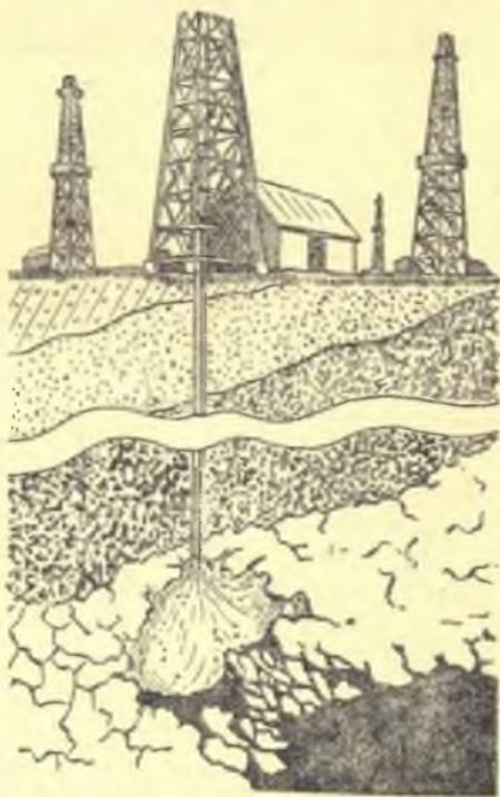
Рис. 72. Применение ингибированной соляной кислоты для обработки нефтяных скважин.
