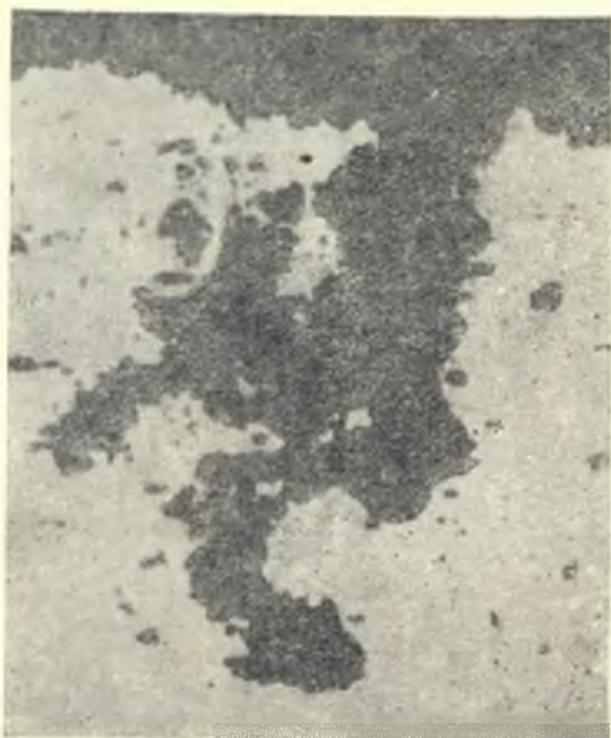
Рис. 40. Питтинг на образце сплава. Поперечный шлиф ( $\times 200$ ).
