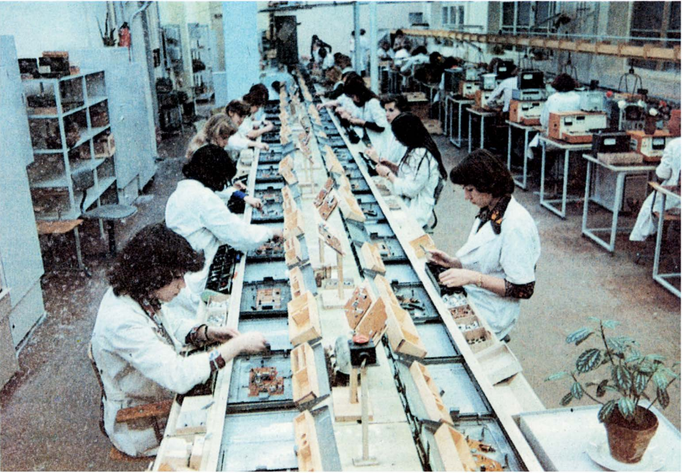
Конвейер на рижском заводе «ВЭФ». Каждую минуту с конвейеров завода сходит 11 радиоприемников.
