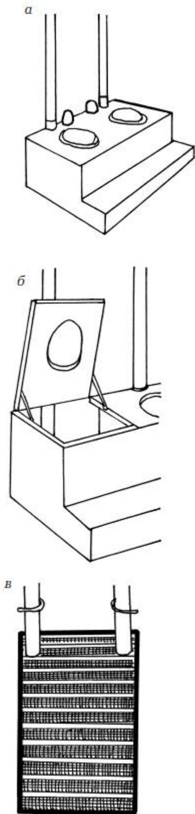
Рисунок 8. Двухкамерный компостирующий туалет:
