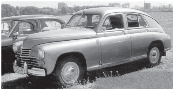
Рис. 10.15 ❖ «Победа» – первый автомобиль с кузовом бескрылой формы
