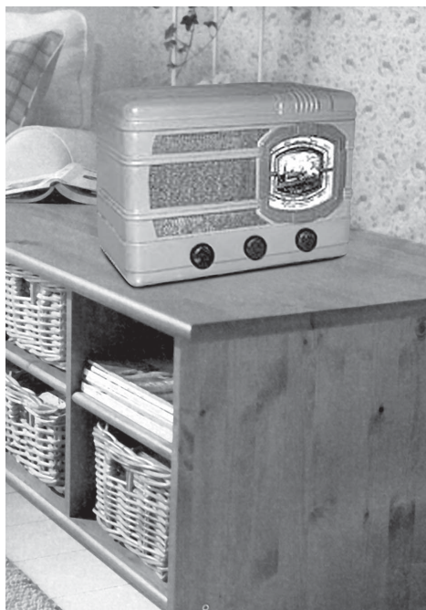
Рис. 4.17 ❖ Радиоприемник «АРЗ-51». Его корпус сделан из штампованного металла
