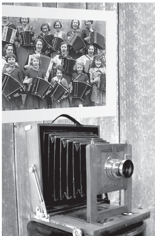
Рис. 7.2 ❖ Крупноформатные фотографические аппараты имели меха, будто у гармоники
