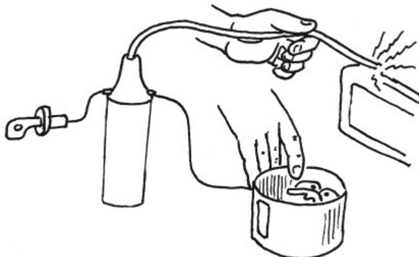
Рисунок 27. Проверка цепи системы зажигания
