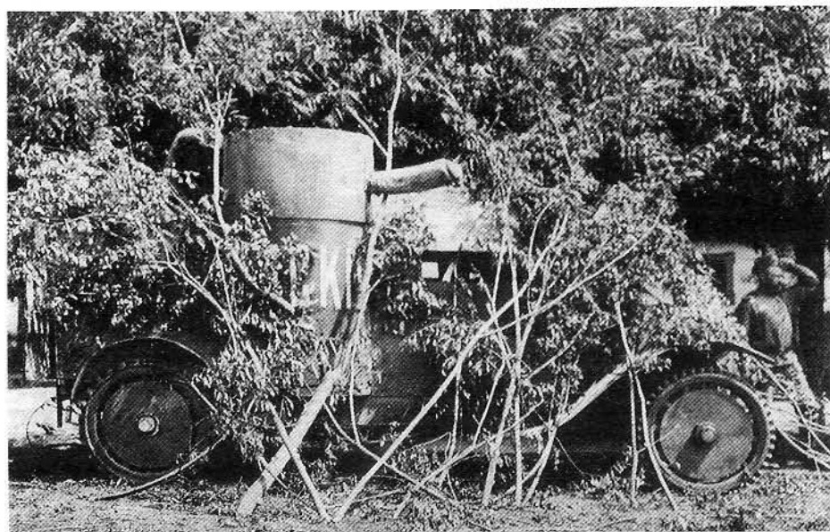
Бронеавтомобиль «Адский» 15-го взвода, замаскированный ветками. Обращает на себя внимание броневое прикрытие колес. Юго-Западный фронт, июнь 1915 года.
