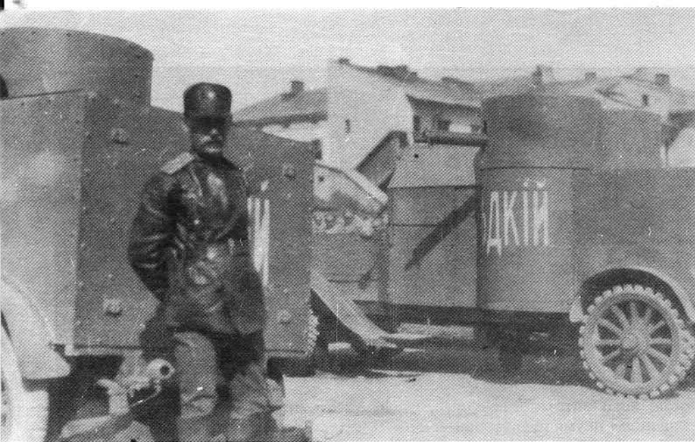
«Остины» 18-го пулеметного автомобильного взвода. Машины не имеют броневой защиты пулеметов. На «Редком» (справа) шины английского образца, на «Ратном» (слева) — русские «гусматики». Тарнополь, май 1915 года.
