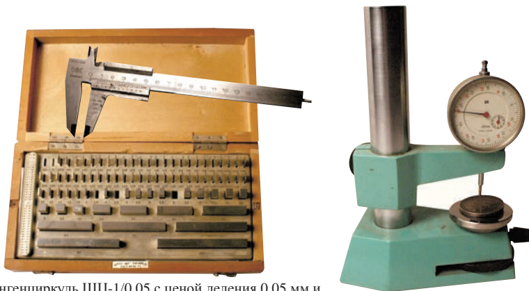
Штангенциркуль ШЦ-1/0,05 с ценой деления 0,05 мм и стойка с индикаторной головкой ИЧ 0,01 с ценой деления 0,01 мм и набором концевых мер.
