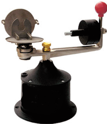
Современная литейная центробежная “машинка”.
