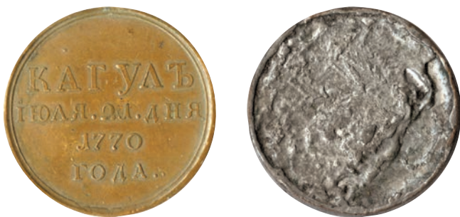
Гальванокопия одной стороны медали, залитая свинцом (до соединения с “крышкой” - гальванокопией другой стороны).
