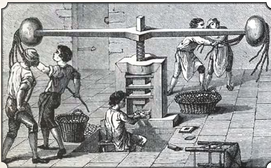
Первые машины в денежном производстве: фальверк, приспособление с молотовым снарядом, падавшим с большой высоты (справа); винтовой пресс (слева). Европейские гравюры XVIII–XIX веков
