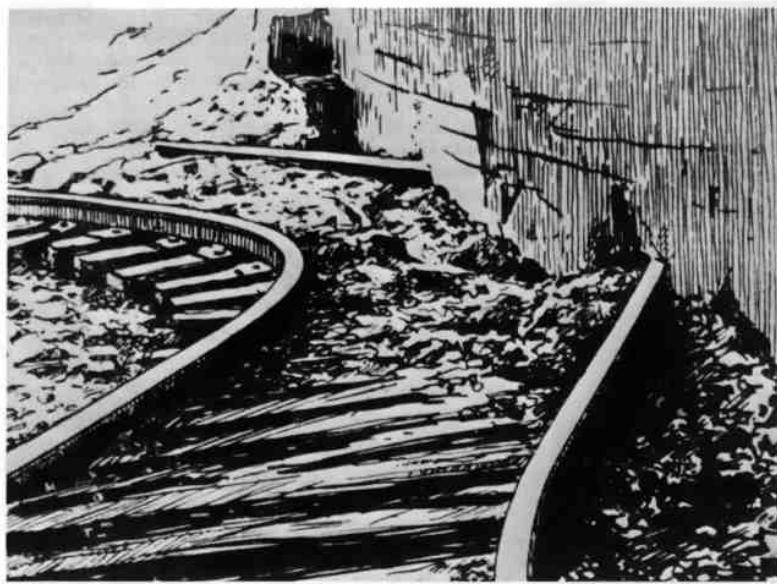
Землетрясение Керн-Каунти. Разрушение тоннеля и рельсового пути. Рельс попал под бетонную стену
