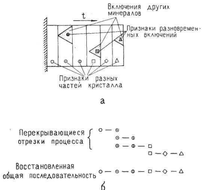
Рис. 117. Схема хронологической последовательности формирования различных частей кристалла (а) и восстановление последовательности событий по перекрывающим отрезкам процесса (б).
