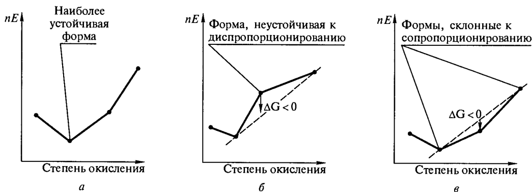
Рис. 1.35. Схемы диаграмм Фроста, иллюстрирующие наиболее стабильные окислительные формы (а), формы, склонные к реакции диспропорционирования (б), и формы, склонные к реакциям сопропорционирования (в)
