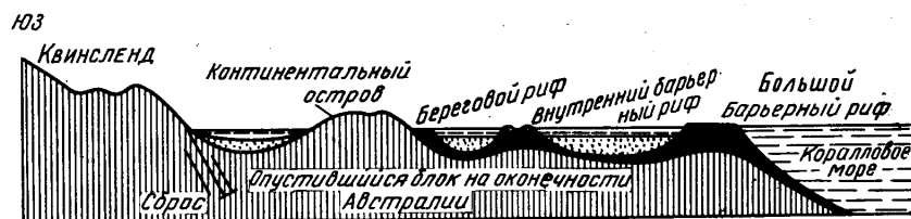
Рис. 82. Разрез, показывающий отношение Большого Барьерного рифа к Квинслендскому берегу (по Д. А. Стирсу). Рифы показаны черным; осадки лагун — точками
