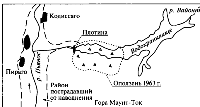
Рис. 8.10. Поперечный разрез оползня, сошедшего с горы Маунт-Ток в водохранилище Вайонт (А) и схема разрушения (Б), вызванного паводковой волной, образовавшейся в результате этого оползня (по Т.Уолтхэму, упрощенно)
