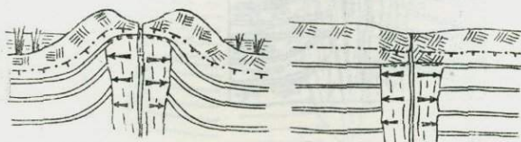
Рис. 40. Различный характер передачи давления со стороны растущей ледяной жилы при негоризонтальном и горизонтальном залегании слоев вмещающей породы.
