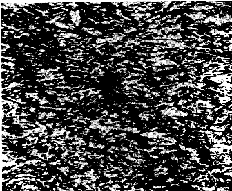
Фиг. 3-5. У лишенные кристаллы полевых шпатов в вулканической породе (трахите) с отчетливо выраженной взаимной ориентировкой; длина призм составляет около 0,2 мм.
