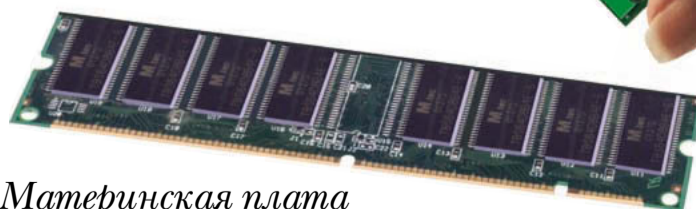
Оперативная память выпускается в виде микросхем, собранных на специальной плате
