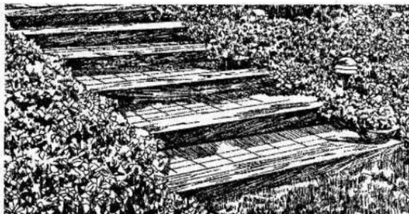
Рис. 11. Лестница из кирпича и железнодорожных шпал
