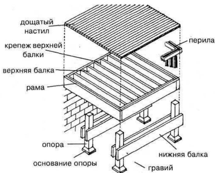
**Рис. 26. Устройство высокой террасы**
