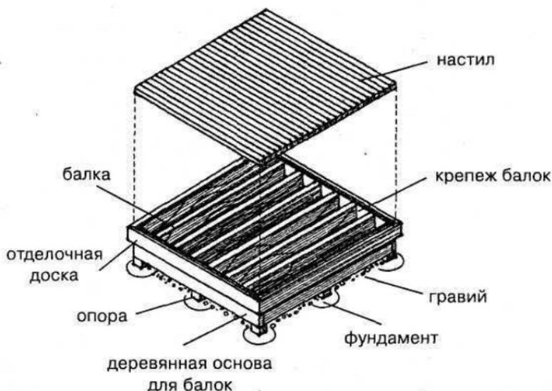
**Рис. 24. Устройство низкой террасы**
