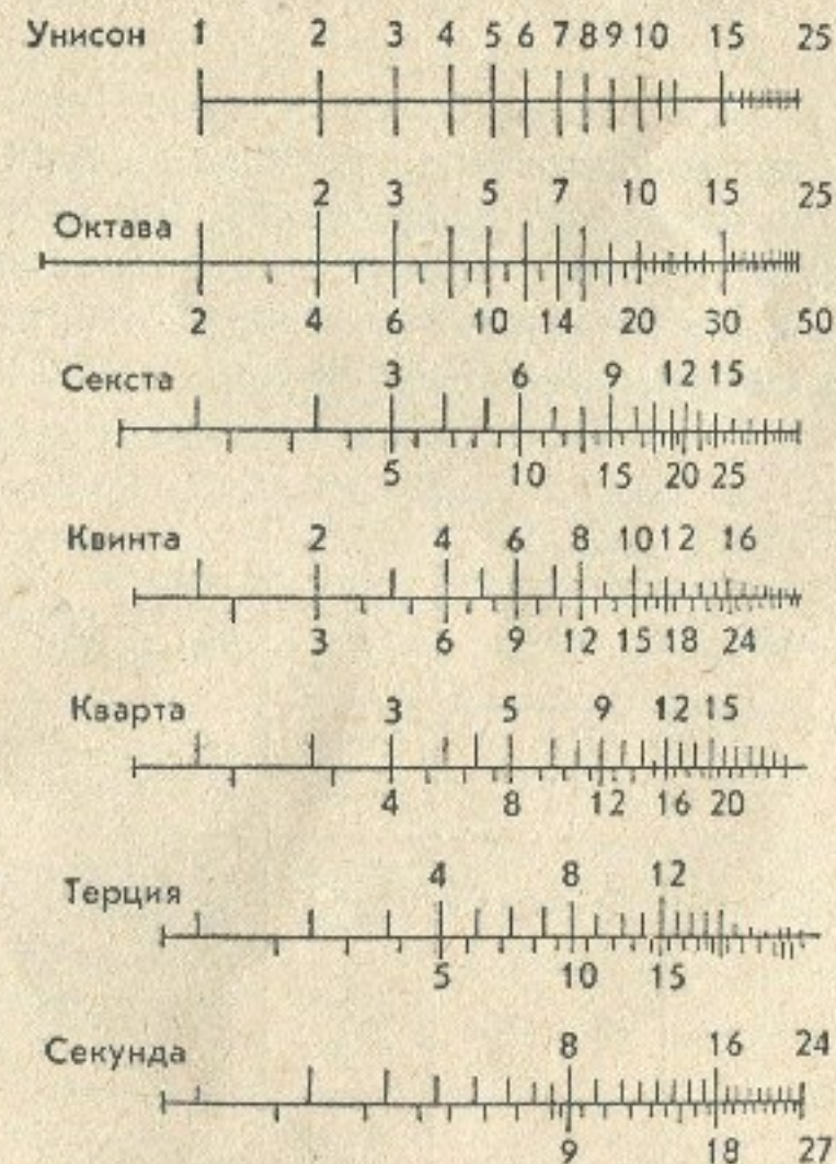
Рис. 3. Гармонические спектры интервалов
