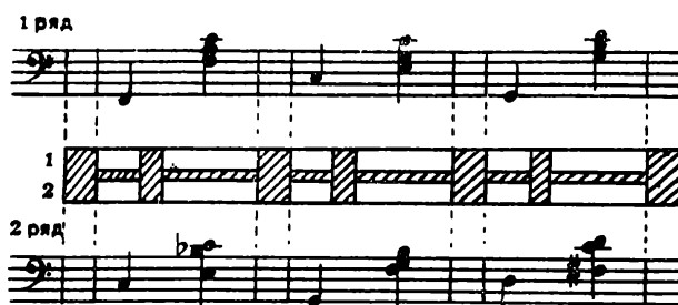
Расположение басов и аккордов в простой басо-аккордовой губной гармонике в строе до мажор. (Басы и аккорды в верхних каналах звучат на выдох, в нижних — на вдох.)
