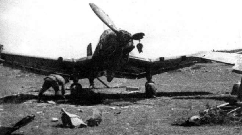
Деревянные лопасти винта у «юнкерса» не гнулись, а попросту обламывались
