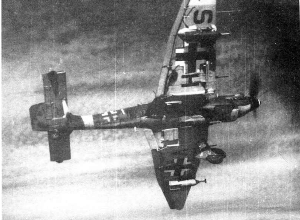
Выполняет переворот Ju 87D-5 с тонной бомб: двумя SC250 под крылом и одной SC500 под фюзеляжем
