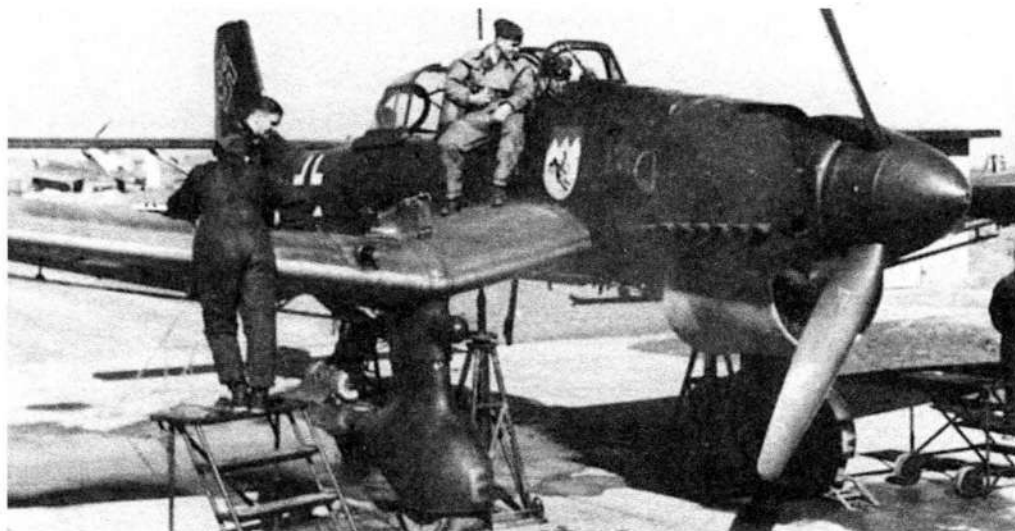
«Берта» из эскадры StG77 выставлена на домкраты — возможно, для нивелировки или для пристрелки крыльевых пулеметов
