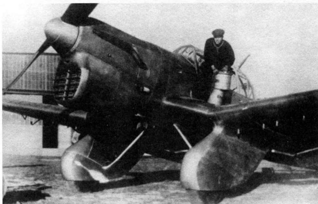
Ju 87V1 с мотором Роллс-Ройс «Кестрел» V
