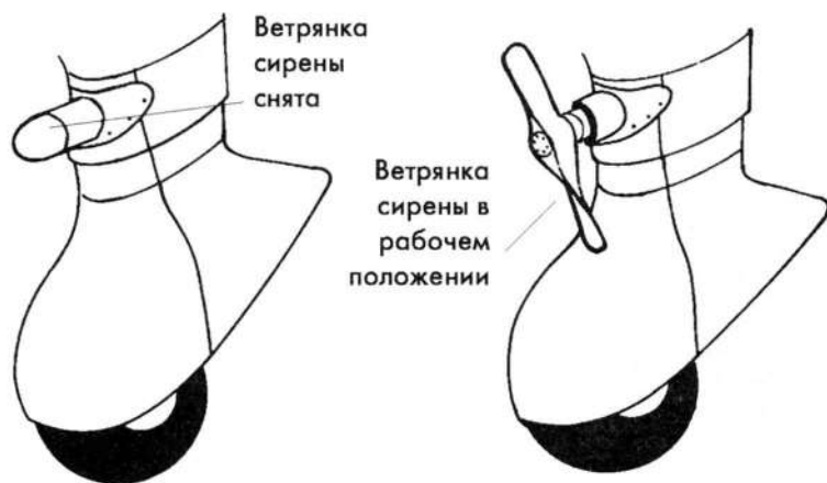
Установка привода сирены на стойке шасси
