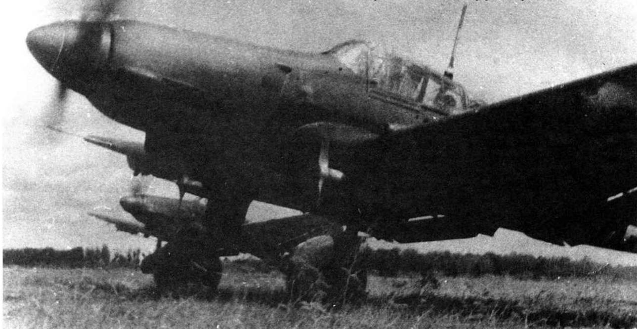
Эти Ju 87D-1, судя по отсутствию бомб на держателях, только что приземлились. Обратите внимание на вертушки сирен на стойках шасси
