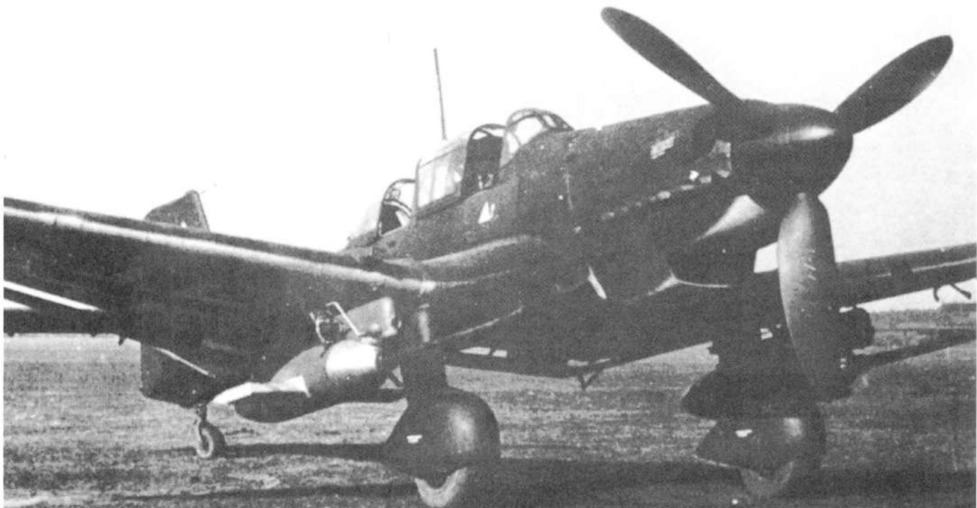
Противотанковый самолет Ju 87G-1 с двумя 37-мм пушками под крылом. Видны демонтированные бомбодержатели
