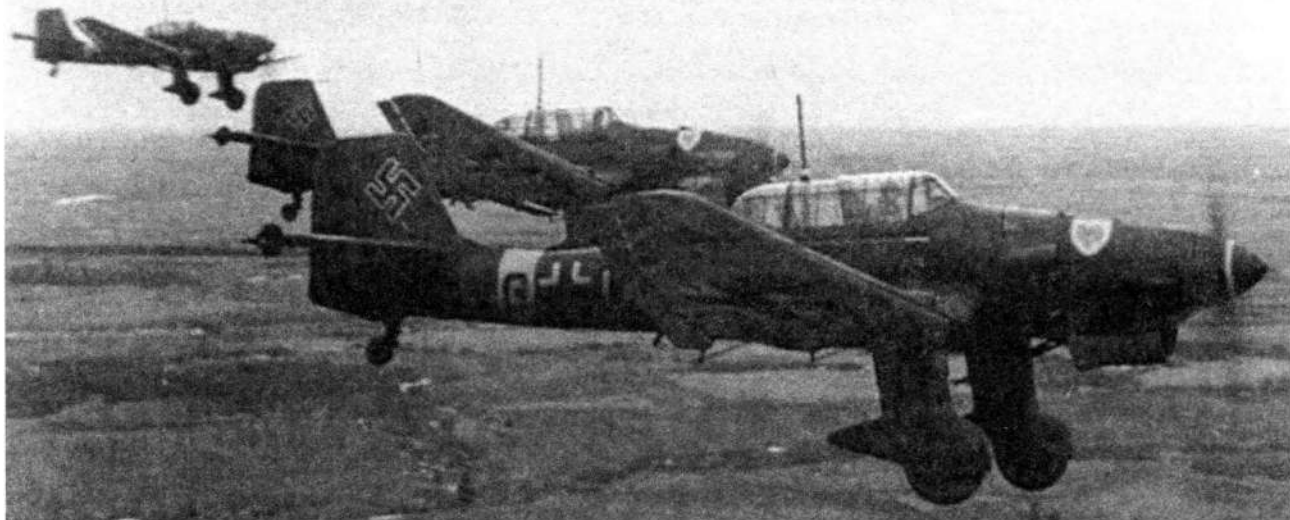
Звено «лаптей» из II/StG1 возвращается с задания — подфюзеляжные трапеции пусты
