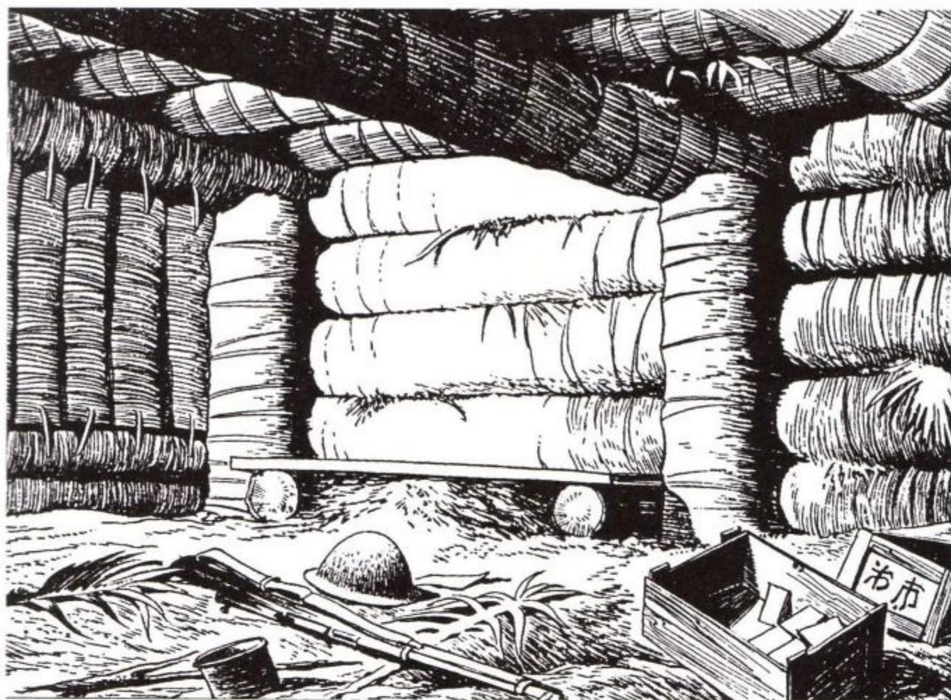
Во внутренней части этого бункера мы видим вертикальные поддерживающие опоры, стороны, облицованные бревнами, и продольные балки, поддерживающие крышу. Для стяжки бревен использовались стальные скобы.
