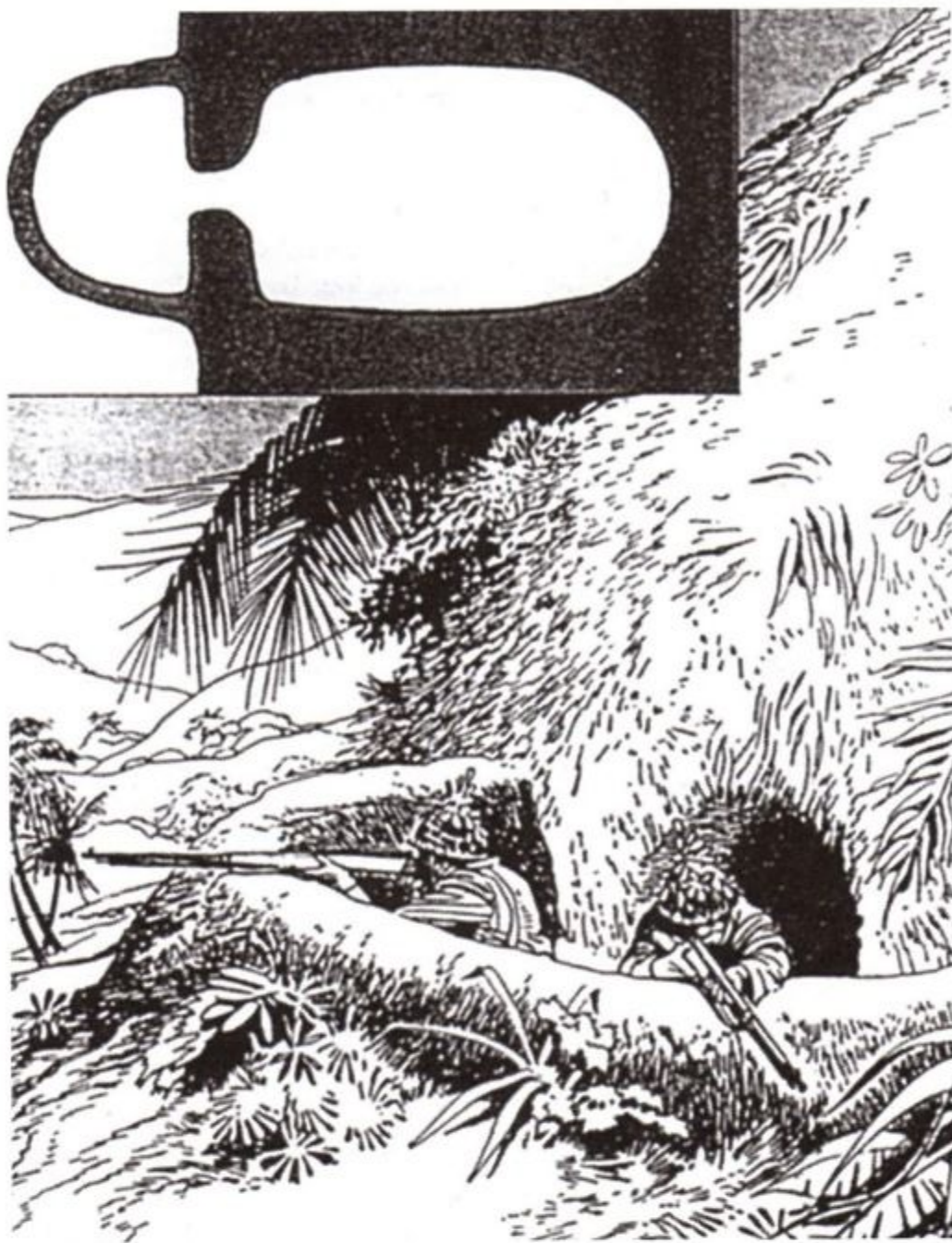
Обычно японские укрытия для стрелков были небольшими и рассчитанными на одного солдата, но в некоторых случаях удавалось подготовить более основательные позиции на одного или двух стрелков. На таких позициях мог быть размещен пулемет или гранатомет. Такие позиции могли маскироваться ветками. В верхней части рисунка показан план-схема позиции.
