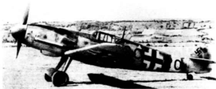
Один из предсерийных Bf 109G-10 с мотором DB 601E на испытаниях
