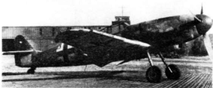
Истребитель Bf 109G-10 с новой капотировкой мотора DB 605D, увеличенным маслорадиатором и «высоким» килем. Створки шасси демонтированы — обычно к этой мере прибегали при базировании на размокшем полевом аэродроме весной или осенью
