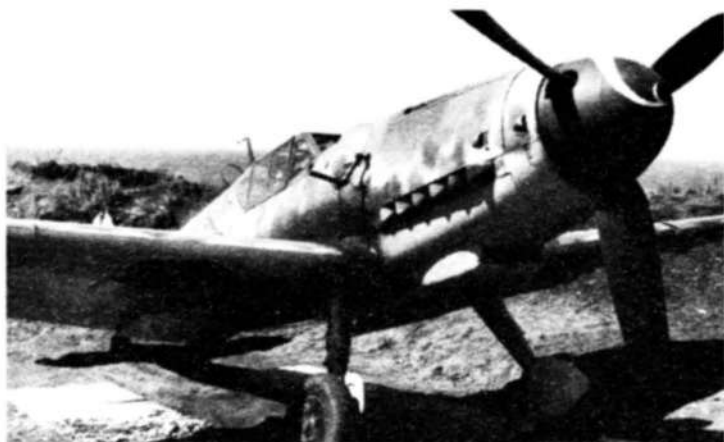
Истребитель Bf 109G-6. Под заводной рукояткой можно заметить обтекатель дополнительной маслосмолы мотора DB 605AS, характерный для машин позднего выпуска
