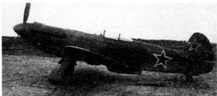
Головной серийный Як-9У с двигателем ВК-107А (заводской № 25-021, построен в Омске в апреле 1944 г. и собран на заводе № 301 в мае 1944 г.). Государственные испытания. Август 1944 г.
