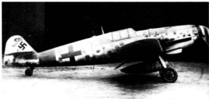
Истребитель Bf 109G-6/U2/R3/R6 с установленной на заводе системой форсирования GM-1, подвесным баком и двумя подкрыльевыми гондолами с пушками MG 151/20
