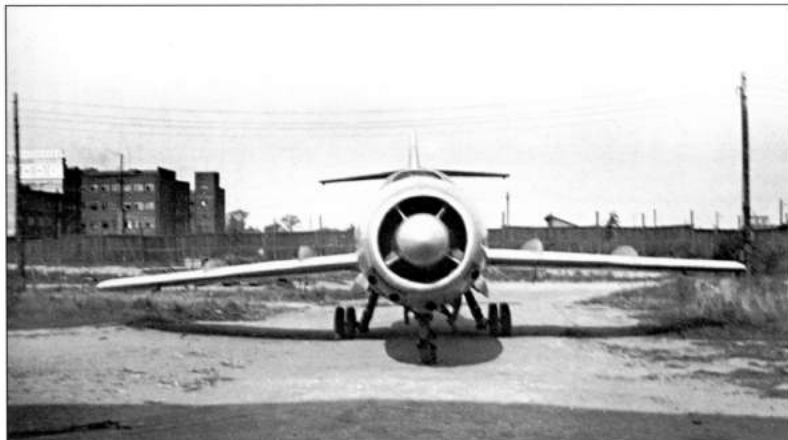
Первый экземпляр барражирующего перехватчика Ла-200 с РЛС «Торий»
