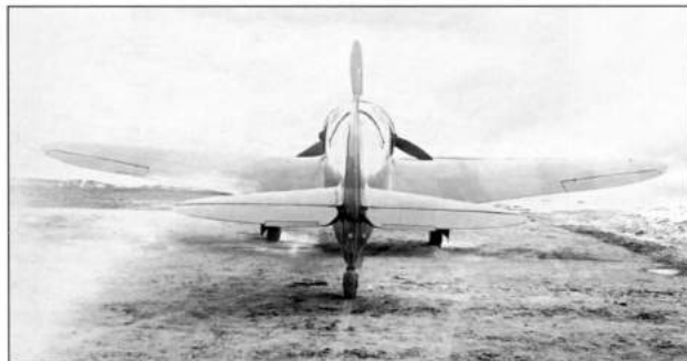
Опытный ЛаГГ-3 с мотором М-82 на совместных испытаниях НКАП и ВВС. Май—июнь 1942 года
