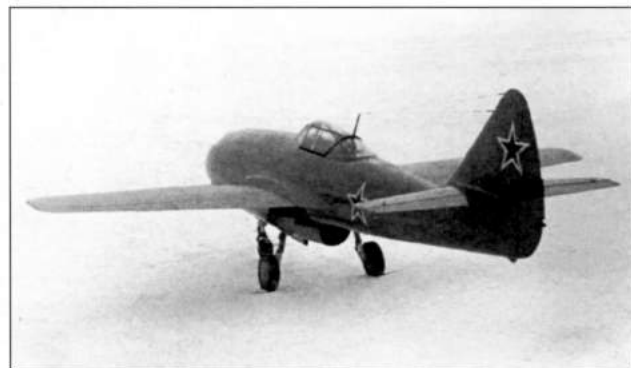
Самолет «174» с тонким крылом и двигателем «Дервент-V»
