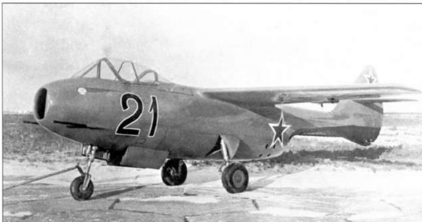
Доработанный Ла-150 с увеличенным вертикальным оперением
