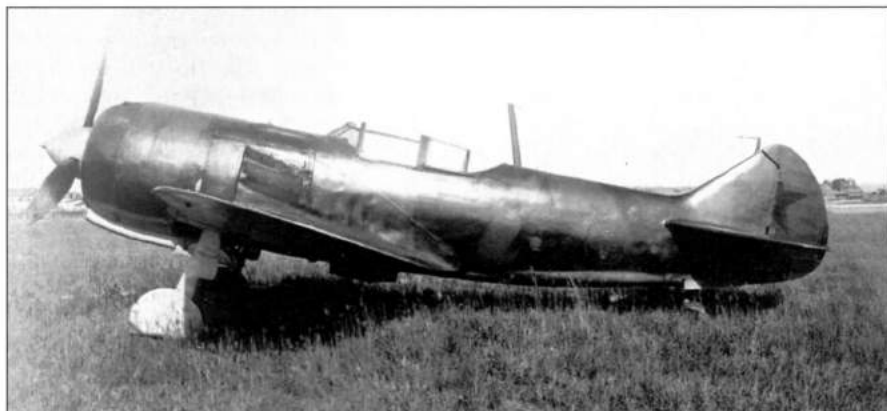
Ла-5 с двигателем М-71
