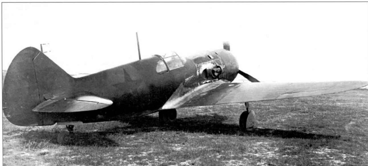
Высотный вариант истребителя Ла-5 с турбокомпрессором ТК-3
