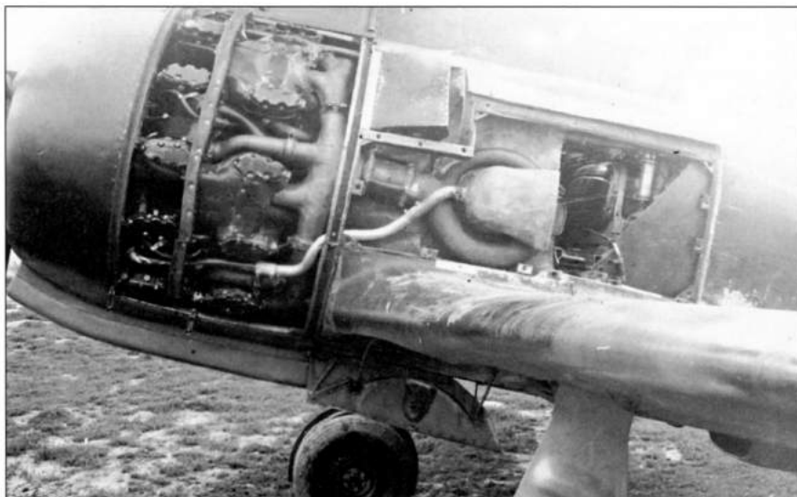
Установка турбокомпрессора ТК-3 на Ла-5ФТК
