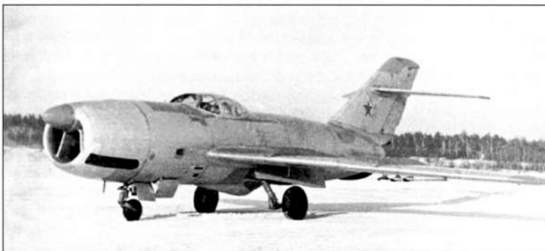
Перехватчик Ла-200 с РЛС «Коршун» без подвесных топливных баков
