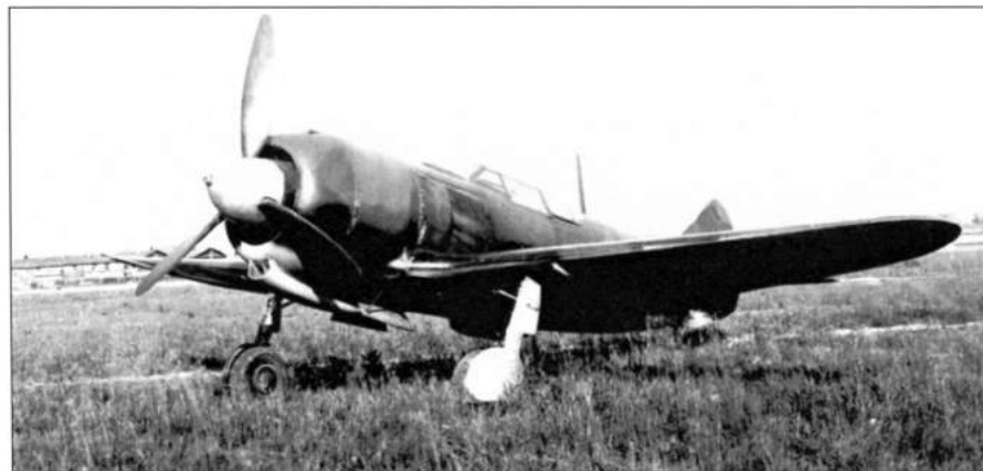
Ла-5 с двигателем М-71
