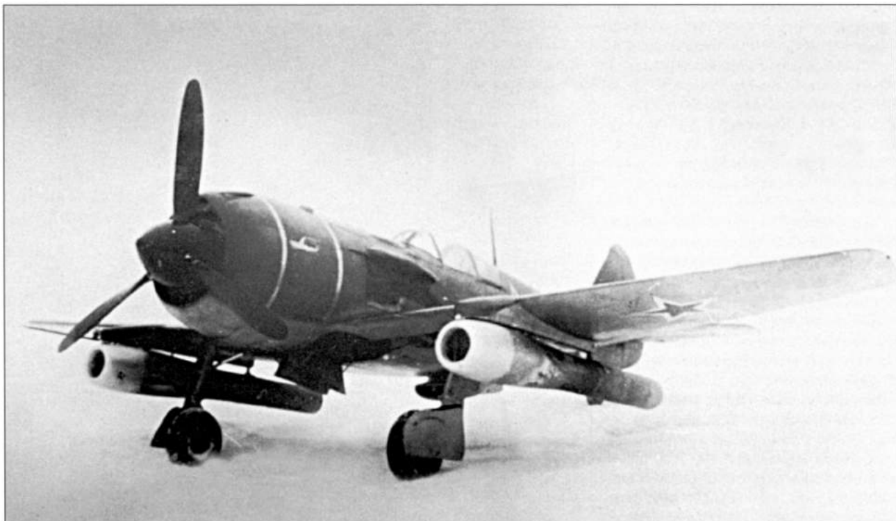
Ла-9 с пульсирующими воздушно-реактивными двигателями В.Н. Челомея
