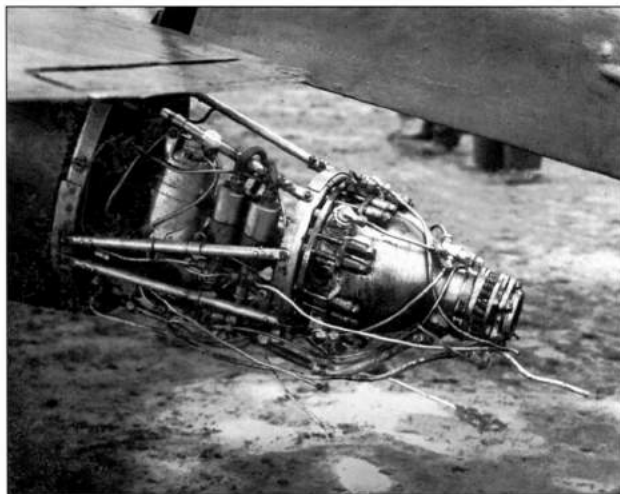
Размещение ЖРД РД-1ХЗ на самолете Ла-7Р-2
