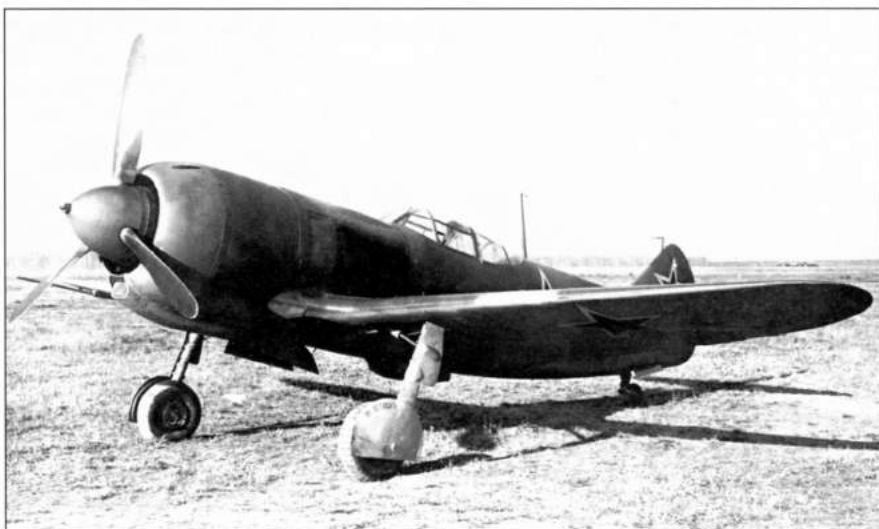
Ла-5ФН со всасывающим патрубком, перенесенным под капот, и маслорадиатором под фюзеляжем
