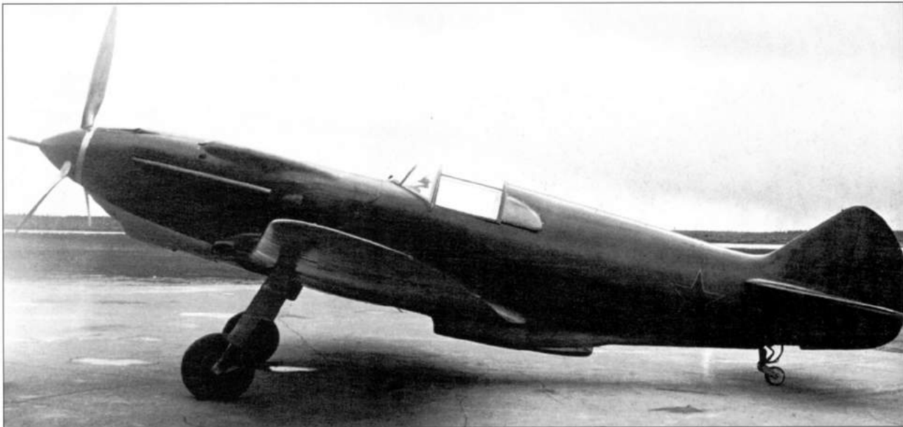
Истребитель К-37 с пушкой калибра 37 мм, переделанный из ЛаГГ-3 завода № 23
