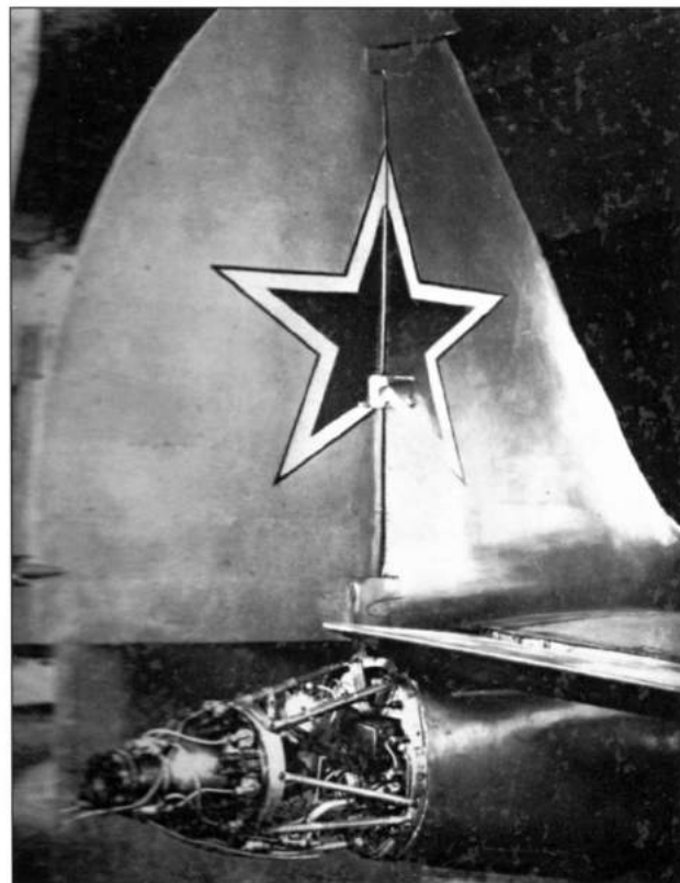
Размещение ЖРД РД-1ХЗ на самолете Ла-7Р-2
