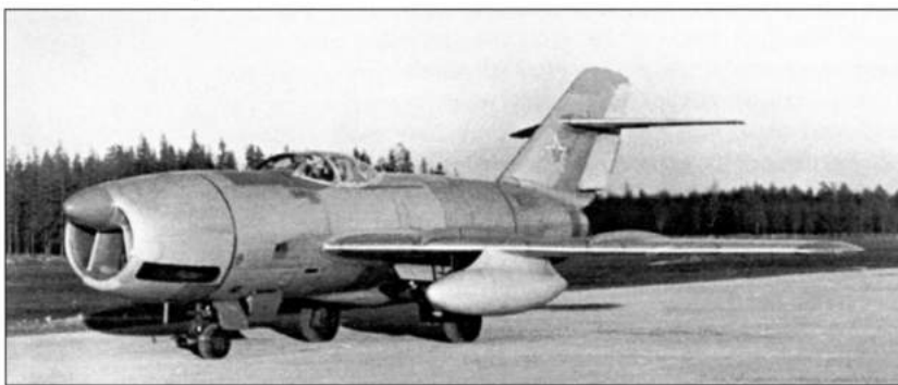
Перехватчик Ла-200 с РЛС «Коршун» с подвесными топливными баками
