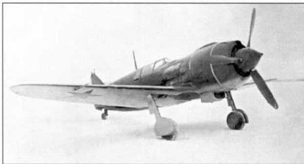
Ла-5 с герметизацией капота по рекомендациям ЦАГИ
