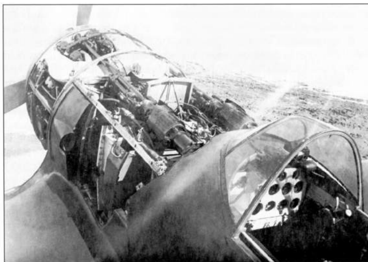
Вооружение самолета ЛаГГ-3 с мотором М-82
