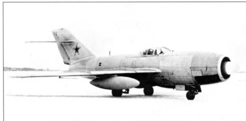
Барражирующий перехватчик Ла-200 с РЛС «Торий» и подвесными топливными баками
