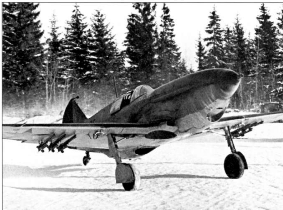
ЛаГГ-3 с реактивными снарядами РС-82 под крылом
