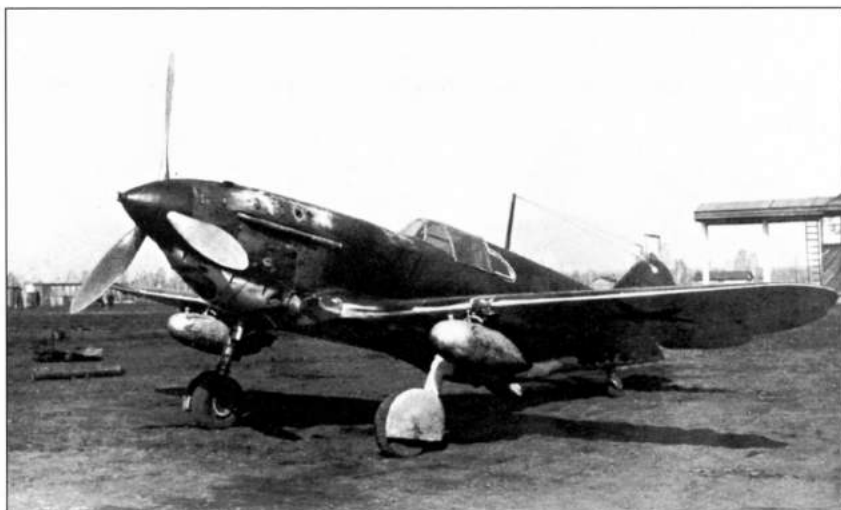
ЛаГГ-3 № 31211232 с подвесными топливными баками
