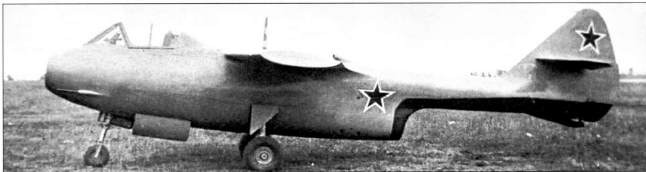
Окончательный вариант Ла-150 с увеличенным вертикальным оперением и отклоненными вниз законцовками крыла
