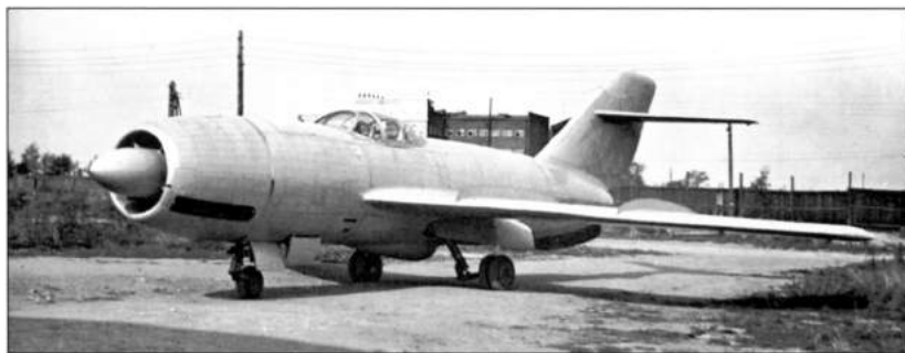
Первый экземпляр барражирующего перехватчика Ла-200 с РЛС «Торий»
