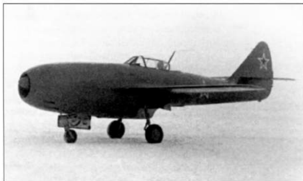
Самолет «174» с тонким крылом и двигателем «Дервент-V»
