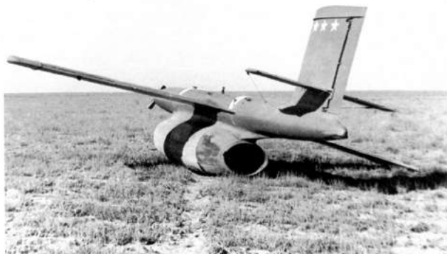
После посадки Ла-17 для повторного использования приходилось заменять силовую установку
