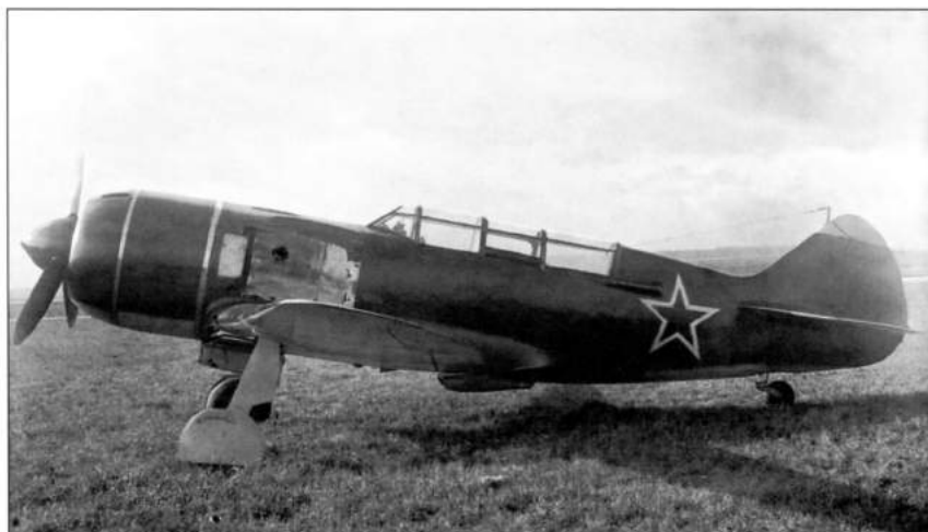
Ла-7УТИ № 46210117 с задним расположением маслорадиатора
