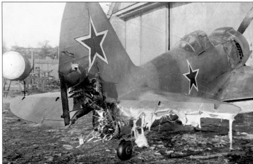
Испытания Ла-7Р-2, пилотируемого Г.М. Шияновым, завершились 27 марта 1945 года взрывом ЖРД
