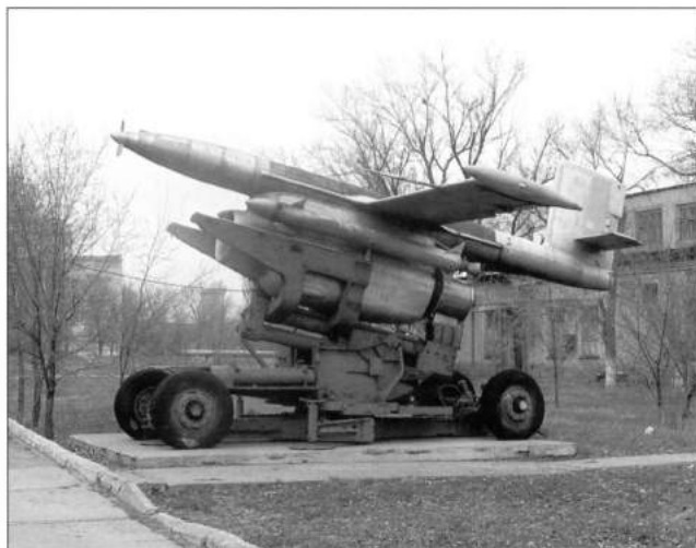
Ла-17ММ на транспортно-пусковой установке
