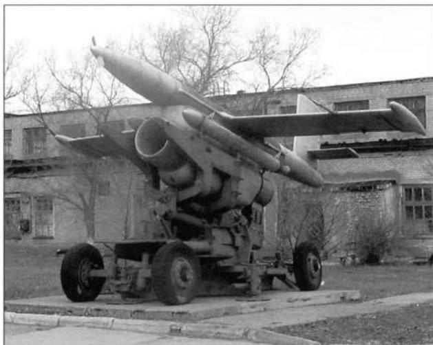
Ла-17ММ на транспортно-пусковой установке
