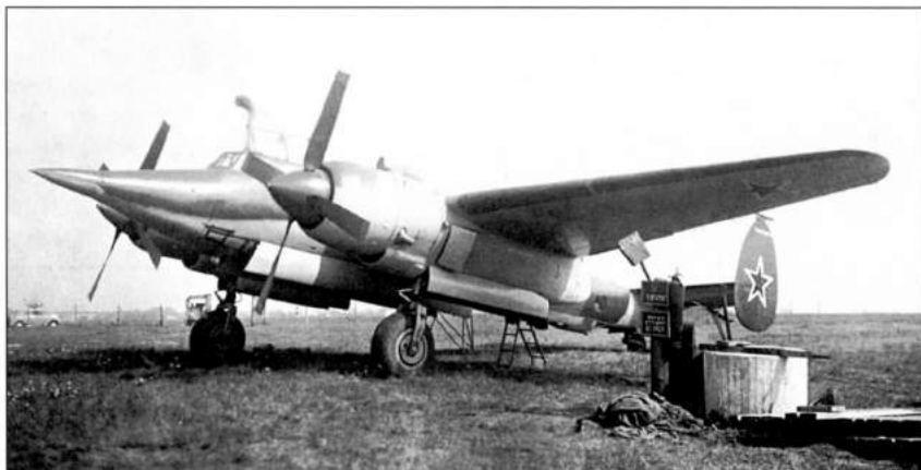
Летающая лаборатория на базе бомбардировщика Ту-2 для отработки аппаратуры наведения ракет Г-300
