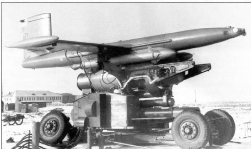
Ла-17К на транспортно-пусковой установке перед запуском
