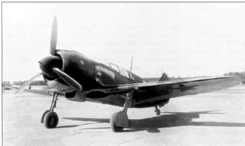
Ла-5Ф с двигателем М-82Ф одной из первых серий
