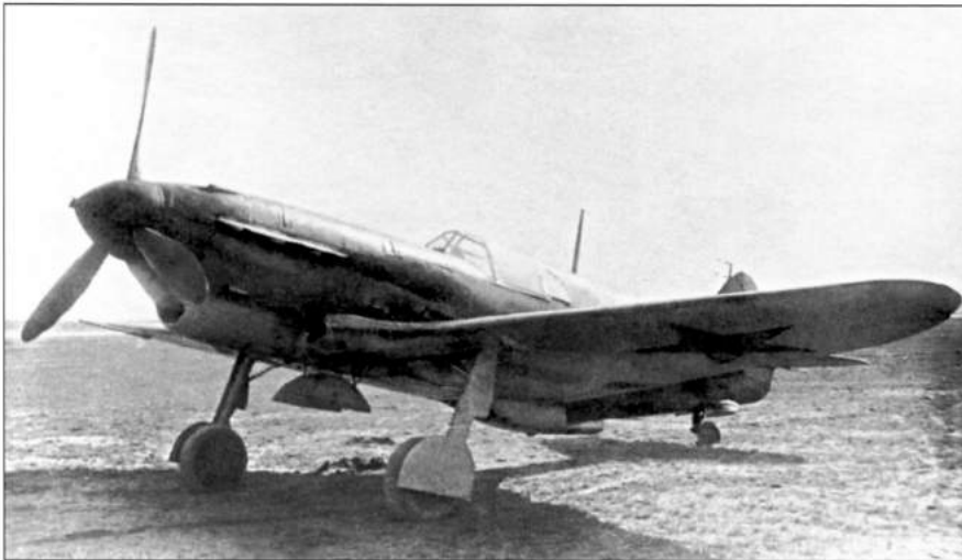
ЛаГГ-3 первых серий с убирающимся хвостовым колесом
