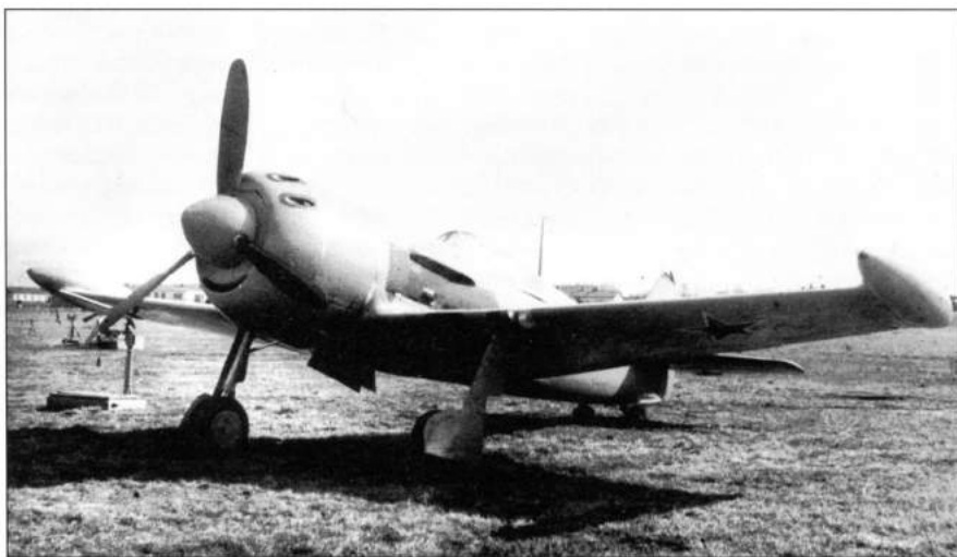
Опытный Ла-9М («134Д») с подвесными несбрасываемыми топливными баками
