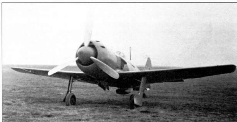
Самолет «132» с мотором АШ-82М
