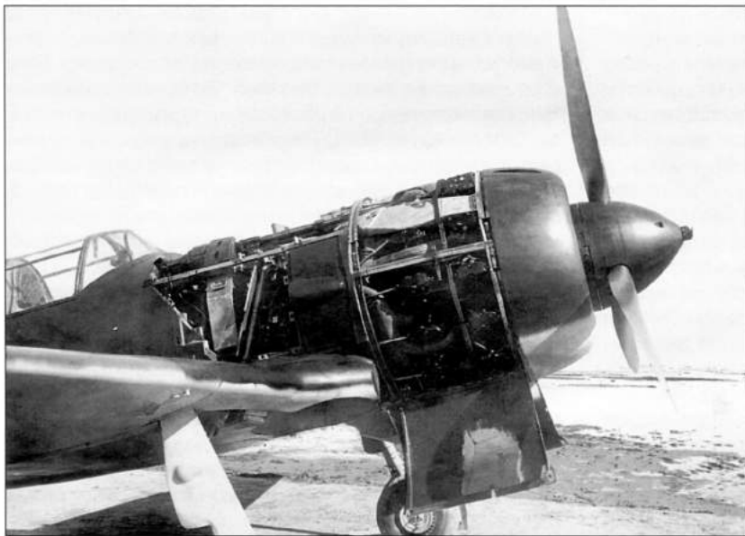
Силовая установка самолета ЛаГГ-3 с мотором М-82
