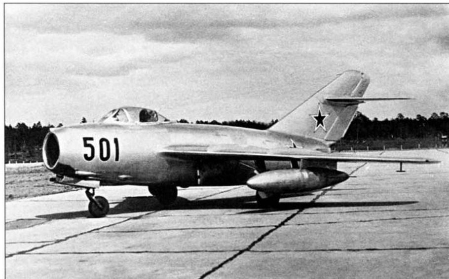
Истребитель сопровождения «СД-УПБ» — опытный экземпляр МиГ-15Сбис с подвесными топливными баками увеличенной емкости
