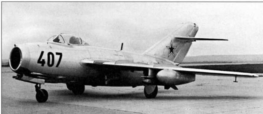
Опытный экземпляр МиГ-15 для испытаний неуправляемых авиационных ракет АРС-212
