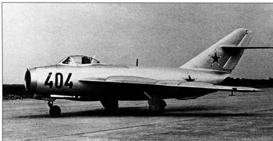
Опытный разведчик СР-2 с двигателем ВК-5Ф
