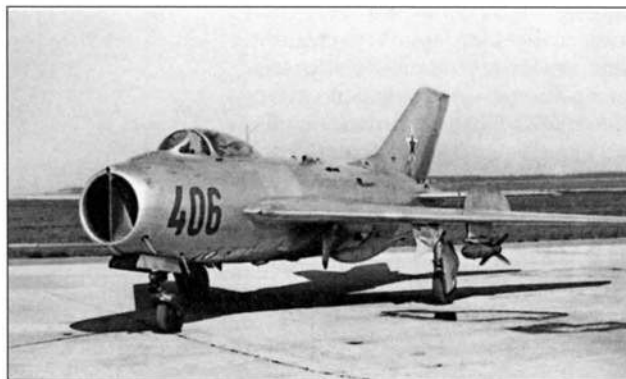
СМ-21 с авиационными реактивными снарядами АРС-212
