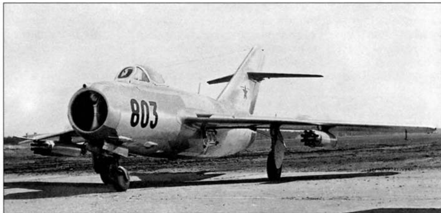
Опытный самолет СД-57 с реактивными орудиями ОРО-57
