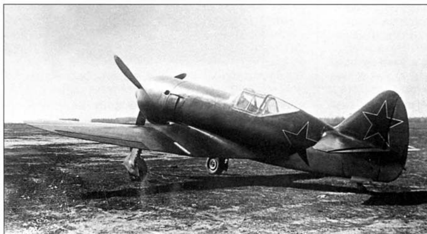
Опытный истребитель И-211 с мотором М-82ФН
