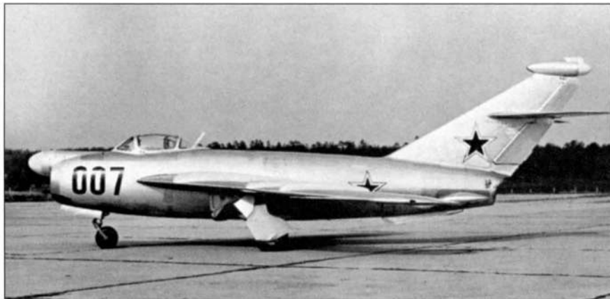
Летающая лаборатория для отработки системы наведения крылатой ракеты «КС» («Комета»)
