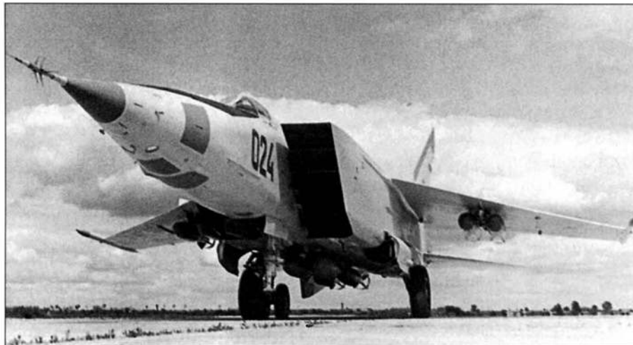
МиГ-25БМ с противорадиолокационными ракетами
