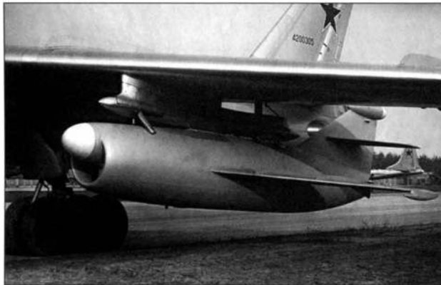
Подвеска самолета-снаряда «КС» под крыло ракетносца Ту-16
