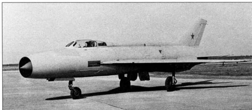
И-7У с системой наведения «Ураган» и двигателем АЛ-7Ф
