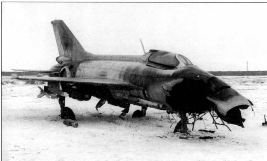
Е-6В/2 летчика В.Г. Плюшкина после взрыва твердотопливного ускорителя 10 января 1962 года
