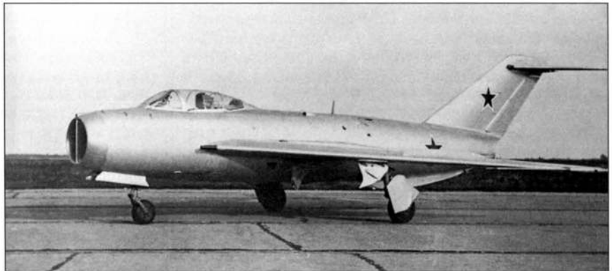
Первый прототип МиГ-19 — самолет СМ-2/1 с Т-образным расположением горизонтального оперения
