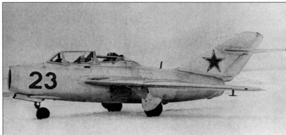
Летающая лаборатория НИИ ВВС — УТИ МиГ-15, предназначенная для испытания средств аварийного покидания самолета
