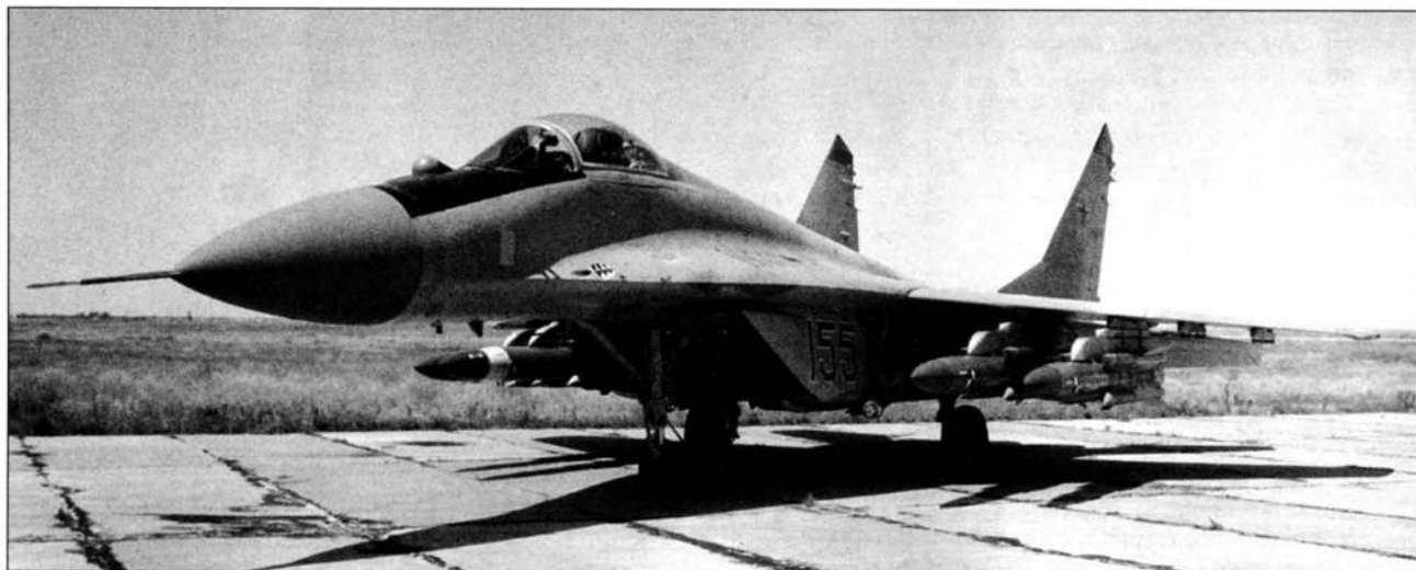
Пятый экземпляр МиГ-29М с противорадиолокационными ракетами Х-31П
