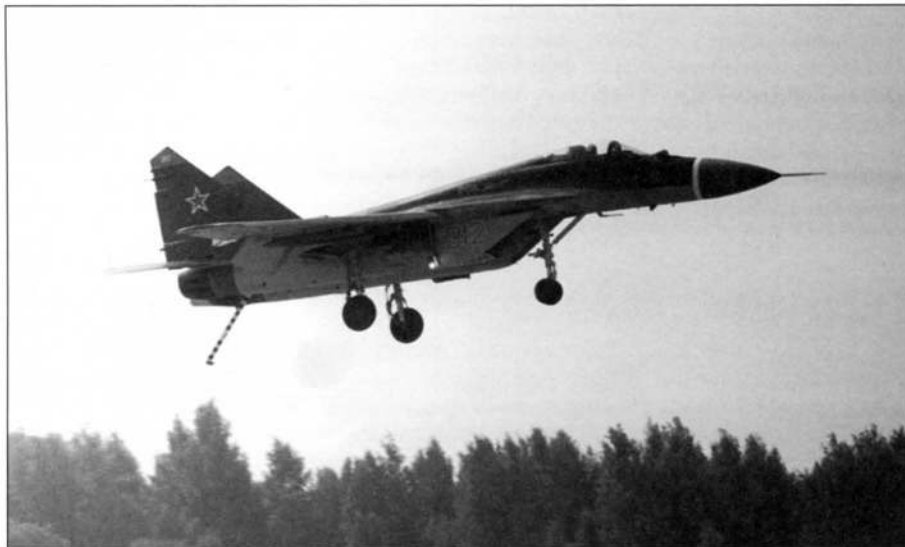
Демонстрационный полет МиГ-29К с выпущенным тормозным гаком
