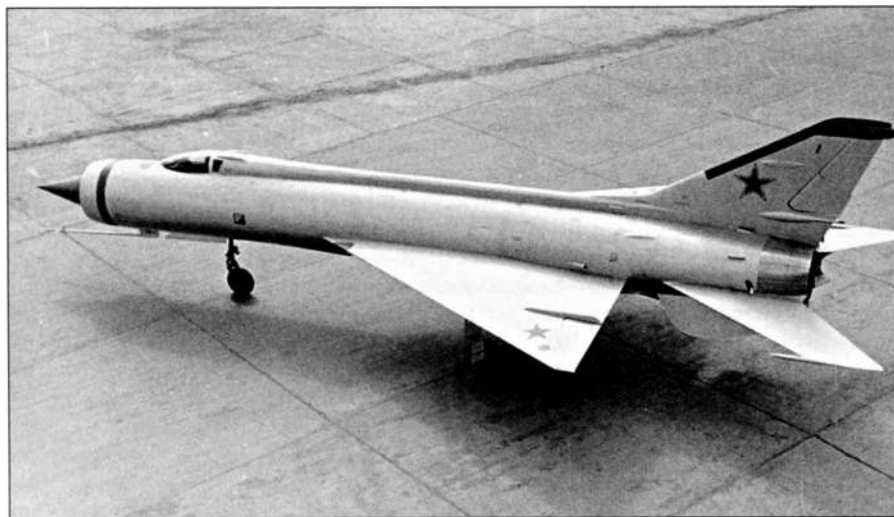
Из-за отсутствия ТРДФ Р15-300 построили двухдвигательный опытный перехватчик Е-152А с двумя двигателями Р11Ф-300
