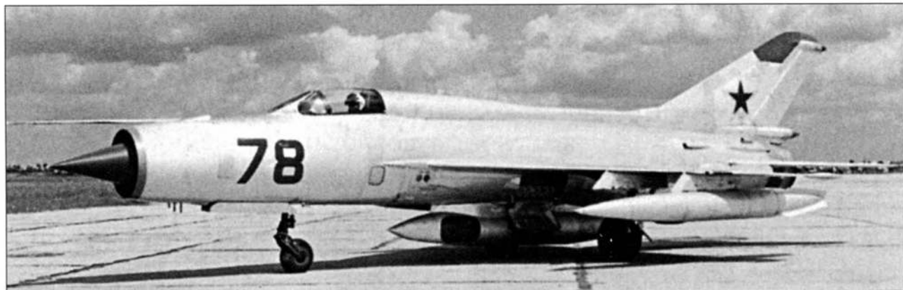
Опытный разведчик Е-7 (МиГ-21ПР), предшественник МиГ-21Р
