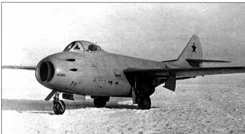
И-308 («ФР») с двигателями РД-21 так и остался в опытном экземпляре
