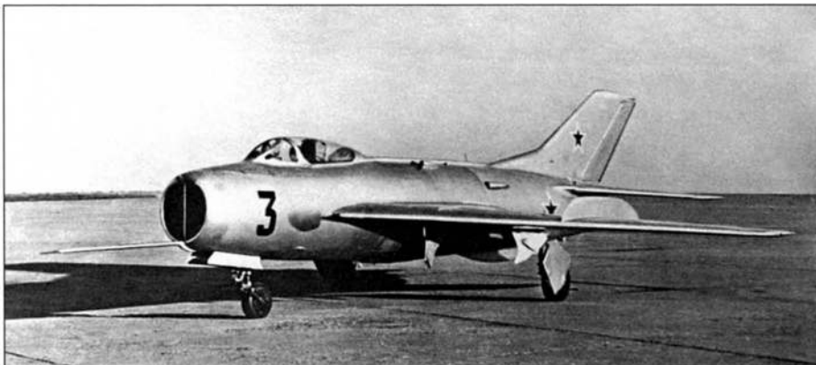
СМ-9/3 с цельноповоротным горизонтальным оперением
