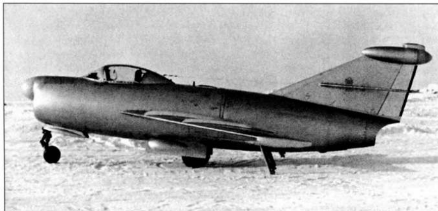
Пилотируемый вариант самолета-снаряда «КС»
