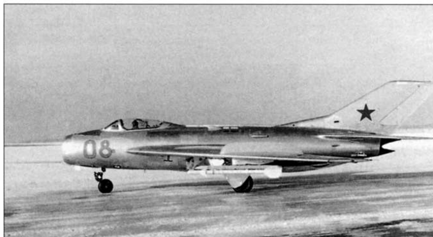
СМ-9Т с опытными ракетами К-13
