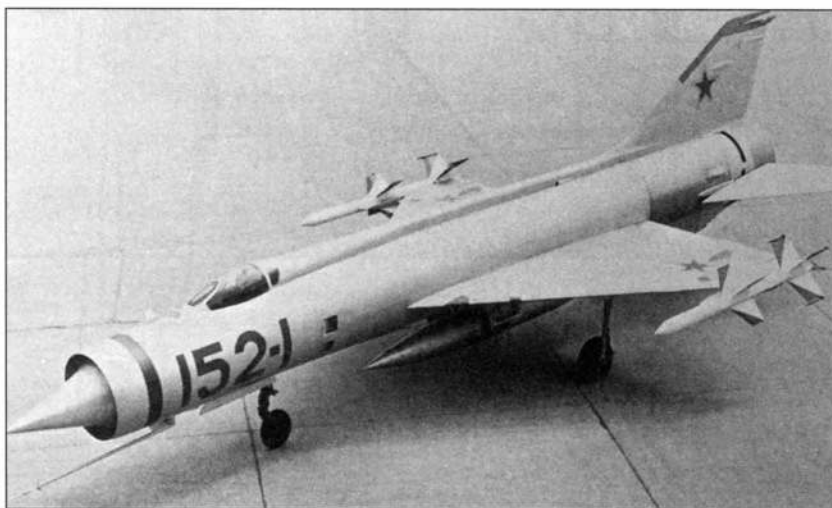
Первый экземпляр перехватчика Е-152/1 с двигателем Р15-300 и макетами ракет К-9
