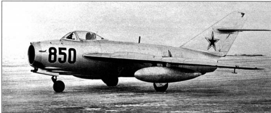
Опытный экземпляр истребителя «СФ» с двигателем ВК-1Ф
