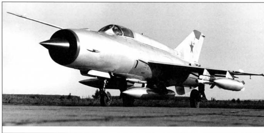
Фронтальной истребитель-перехватчик МиГ-21М с ракетами Р-3С и дополнительными топливными баками
