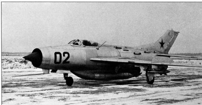
СМ-12ПМУ с ракетами РС-2-У и ускорителем с ракетным двигателем
