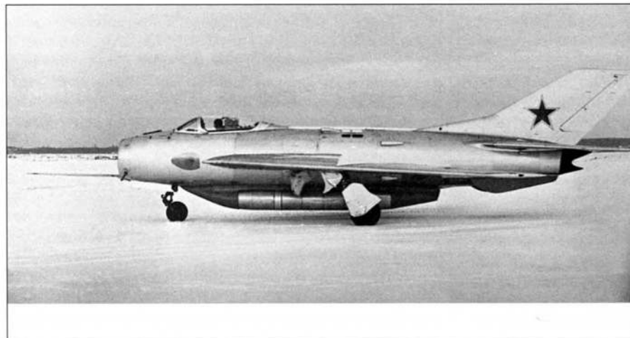
Перехватчик СМ-50 с дополнительным ракетным двигателем
