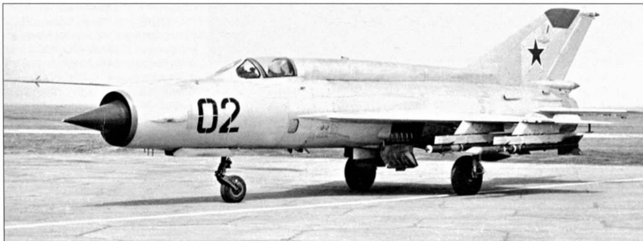
Фронтовой истребитель-перехватчик МиГ-21С с самонаводящимися ракетами Р-3С и Р-3Р
