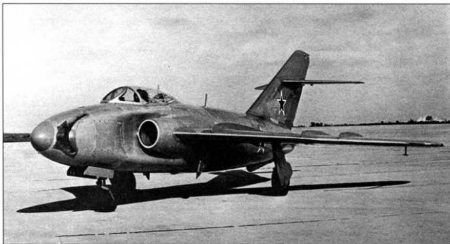
Опытный самолет «СН» с подвижными в вертикальной плоскости пушками
