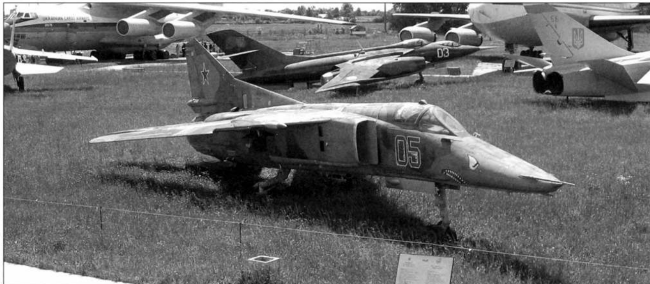
МиГ-27М с лазерной станцией подсвета и дальномерирования «Клен» в экспозиции Киевского авиационного музея
