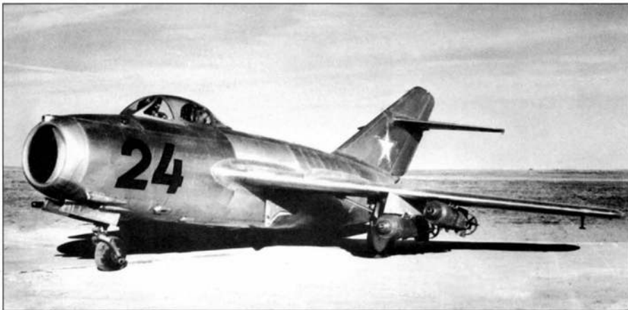
Истребитель-бомбардировщик МиГ-15бис с четырьмя бомбами ФАБ-250
