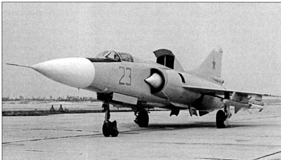
МиГ-23-1 (изделие «23-01») с подъемными двигателями
