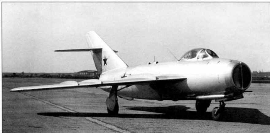
Опытный самолет SM-1 с двумя двигателями AM-5
