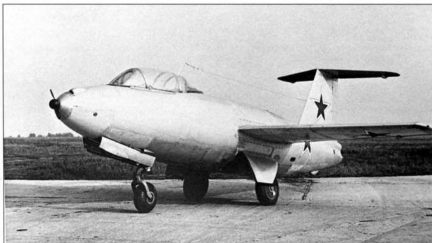
Опытный ракетный перехватчик И-270 с ЖРД
