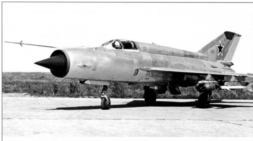
Фронтальной истребитель-перехватчик МиГ-21М с ракетно-бомбовым вооружением
