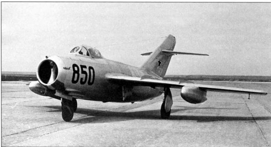
Один из первых серийных МиГ-15бис с двигателем ВК-1
