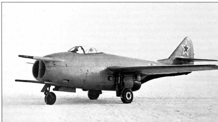
Пытаясь снизить влияние пороховых газов на работу силовой установки истребителя МиГ-9, 37-миллиметровую пушку расположили около верхней обечайки воздухозаборника
