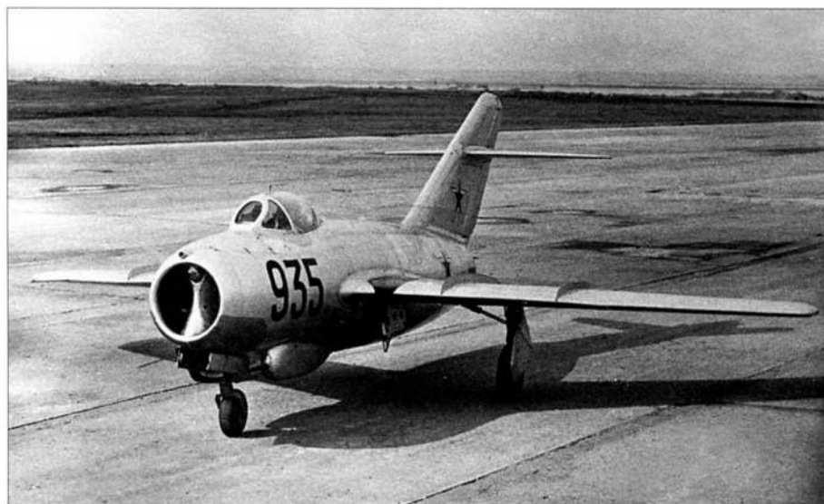
Опытный самолет «СУ» с ограниченно-подвижными пушками
