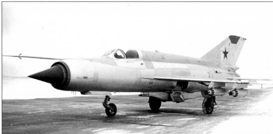
Фронтовой истребитель-перехватчик МиГ-21С с блоками неуправляемых ракет УБ-32
