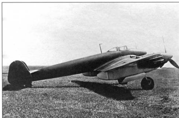
Двухмоторный истребитель сопровождения ДИС-200 с двигателями АМ-37
