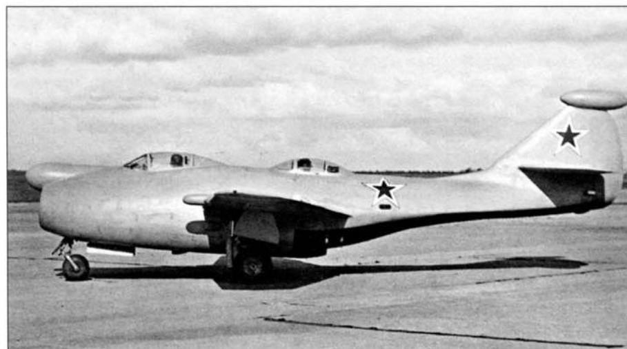
Самолет «ФК» — летающая лаборатория для отработки системы наведения крылатой ракеты «КС» («Комета»)
