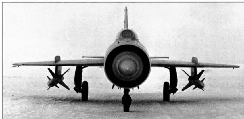
Перехватчик И-75 с системой наведения «Ураган-5» и ракетами К-8
