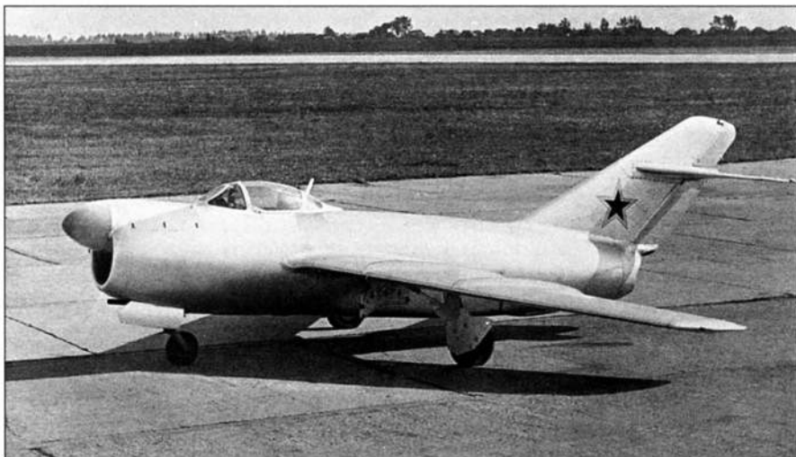
Опытный перехватчик СП-1 с РЛС «Торий»
