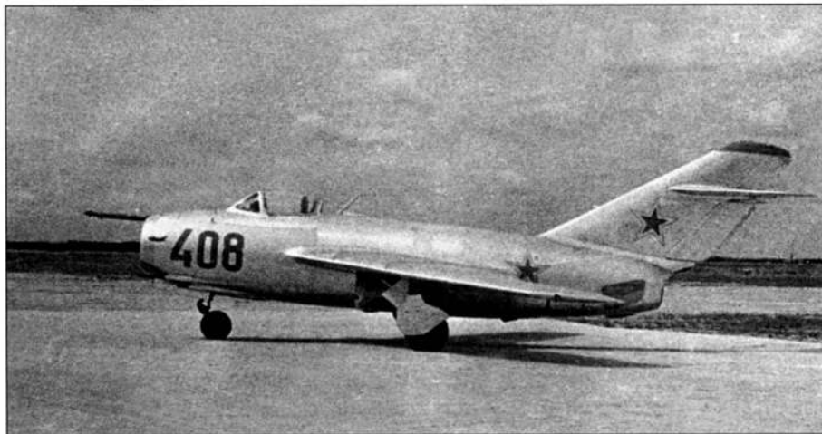
МиГ-15 «Бурлаки», оснащенный системой буксировки «Гарпун»
