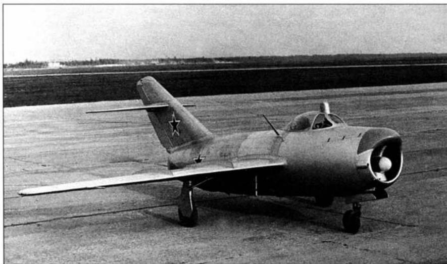
Опытный перехватчик СП-5 с двухантенной РЛС «Изумруд»
