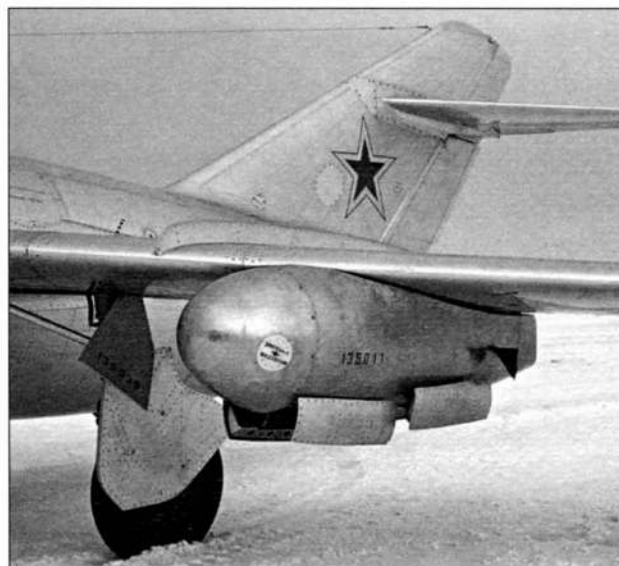
Контейнер системы «Град» с открытыми створками люков под крылом МиГ-15бис
