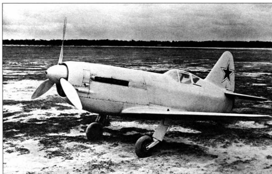
Опытный истребитель И-250 с комбинированной силовой установкой, включавшей маршевый поршневой мотор ВК-107А и воздушно-реактивный компрессорный двигатель (ВРДК)
