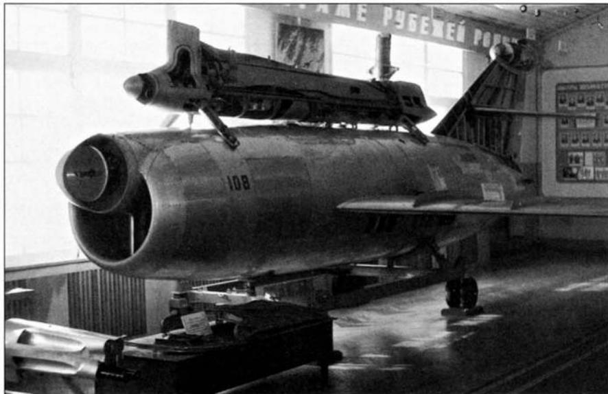
Препарированный самолет-снаряд «КС»
