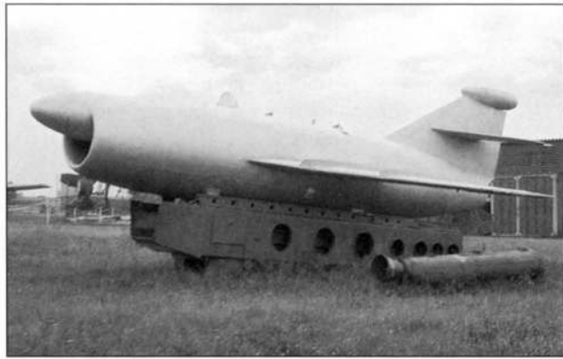
Крылатая ракета С-2 комплекса береговой обороны «Сопка» на транспортно-пусковой установке
