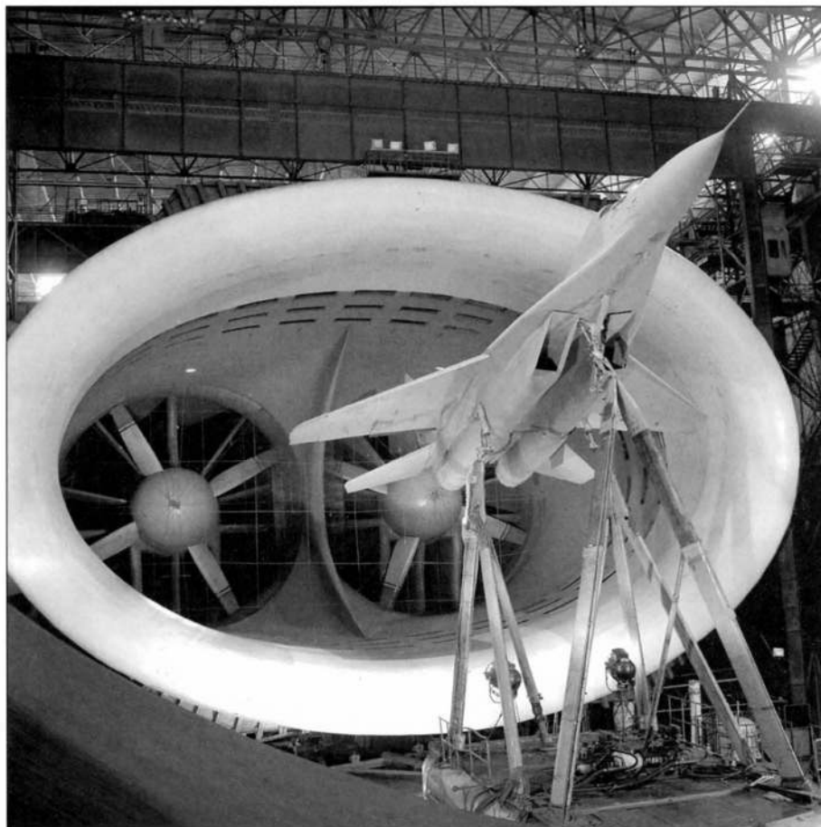
МиГ-29 в натурной аэродинамической трубе Т-101 ЦАГИ. Фото П. Иванова
