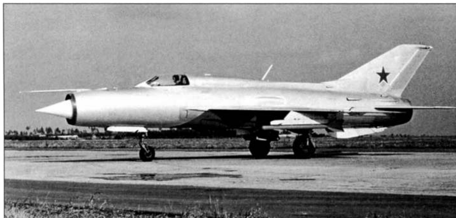
Первый серийный перехватчик МиГ-21ПФ отличался от предшественников накладным топливным баком и штангой приемника воздушного давления, установленной над воздухозаборником
