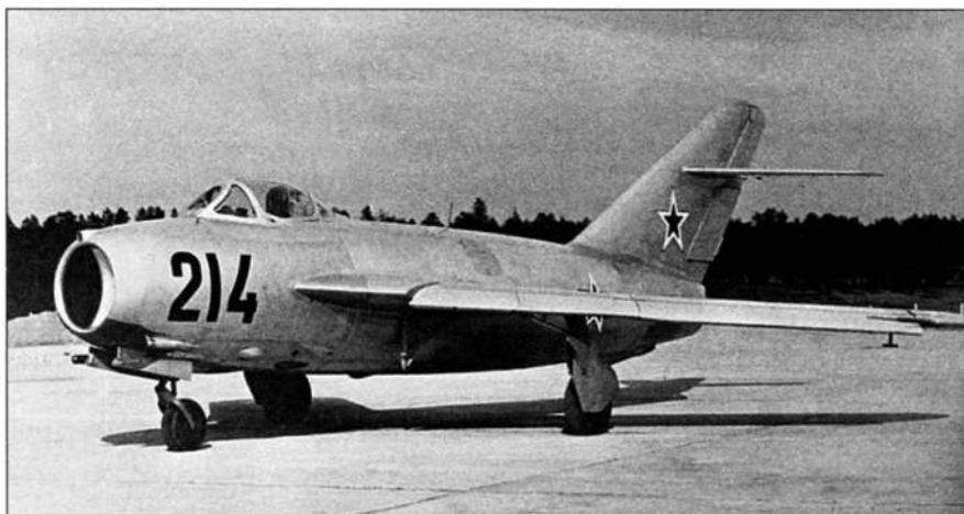
Летающая лаборатория СИ-10 с крылом, оснащенным предкрылками, и управляемым стабилизатором
