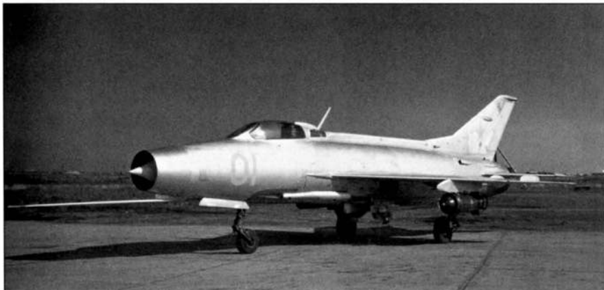
МиГ-21Ф-13 — первый отечественный истребитель, в состав вооружения которого входили самонаводящиеся ракеты Р-3С с тепловой головкой самонаведения
