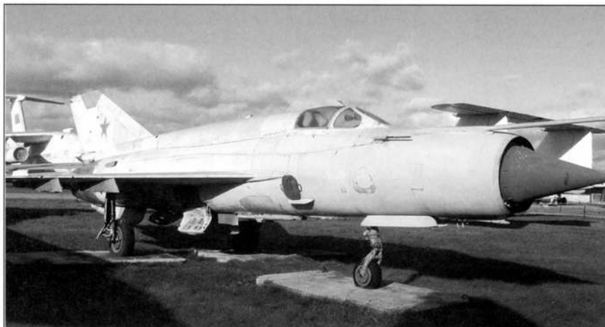
МиГ-21бис — последняя серийная модификация истребителя
