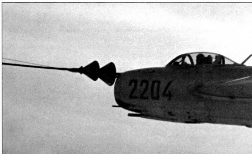
Дозаправка топливом в полете истребителя МиГ-15бис
