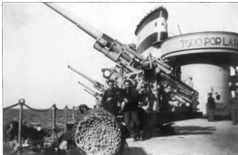
Вверху: смешанная батарея вспомогательного калибра крейсера «Baleares» вскоре после его вступления в строй: неуниверсальные 120-мм/45 орудия «Vickers-Armstrong» Mk.F, 100-мм/47 итальянские зенитные орудия «ОТО» и 40-мм/39 «пом-помы» Внизу: зенитная батарея «Baleares» после июля 1937 г. состояла из универсальных 120-мм/45 орудия «Vickers-Armstrong» Mk.F
