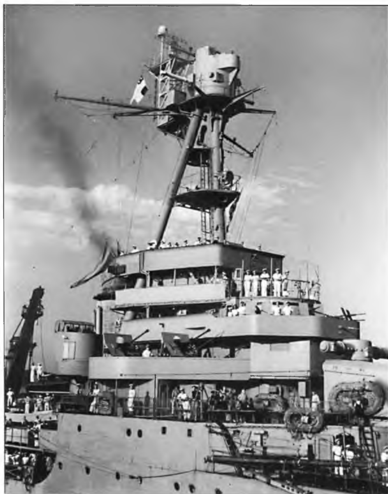
Надстройка крейсера «Tourville» после модернизации в США
