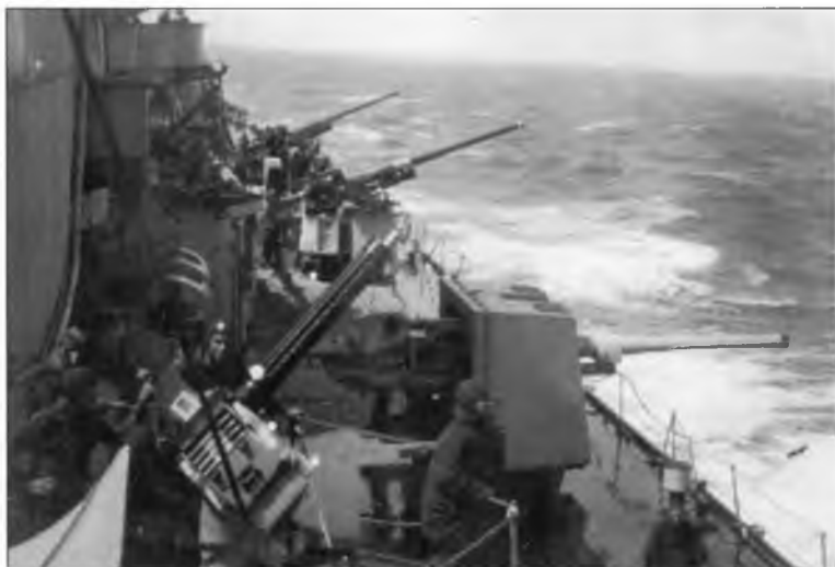
Вверху: смешанная батарея вспомогательного калибра крейсера «Baleares» вскоре после его вступления в строй: неуниверсальные 120-мм/45 орудия «Vickers-Armstrong» Mk.F, 100-мм/47 итальянские зенитные орудия «ОТО» и 40-мм/39 «пом-помы» Внизу: зенитная батарея «Baleares» после июля 1937 г. состояла из универсальных 120-мм/45 орудия «Vickers-Armstrong» Mk.F
