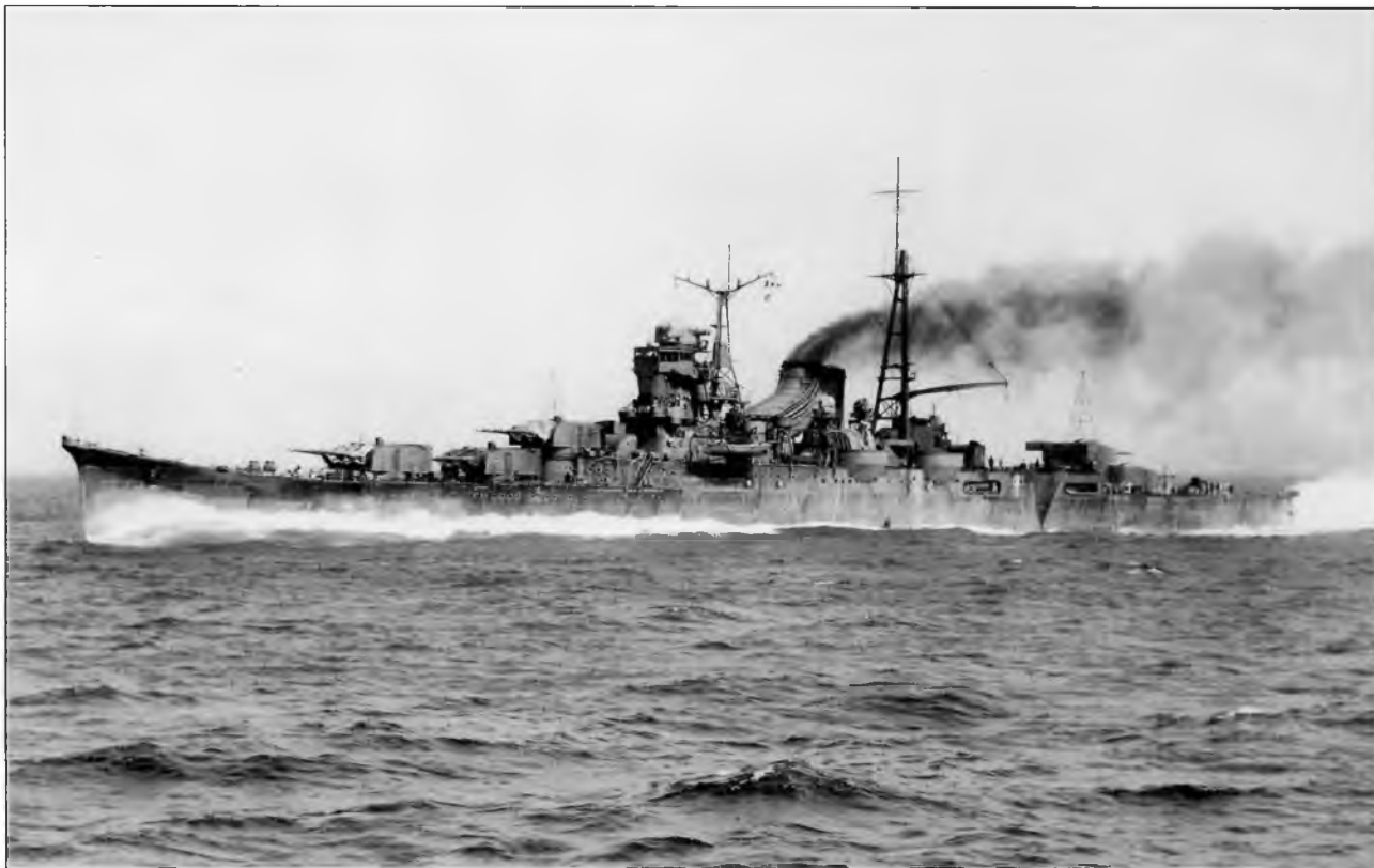
Японский крейсер «Mogami» на испытаниях, 20 марта 1935 г. На корабле отсутствуют катапульты, легкое зенитное вооружение и кормовая пара 127-мм установок
