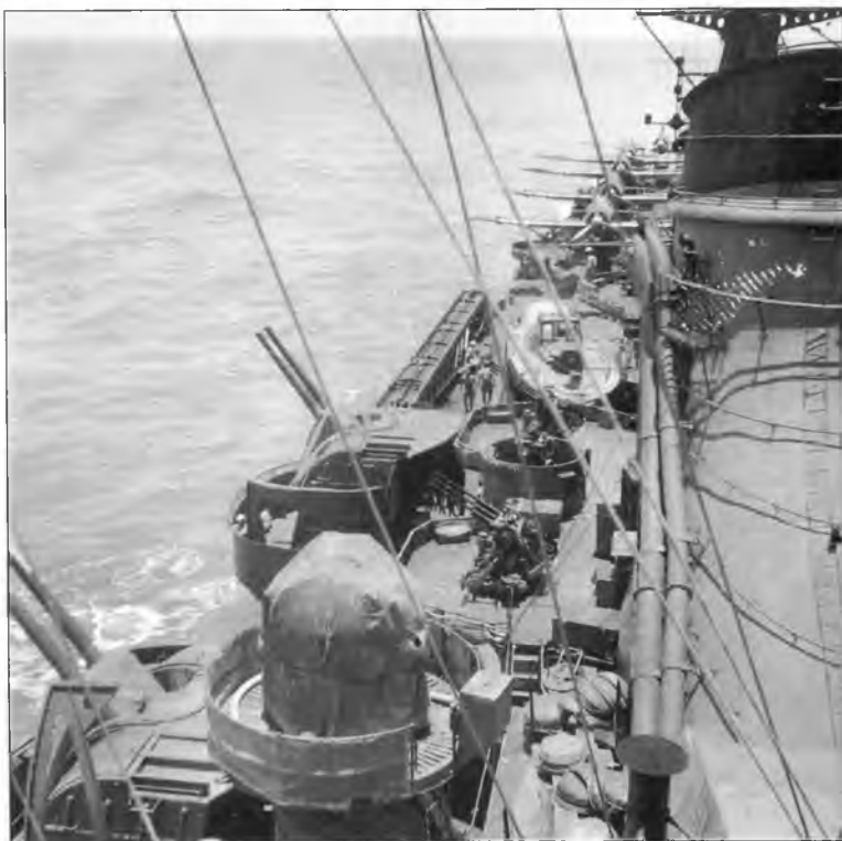
Крейсер «Mogami» после модернизации в авианесущий крейсер: с корабля сняли две кормовые башни ГК, а в корме оборудовали место для хранения 11 гидро-самолетов. Июль 1943 г.
