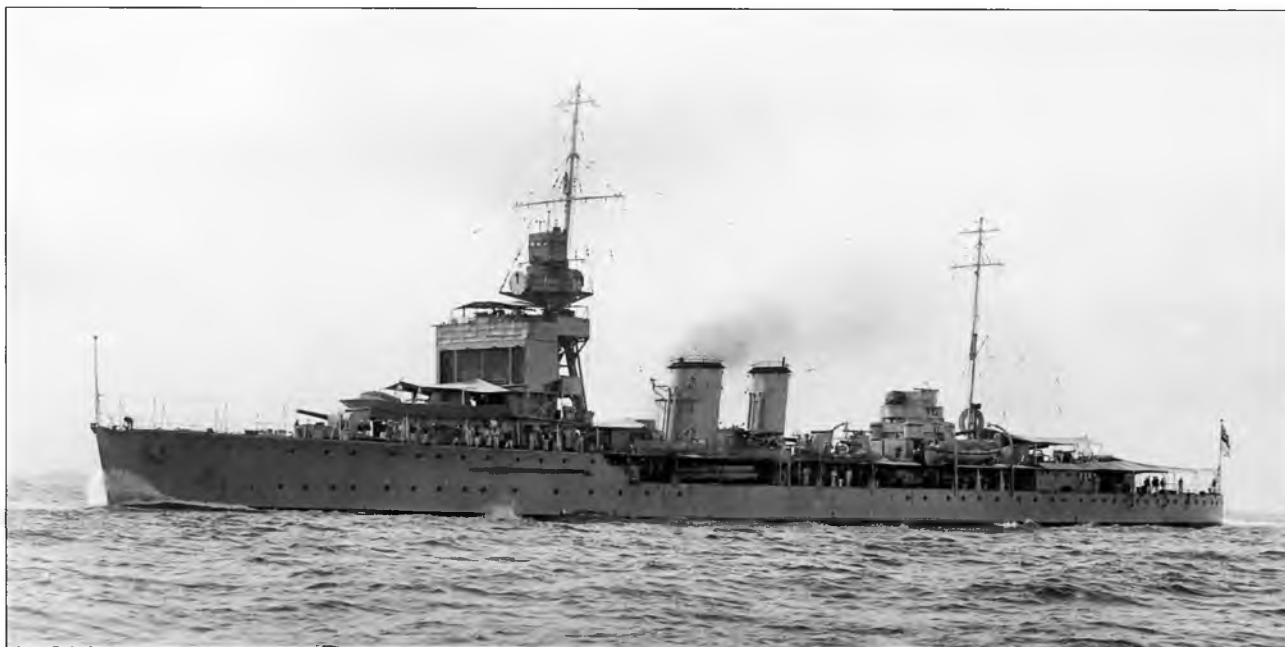
«Dragon» во время Имперского круиза 1924 г. хорошо виден большой Т-образный ангаром, встроенным в носовую надстройку
