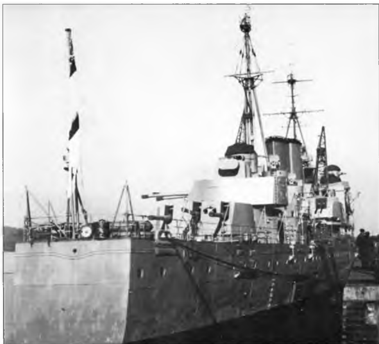
Легкий крейсер «Fiji» во время сдаточных испытаний, 1940 г. Хорошо видна транцевая корма
