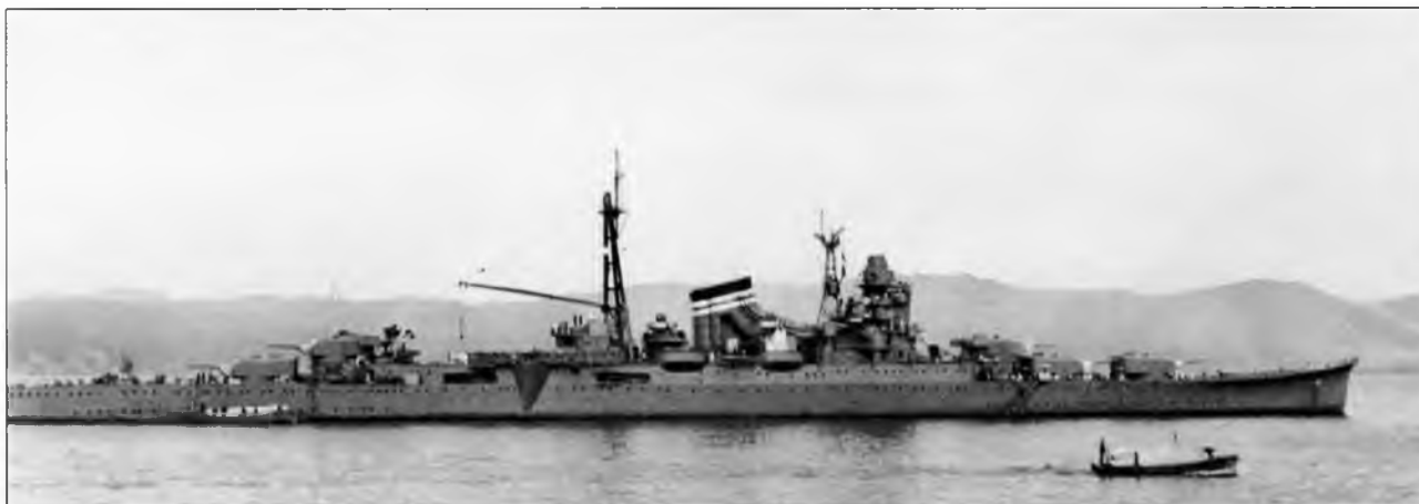
Крейсер «Mikuma», сентябрь 1935 г. Хорошо видно отсутствие двух 127-мм спаренных орудий
