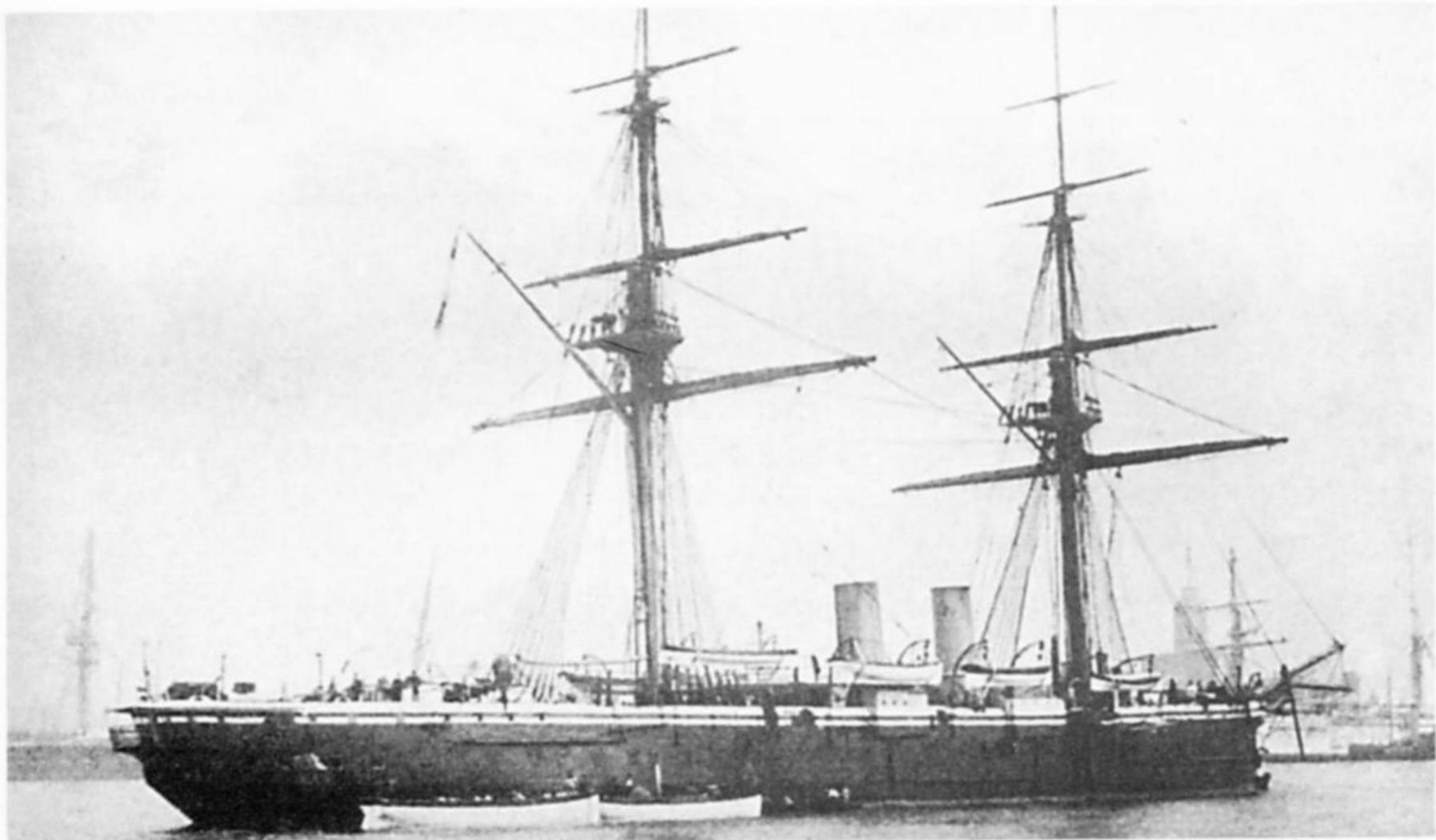
«Большой бриг» «Темерер», французское название которого *Temeraire* определённо восходит к одному из призов Королевского флота, был во многих отношениях экспериментальным кораблём. Относящийся в целом к типу броненосцев с центральным казематом, он также нёс два 11" орудия в барбетах на верхней палубе в носу и корме. Оба орудия устанавливались на снижающихся станках, позволявших перезаряжать их под броневым прикрытием без риска вывода из строя в результате прямого попадания.
