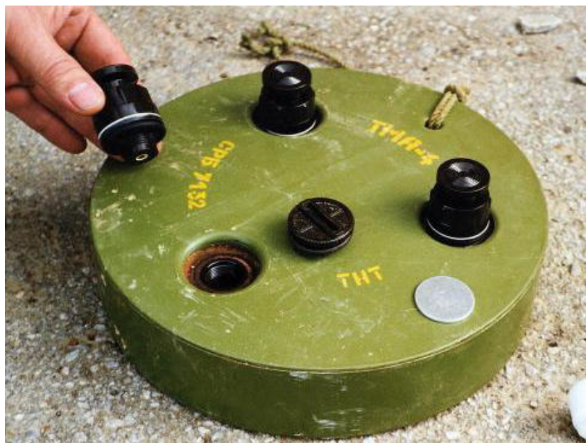
ФОТО 52. Противотанковая противогусеничная мина ТМА-4 // Lyn Haywood. Jane's Mines and Mine Clearance 1999–00 / Editor Colin King
