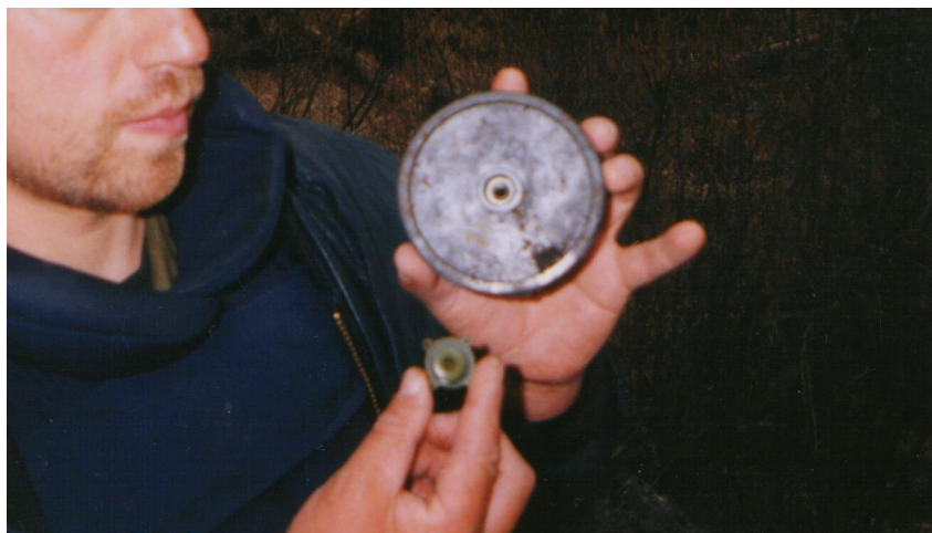
ФОТО 37. Установка взрывателя УПМАХ-3 в мину ПМА-3 // Фото автора
