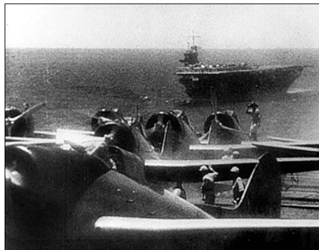
Пикирующие бомбардировщики D3A1 на полётной палубе авианосца «Акаги», апрель 1942 г. Авианосец на заднем плане – «Сорю»
