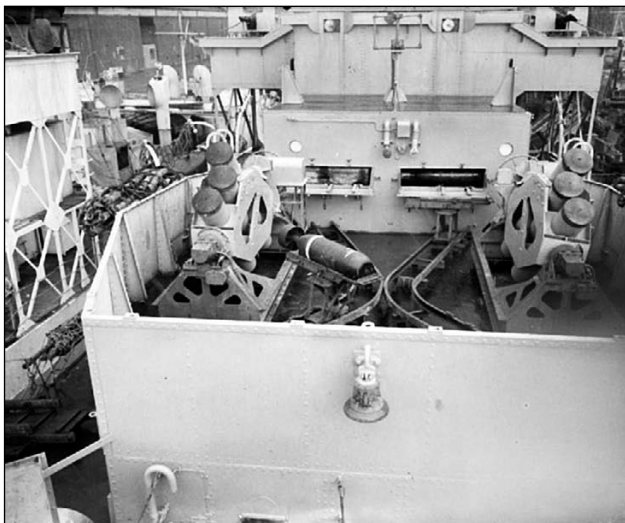
Бомбометы «Сквид» на носовой надстройке фрегата «Лох Фада» типа «Лох»
