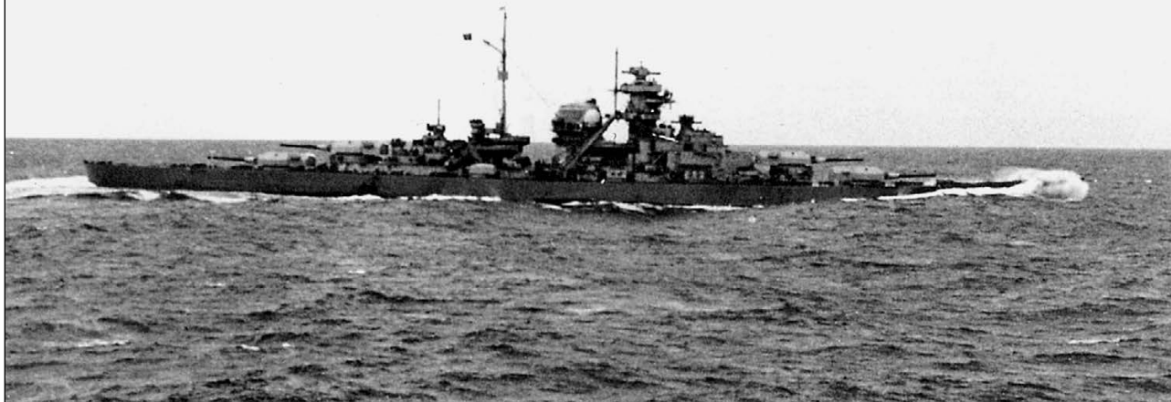
«Бисмарк». Утро 24 мая 1941 г. Снимок сделан с борта крейсера «Принц Ойген». Заметен дифферент на нос — следствие попадания снаряда с «Принс оф Уэлса»
