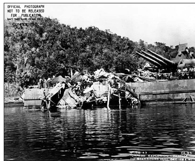
Повреждения крейсера «Портленд» в результате попадания японской торпеды
