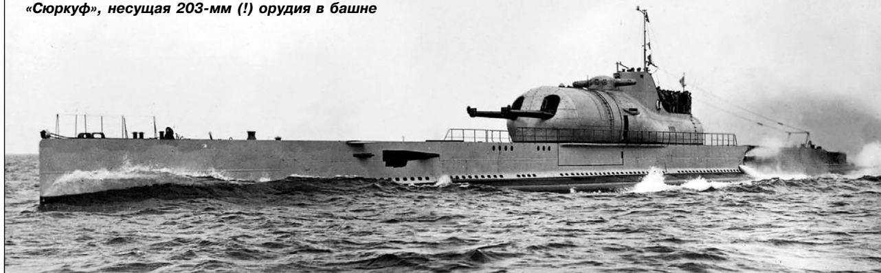
Французская крейсерская подводная лодка «Сюркуф», несущая 203-мм (!) орудия в башне
