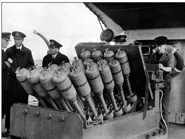
Реактивный противолодочный бомбомет «Хеджхог»
