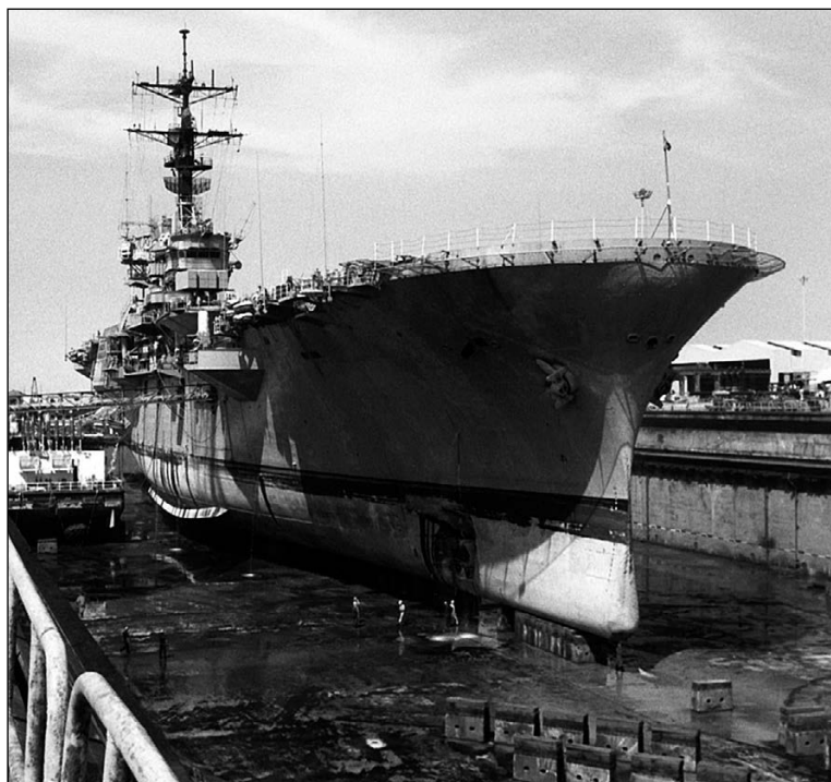
Десантный вертолетоносец «Триполи» в доке после подрыва на иракской мине 18 февраля 1991 г.
