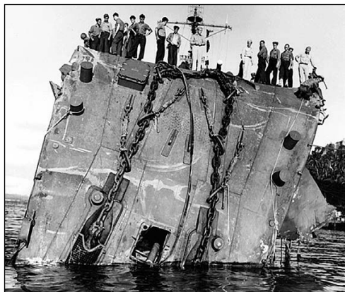
Повреждения американского легкого крейсера «Гонолулу», полученные в результате торпедного попадания во время боя у Коломбангара 17 июля 1943 года. Оба снимка сделаны в Туаги
