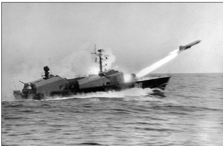
Пуск крылатой ракеты «Термит» с ракетного катера проекта 205
