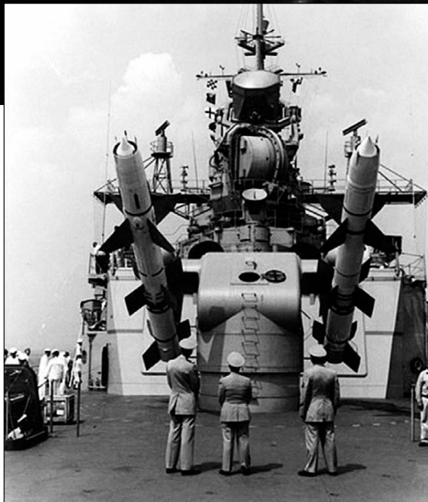
Пусковая установка зенитных ракет «Талос» крейсера «Лонг Бич», 1961 г.
