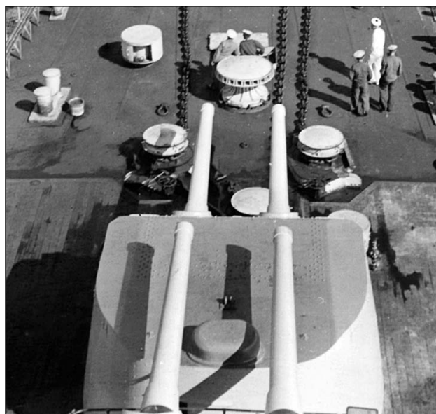
Вид с марса на двухорудийные 155-мм башни французского крейсера «Примоге» типа «Дюге Труэн»
