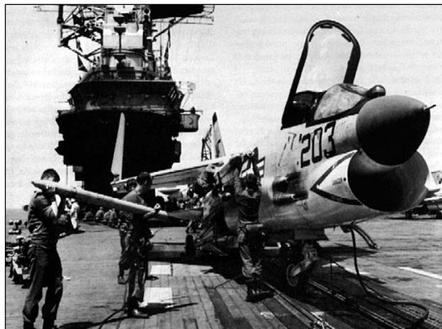
Палубная команда подвешивает неуправляемые ракеты «Зуни» под крыло «Крусейдера», авианосец «Тикондерога», август 1964 г., Тонкинский кризис
