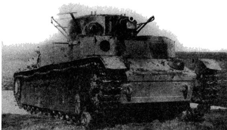
Советский танк Т-28. Несмотря на архаичный внешний вид с двумя пулеметными башнями — один из наиболее совершенных советских танков
