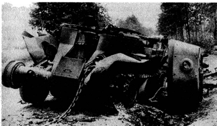
Подбитый и разрушенный взрывом боекомплекта танк ВТ-7. Советские легкие танки обладали низкой живучестью под огнем противотанковой артиллерии. 1941 г.
