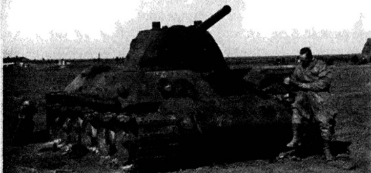
Подбитый и сгоревший (обратите внимание на сгоревшие резиновые бандажы опорных катков) летом 1941 г. танк Т-34
