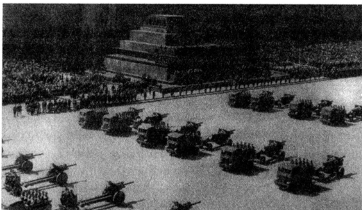
Перед Мавзолеем проходят трактора СТЗ-5 с 122-мм гаубицами М-30 и 152-мм М-10 на буксире. Трактор СТЗ-5 был хорошим тягачом для стрелковых дивизий, но мало подходил для мехкорпусов
