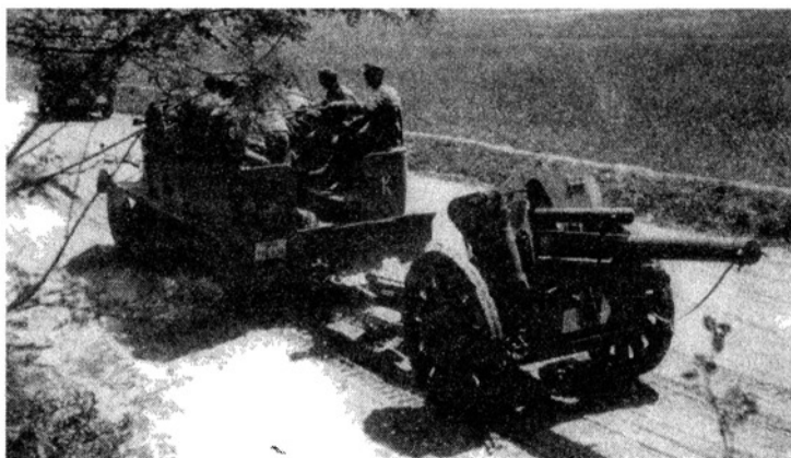
Немецкий полугусеничный тягач SdKfz.I 1 с 105-мм легкой полевой гаубицей 1eFH18 на буксире. Буква «К» означает «Клейст» — машина принадлежит к одной из частей 1-й танковой группы
