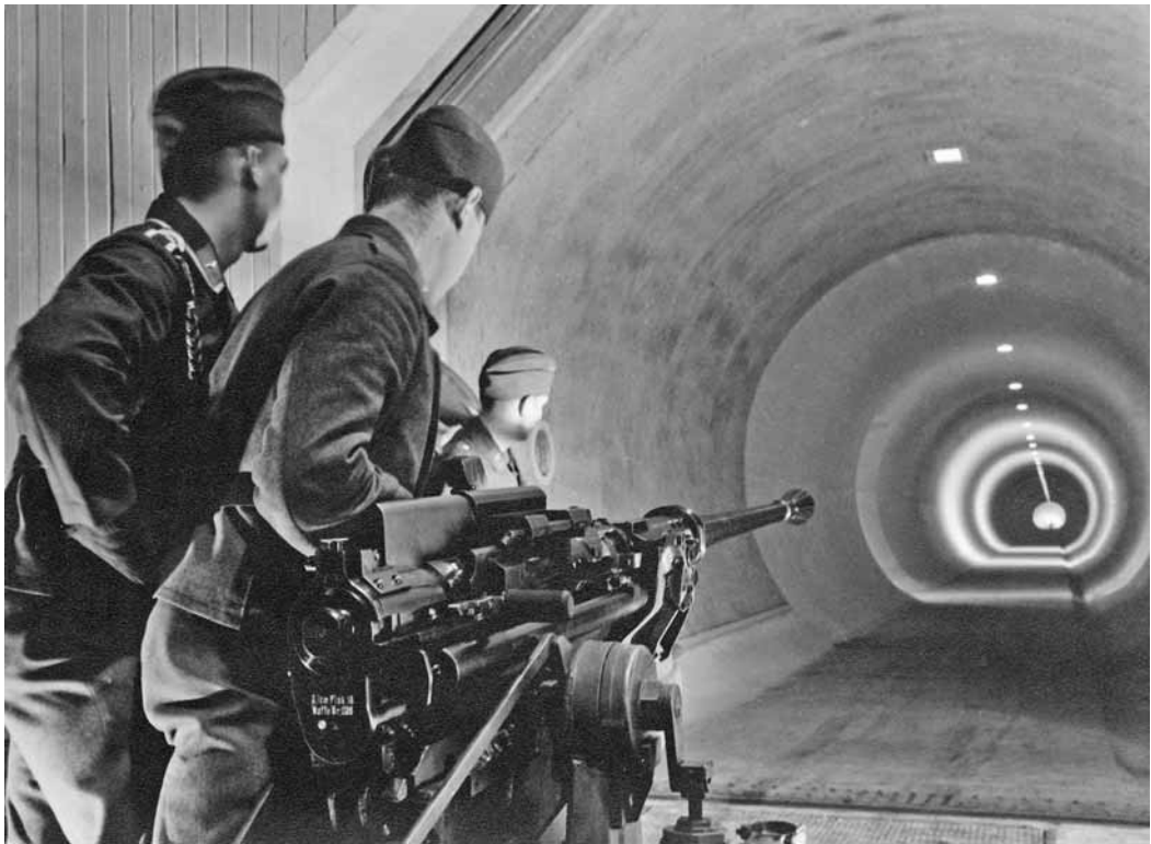
Испытания немецкого 37-мм зенитного орудия в баротоннеле
