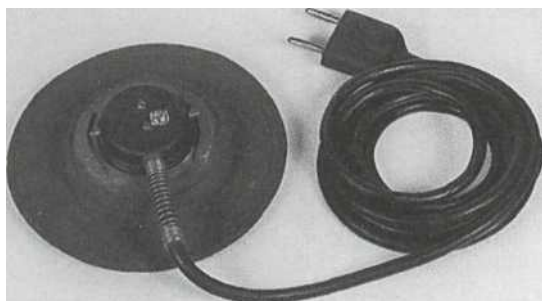
Наушник фирмы ТТК имел чехол из коричневого фетра, окружавший мягкую резиновую часть. Хорошо видны вывод электрического кабеля и вилка для подключения к бортовой аппаратуре.
