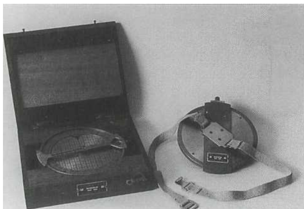
Две навигационных линейки для пикирующих бомбардировщиков. Линейка слева уложена в ящик для хранения с табличкой с технической информацией (Дейв Хукер). Линейка справа показана с нижней стороны. Хорошо видны лямки для фиксации инструмента на бедре и табличка с техническими данными. (Гари Найла)
