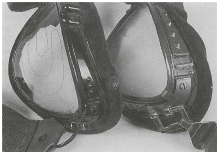
Слева: крупный план очков с электроподогревом, отличающихся тонкими проволочками, проложенными между двойными линзами, и рельефной эмблемой фирмы MAN на алюминиевой оправе. Заметен остаток электрического кабеля. Справа: экспериментальные незапотевающие очки со специфической G-образной пряжкой.
