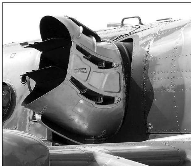
Экранно-выхлопное устройство двигателя
