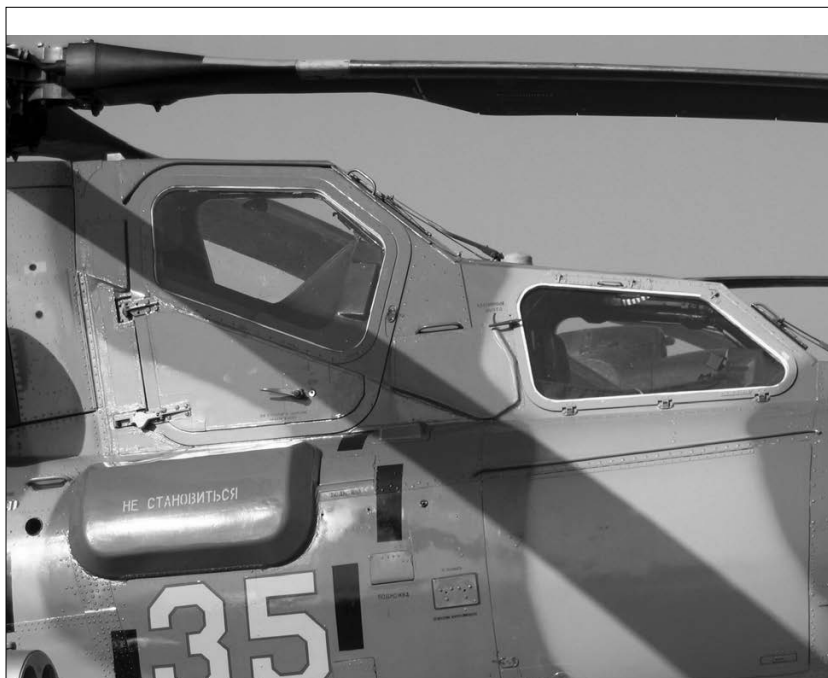
Остекление кабин экипажа «Ми-28Н». Под кабиной летчика виден обтекатель уложенного под него надувного аварийного трапа
