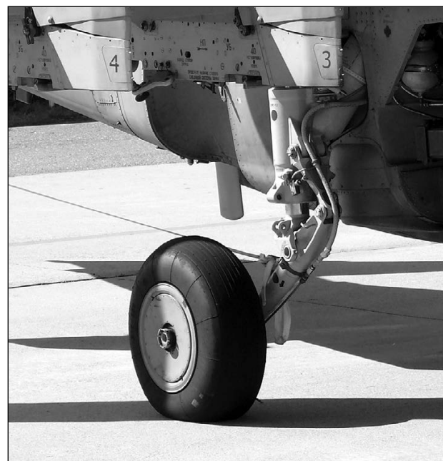
Основная опора шасси, вид спереди
