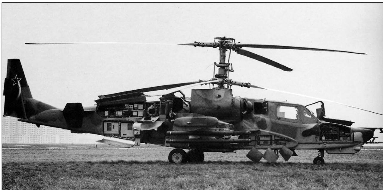
Доступ к оборудованию «Ка-50» был максимально облегчен благодаря шарнирно закрепленным панелям обшивки фюзеляжа
