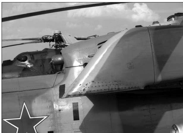
Выхлопной патрубок вспомогательной силовой установки и фрагмент экранно-выхлопного устройства двигателя
