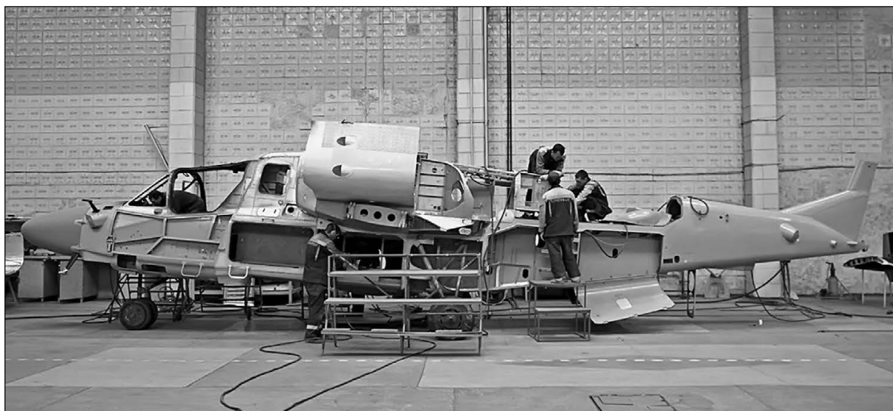
Каркас фюзеляжа «Ка-52»
