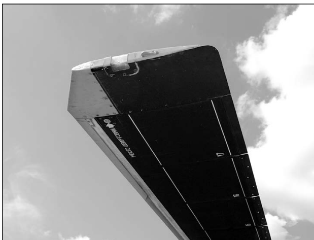
Законцовка лопасти несущего винта со стреловидной передней кромкой
