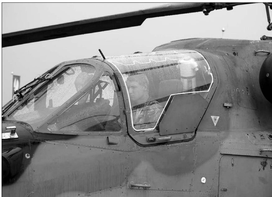
На откидных частях фонарей «Ка-52» установлены дополнительные бронешитки, защищающие летчика и штурмана
