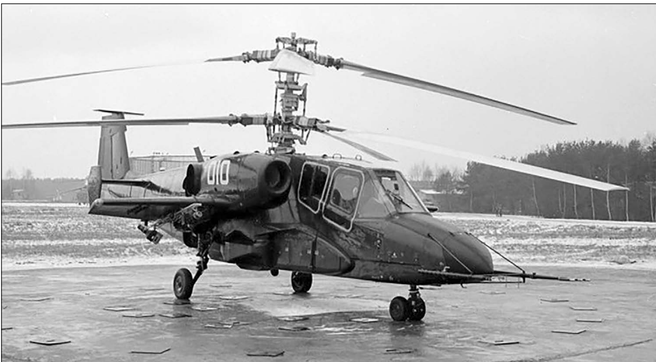
Первый опытный (демонстрационный) экземпляр вертолета «В-80» с нарисованными окнами
