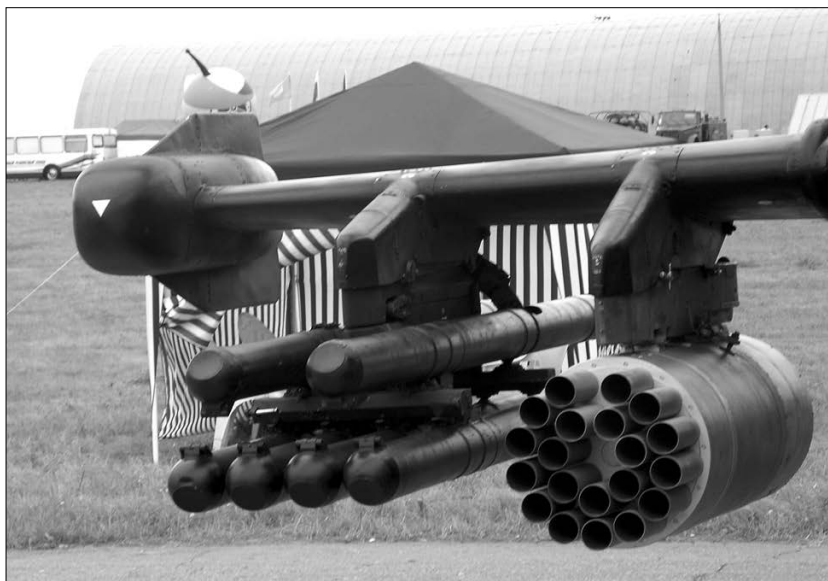
Блоки управляемых ракет «Вихрь» и Б-8Б20А НАР «С-8» под крылом «Ка-52»
