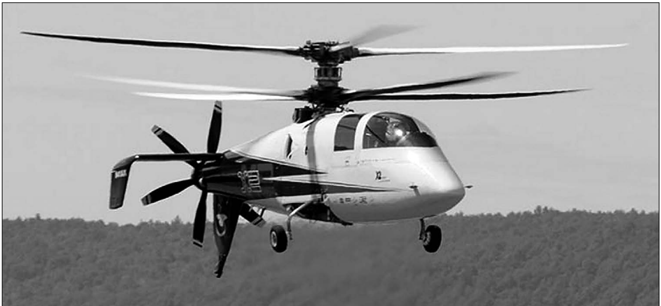
Экспериментальный вертолет «S-97» с толкающим винтом компании «Сикорский»
