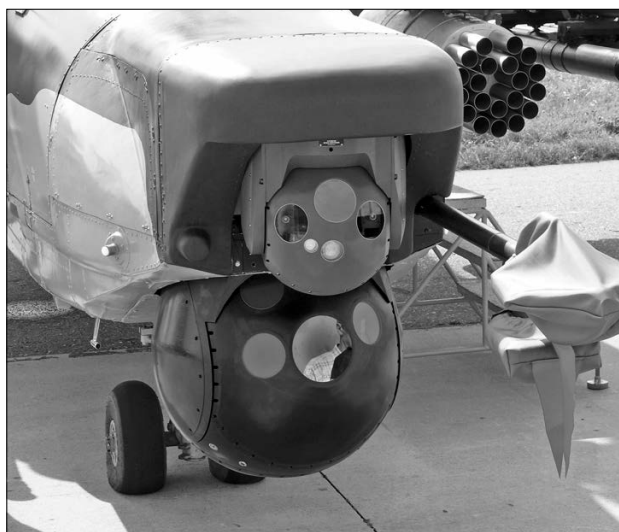
Оптико-электронная прицельная система ГОЭС-310 на «Ка-50» (борт № 18)
