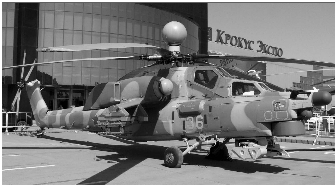
Пятый экземпляр «Ми-28Н» установочной серии с РЛС Н0-25
