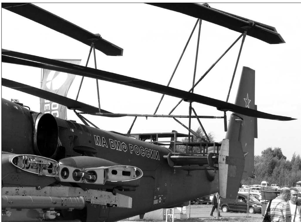
«Ажурная» конструкция фиксатора лопастей несущих винтов
