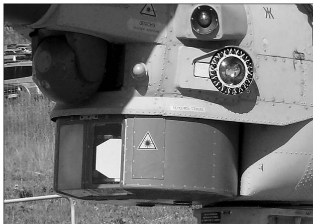
ГОЗС-521 (вверху) и комплекс «Тор» для наведения противотанковых ракет с лазерной ГСН в боевом положении
