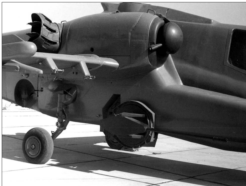
Макет 20-мм пушки на турели GIATT вертолета «Ка-50-2»
