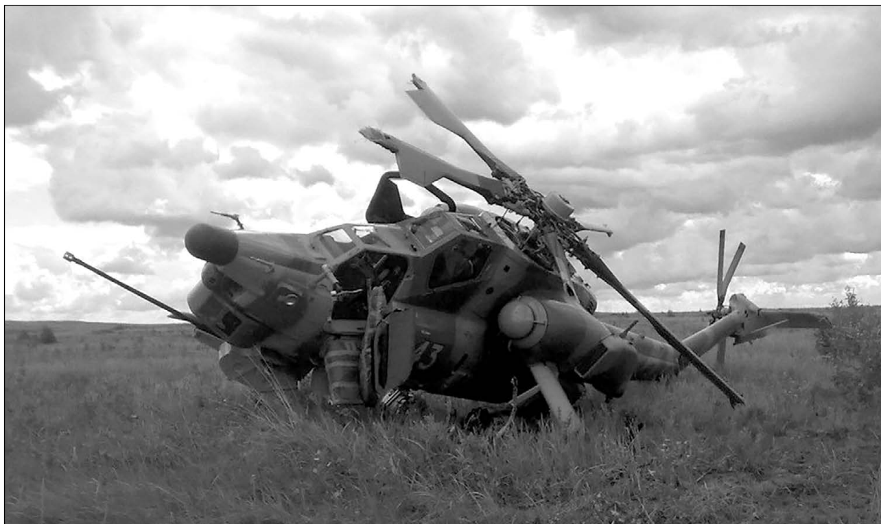
«Ми-28Н» после аварийной посадки 19 июня 2009 года на Гороховецком полигоне. Виден надутый аварийный трап штурмана
