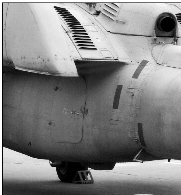
Дверь для «спецназа». Вход и выход в нее возможны лишь после остановки левого двигателя
