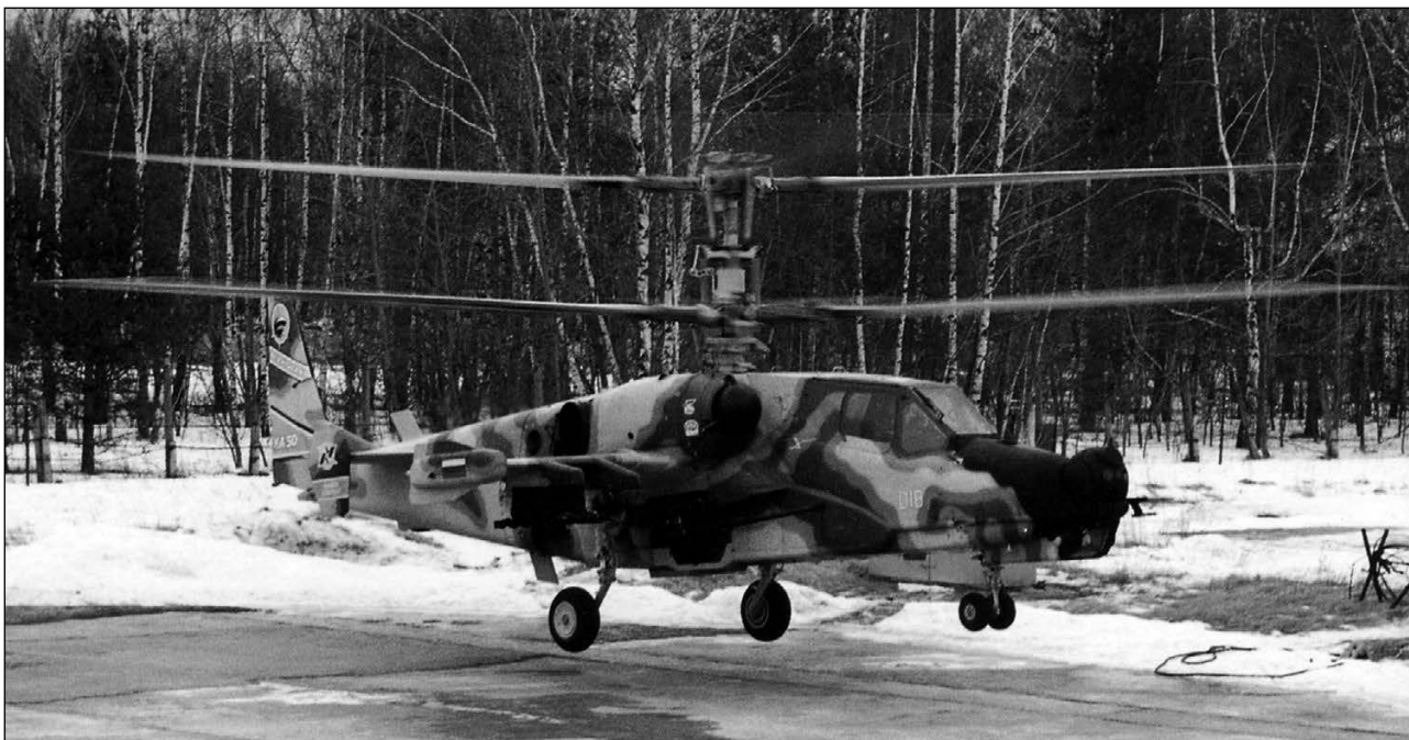
Опытный экземпляр «Ка-50Ш» с верхним расположением системы «Самшит-50». Фото А. Михеева
