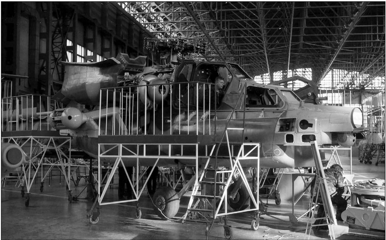
Сборка первого «Ми-28Н» на заводе «Роствертол», правда, опытного экземпляра ОП-2 (бортовой № 02, затем № 024). Осень 2002 г.
