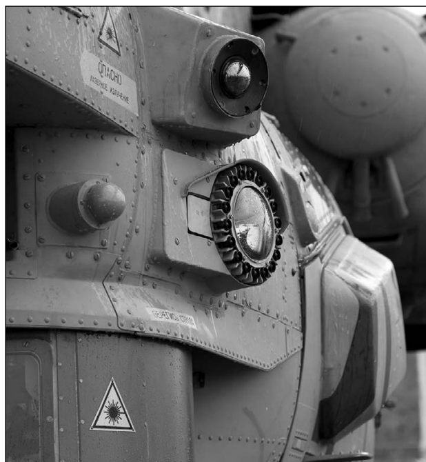
Светотехническое оборудование вертолета. Внизу — посадочная фара
