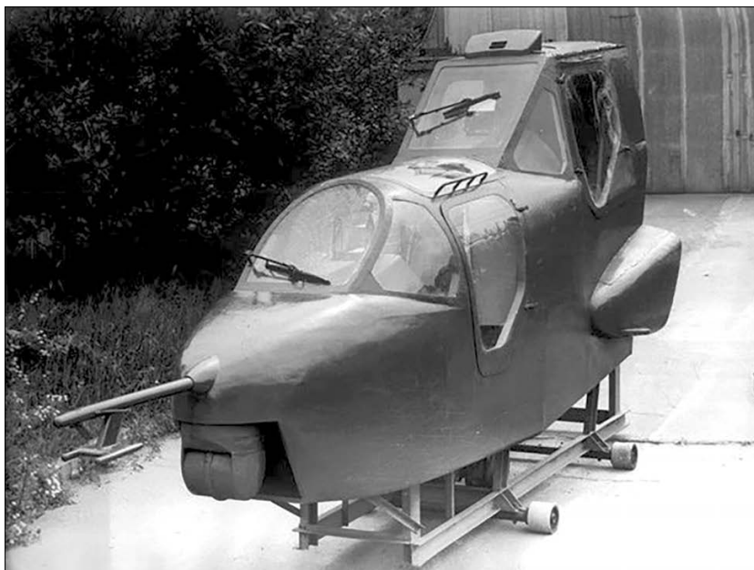
Макет носовой части двухместного вертолета «Ка-50-2».
