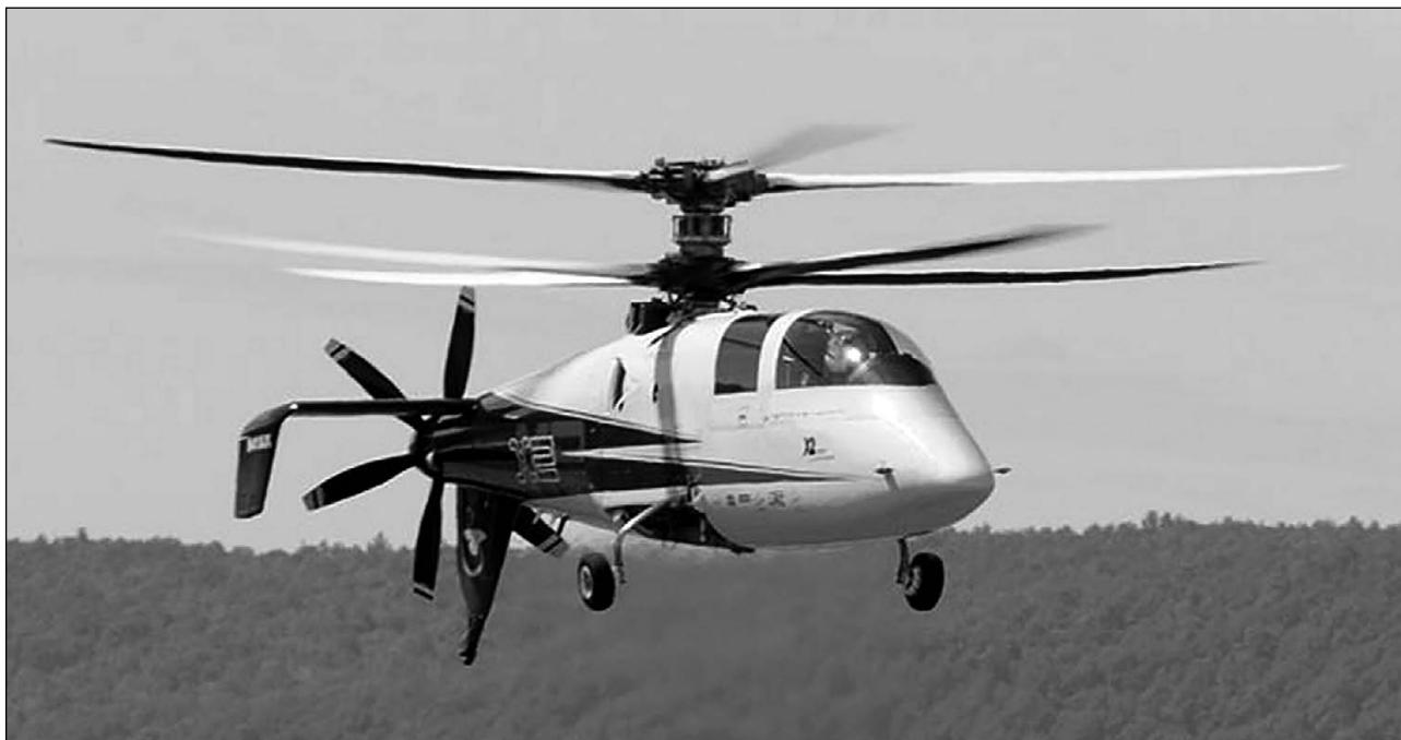
Экспериментальный вертолет «Х2» с толкающим винтом компании «Сикорский»
