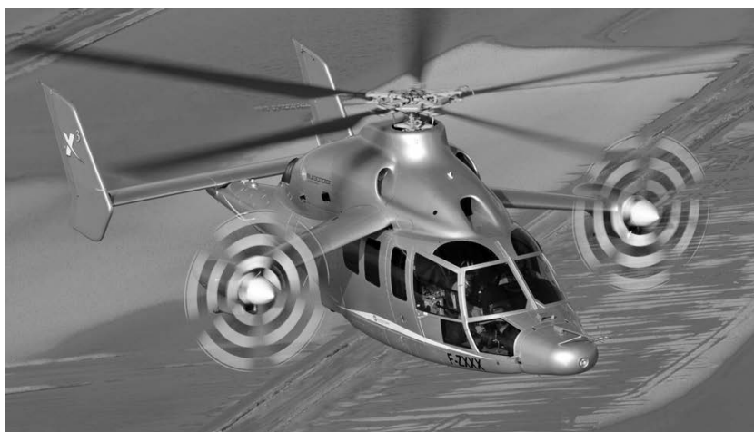
Экспериментальный вертолет с тянущими винтами «Х3», созданный на базе «ЕС155» компании «Еврокоптер»
