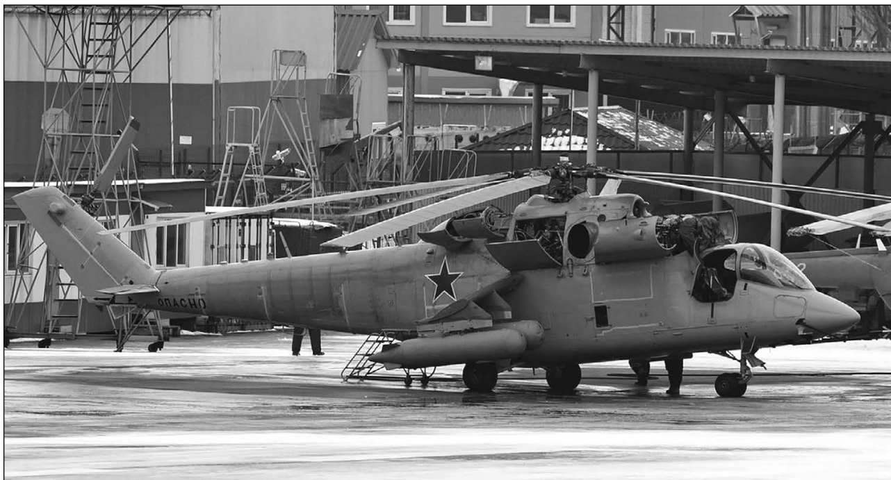
Подготовка к испытаниям летающей лаборатории, предназначенной для исследований перспективного скоростного вертолета
