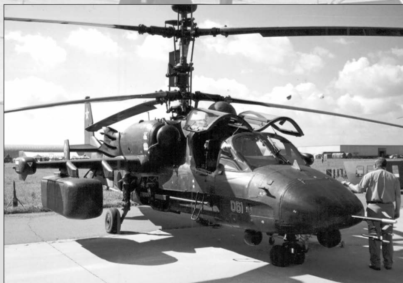
Первый опытный экземпляр «Ка-52» с обтекателем антенны наддулоочной РЛС, ОПС «Самшит», ТОЭС-520 и ГОЭС-451 на МАКС-2005
