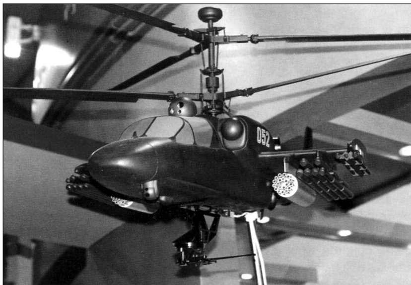
Модель экспортного варианта вертолета «Ка-52К» с откидной артиллерийской установкой
