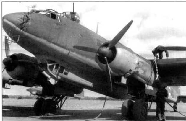
Носовая часть FW 200C-4 с антеннами РЛС
