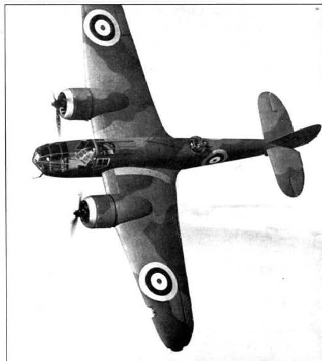
«Бленхейм» Mk.IV отличался удлиненной носовой частью
