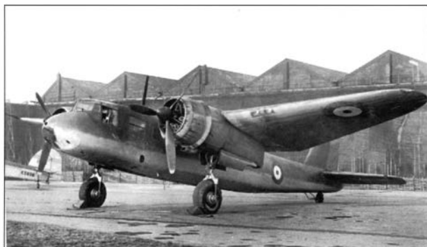
Вверху и внизу: «Бота» представлял собой двухмоторный моноплан с высокорасположенным крылом
