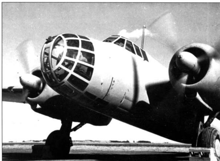
Вверху: остекление кабины Ки-48 обеспечивало неплохой обзор
