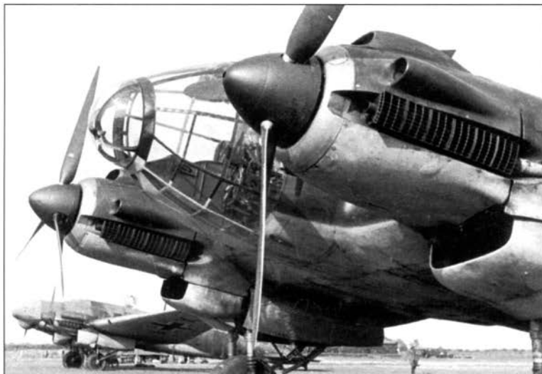
Из-за характерной несимметричной кабины He 111H прозвали «кривомордым»
