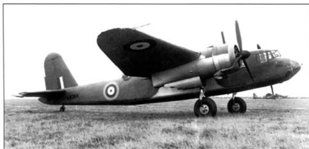
Вверху и внизу: «Бота» представлял собой двухмоторный моноплан с высокорасположенным крылом
