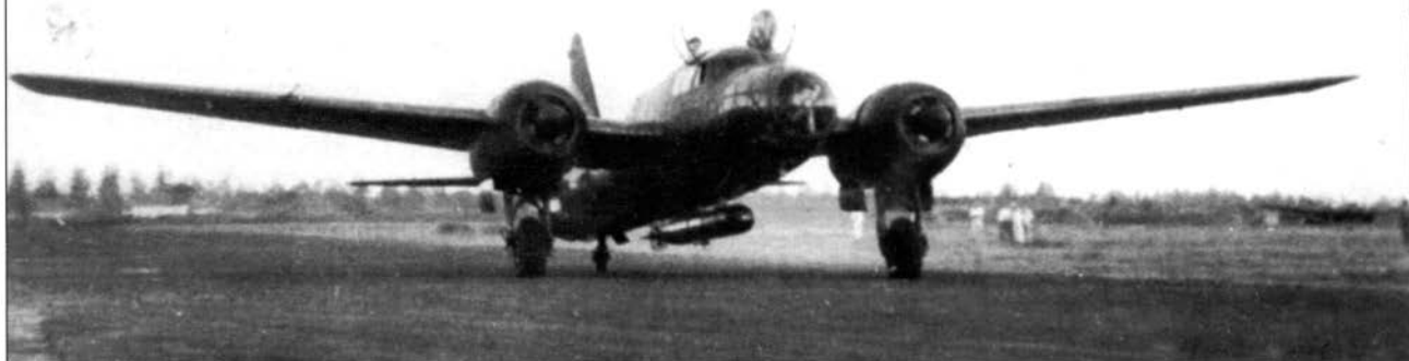
Ки-67 был приспособлен для применения торпед
