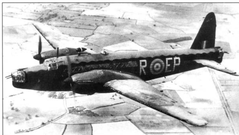
Вверху: бомбардировщик «Веллингтон» II с моторами «Мерлин» X
