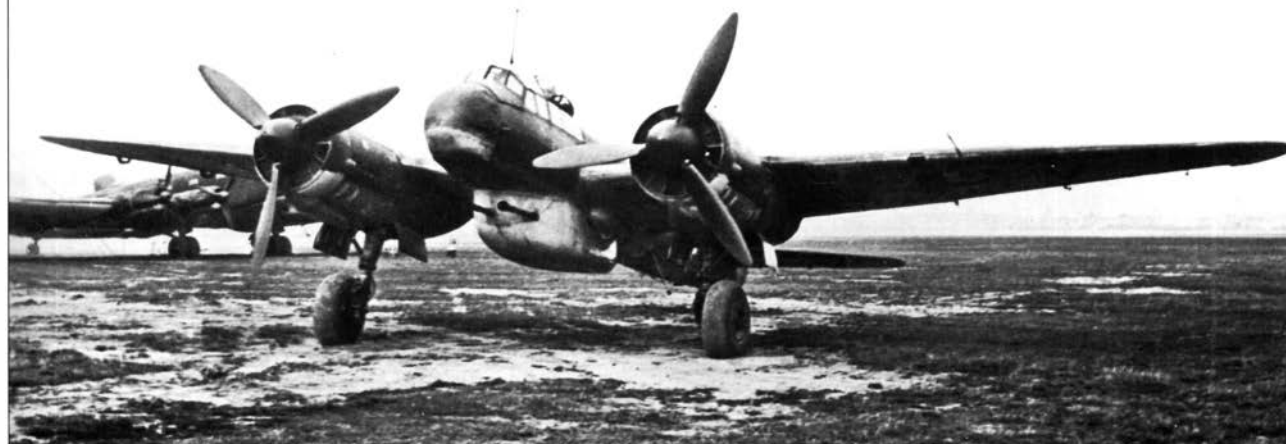
Самолет Ju 88P-2, вооруженный 2 37-мм пушками в подфюзеляжной гондоле
