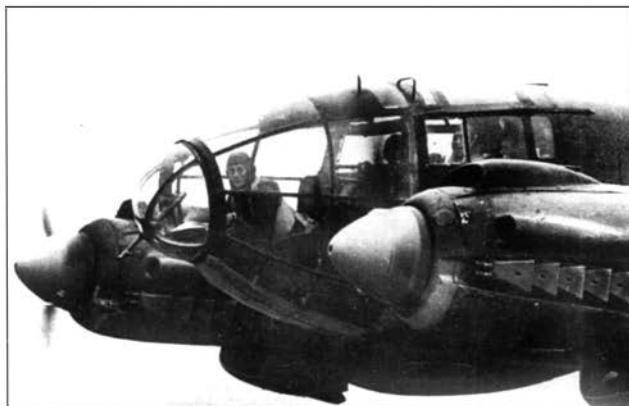
Самолеты He 111Р и Н получили новую носовую часть фюзеляжа с измененной кабиной экипажа
