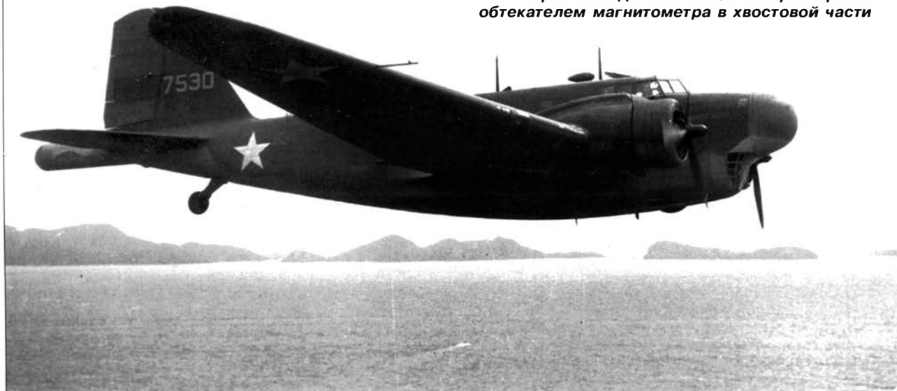
Противолодочный В-18В с характерным обтекателем магнитометра в хвостовой части
