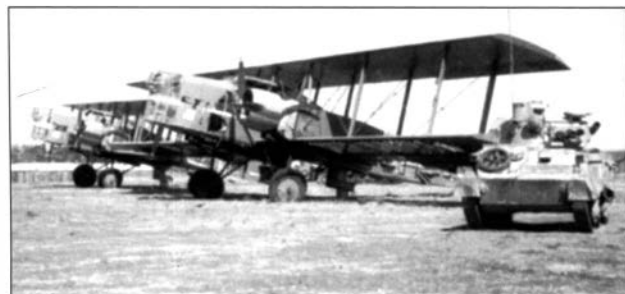
Внизу: существовала возможность перестановки LeO H.257/258 на колесное шасси
