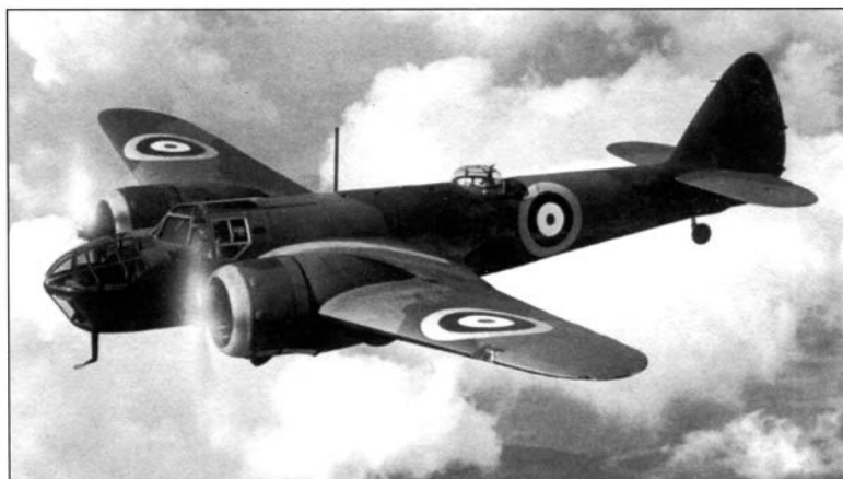
«Бленхейм» Mk.IV отличался удлиненной носовой частью
