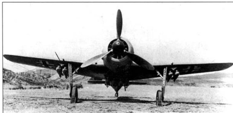
Внизу: FW 190F с подвешенными под крылом 4 50-кг бомбами
