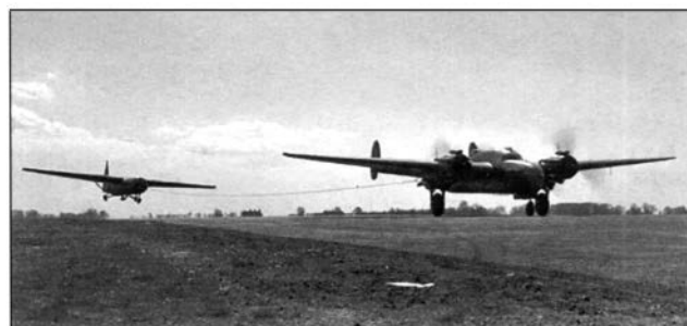
Вверху: впервые в британском самолетостроении «Альбермарл» получил шасси с носовой стойкой. Внизу: подавляющее большинство «Альбермарлов» применялось в качестве транспортных либо буксировщиков планеров
