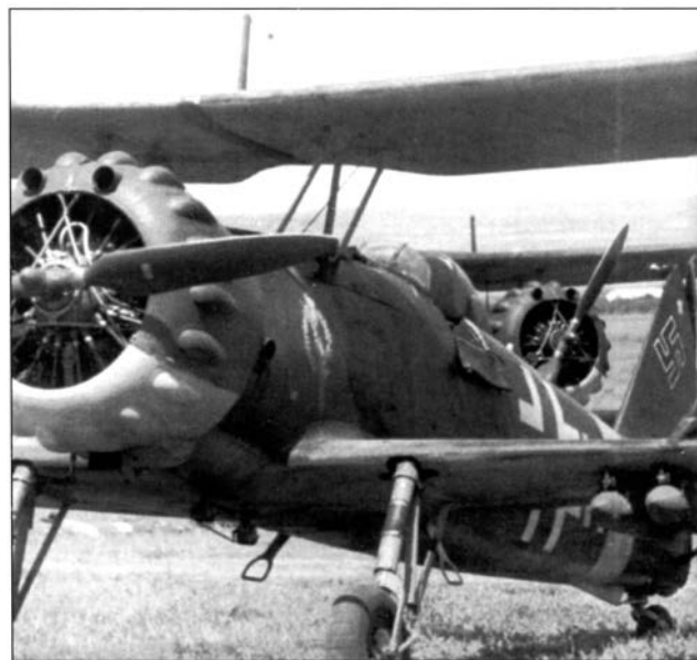
Hs 123A на полевом аэродроме. Самолет на переднем плане вооружен 50-кг бомбами
