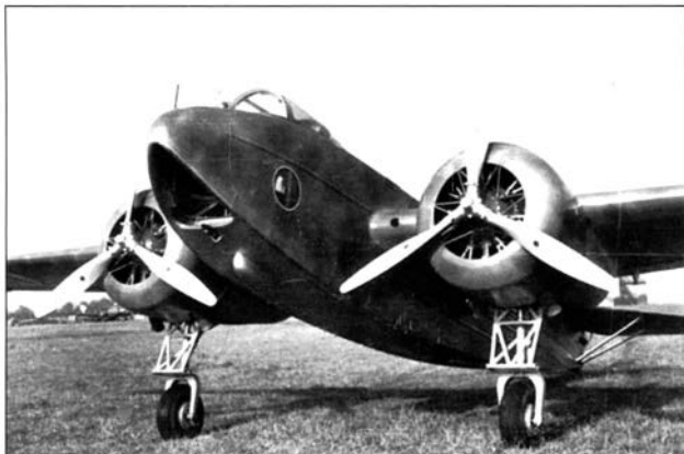
Для улучшения обзора кабина S.85 была максимально сдвинута вперед
