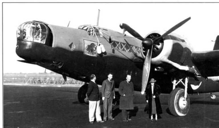
Внизу: большинство «Веллингтонов» комплектовалось моторами воздушного охлаждения «Пегасус»
