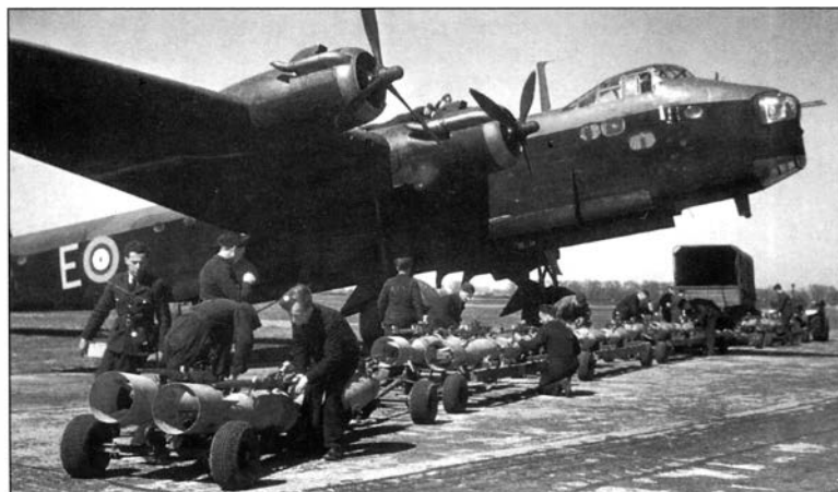
Подготовка к подвеске бомб под самолет «Стирлинг» I на аэродроме Уотербич, 1941 г.
