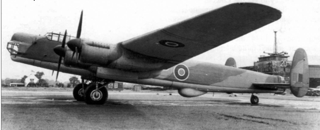
Прототип «Линкольна». Под хвостовой частью хорошо виден обтекатель РЛС H2S
