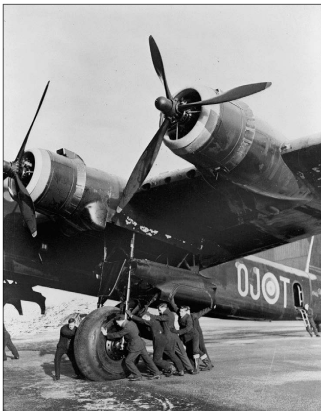
Колесо основной стойки «Стирлинга» имело диаметр с человеческий рост
