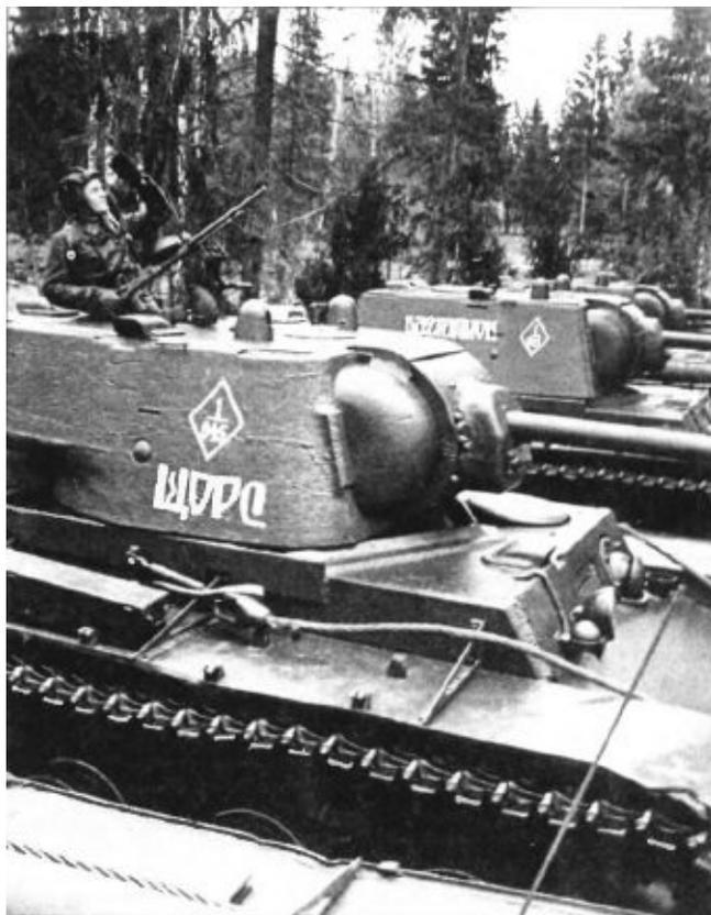
*В строю танки KV-1 116-й танковой бригады. Западный фронт, апрель 1942года. У танка «Щорс» башня литая, а у танка «Багратион» – сварная.*
