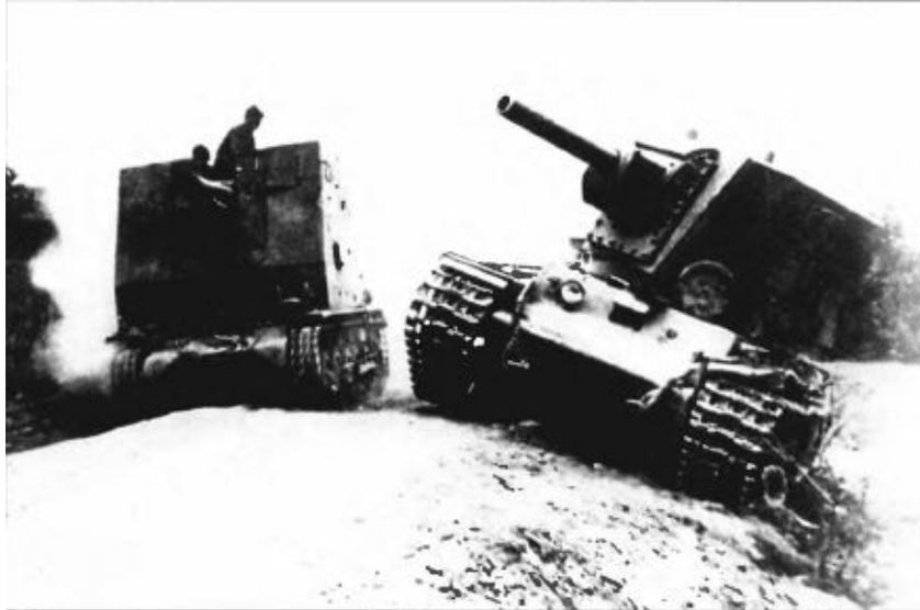
*А калибр у них одинаковый! 150-мм самоходное пехотное орудие на шасси танка Pz.I объезжает оставленный экипажем тяжёлый танк KV-2, вооружённый 152-мм гаубицей. Прибалтика, июнь 1941 года.*
