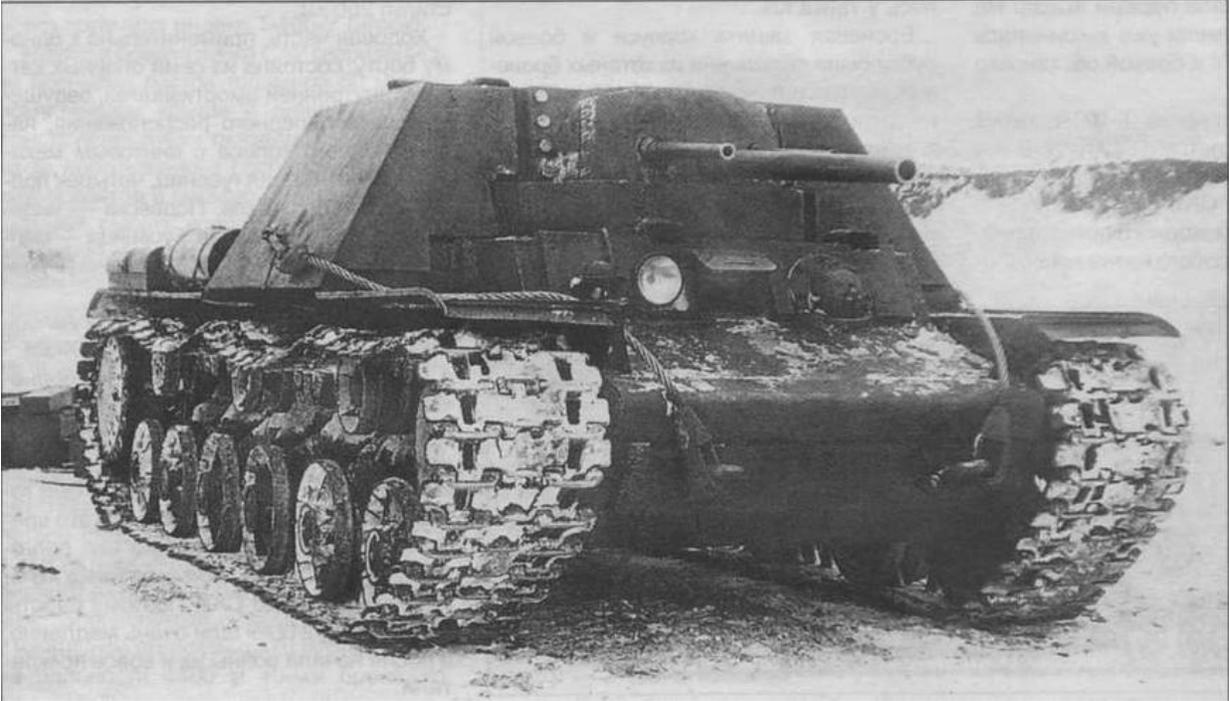
*Первый вариант артсамохода KV-7 (с двумя 45-мм и одной 76-мм пушками) во время испытаний на полигоне. Зима 1942 года*
