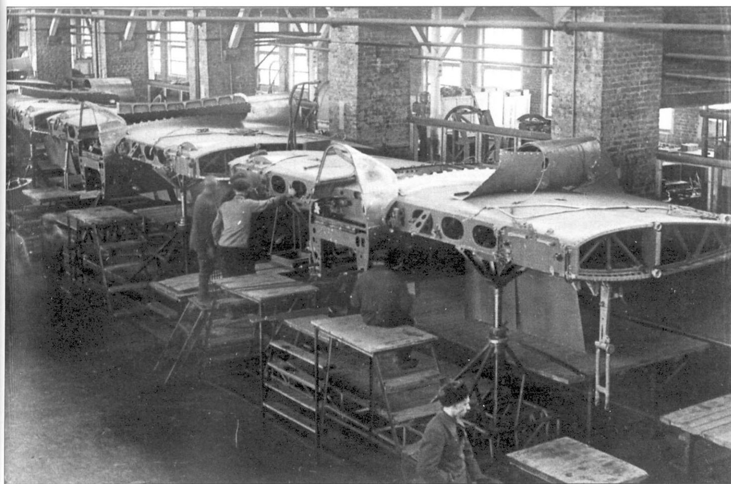
Сборка центропланной секции фюзеляжа Ту-2 на заводе №166. Омск, 1942 г.
