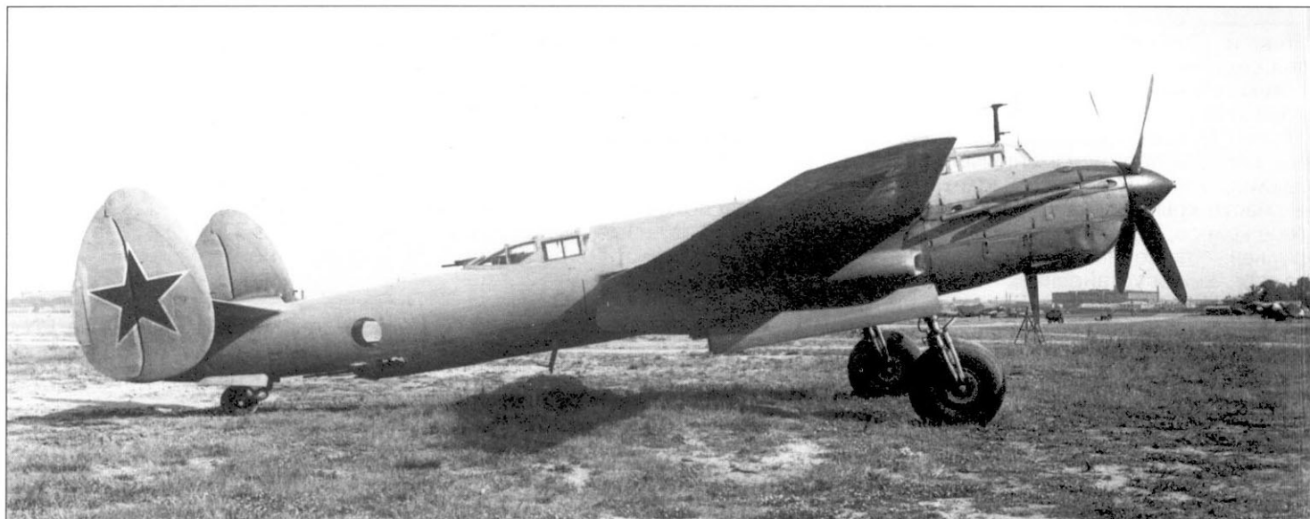
На фото на этой странице: «68» с двигателями АМ-39ФН2 под обозначением Ту-10 построили небольшой серией
