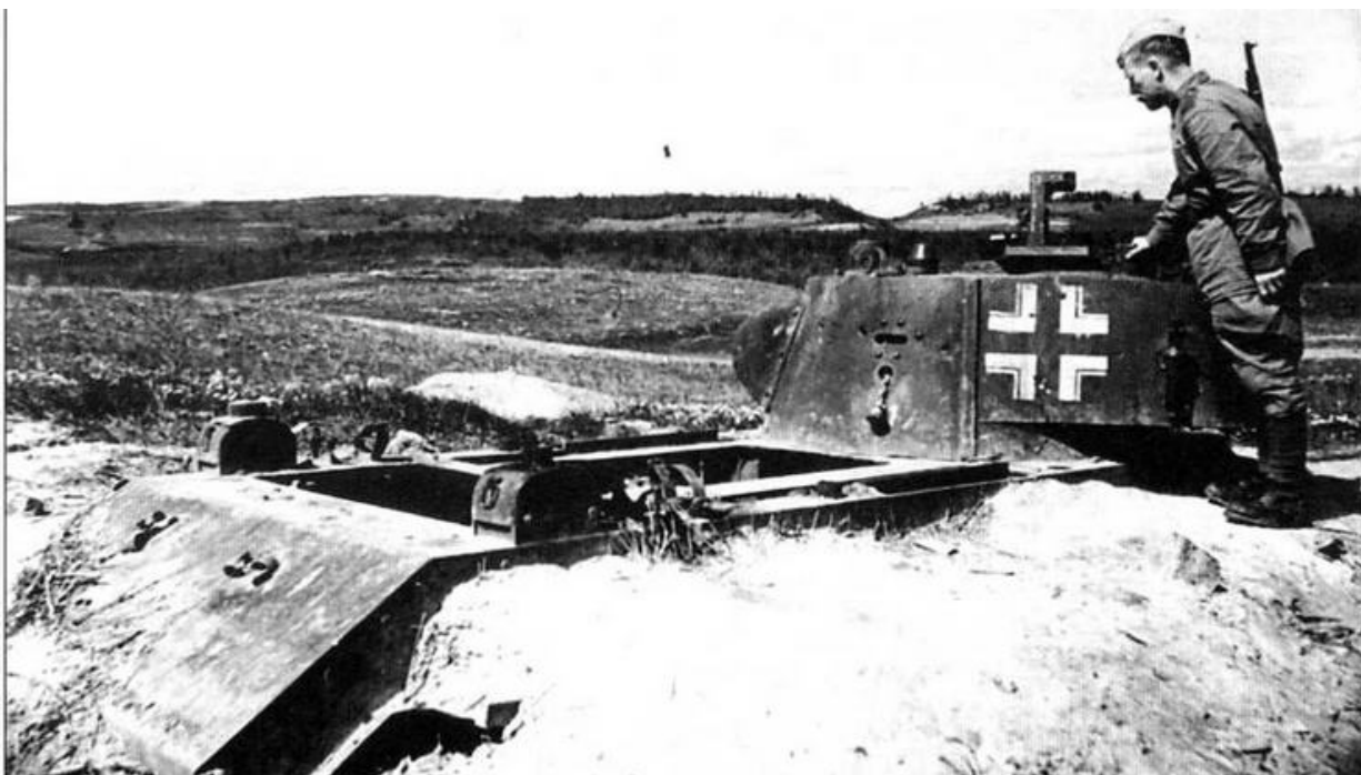
Красноармеец осматривает вкопанный в землю танк БТ-7 обр.1937 г., использовав шийся немцами в качестве неподвижной огневой точки. 1943 год
