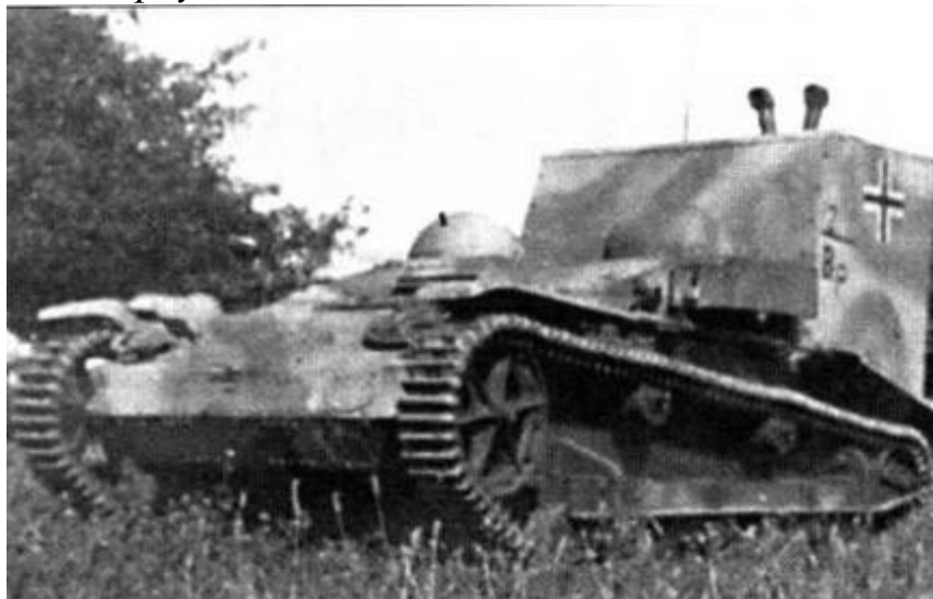
Подвижной командный и наблюдательный пункт, выполненный на базе легкого тягача UE(f). В прямоугольной рубке, размещенной в корме корпуса машины, находились стереотруба и радиостанция
