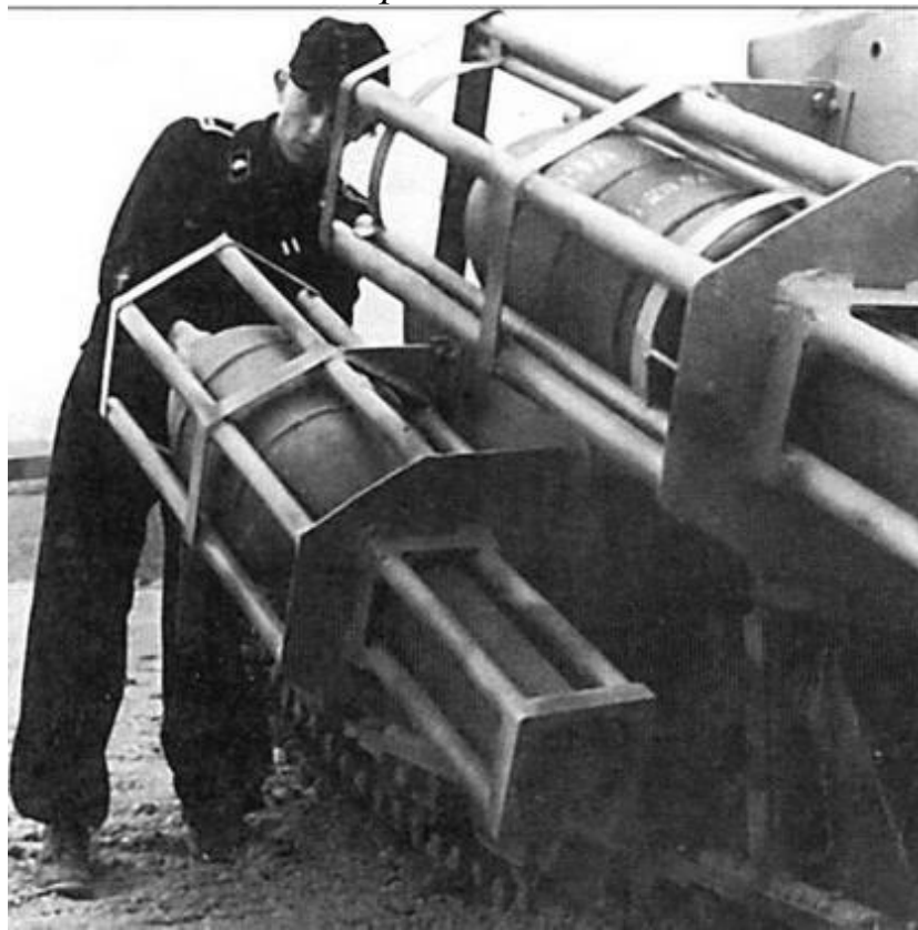
В 205-м танковом батальоне 11 танков 384(f) были оборудованы пусковыми рамами для 280- и 320-мм реактивных снарядов. На фото слева запечатлен момент выстрела
