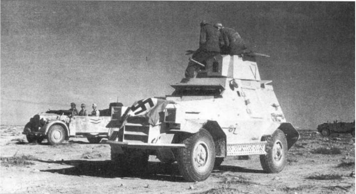
Трофей Вермахта — южно-африканский броневедомитель Мармон- Херрингтон Mk III. На капоте машины растянута так называемая Fliegersichttuch — «полотнище для опознавания авиацией»
