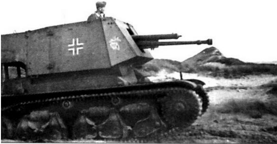
Немецкая самоходная артиллерийская установка с 47-мм чехословацкой противотанковой пушкой на шасси французского танка R35
