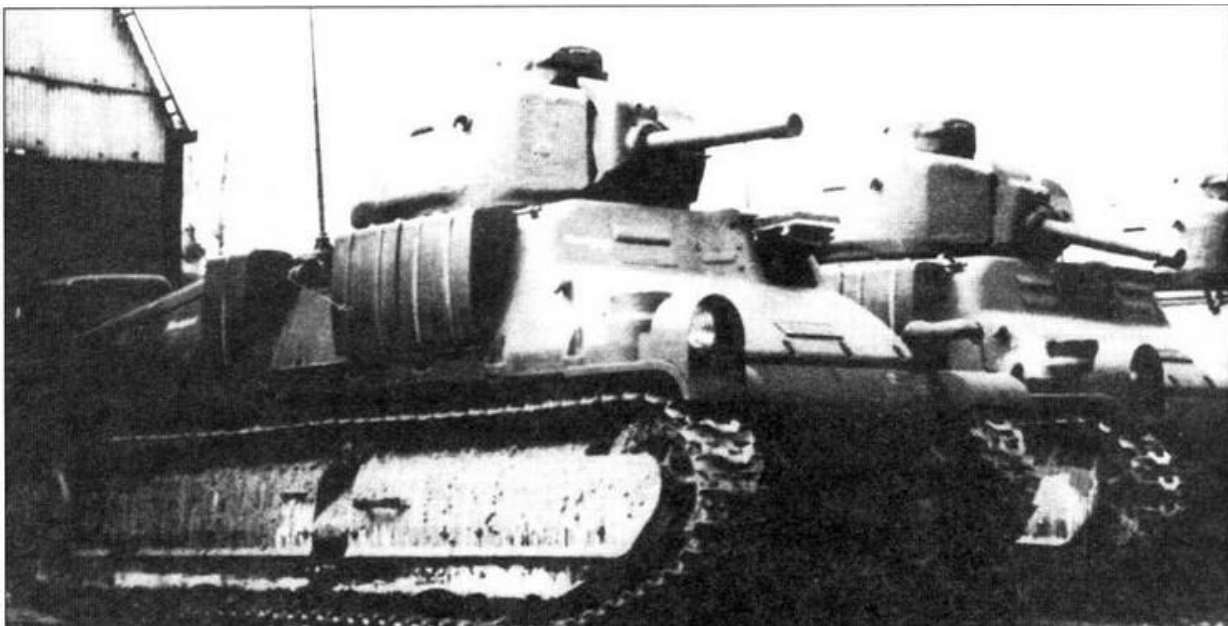
Первые танки S35, подготовленные для службы в Вермахте. Танки выкрашены в серый цвет, оснащены радиостанциями и фарами Notek. На правом борту укреплены характерной формы ящики для амуниции
