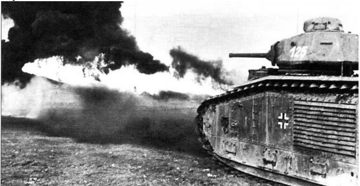
Огнеметный танк В2(Ф1) в бою. Дальность стрельбы из огнемета достигала 45 м
