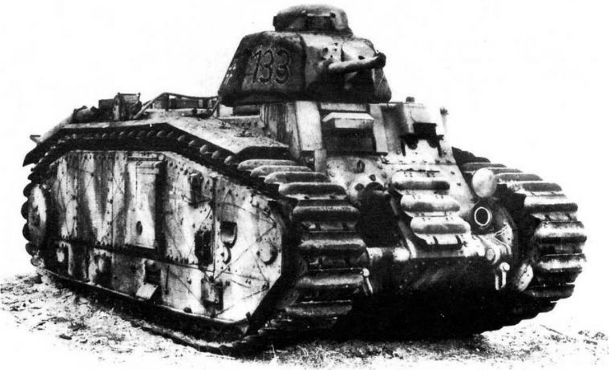
Серийный огнеметный танк В2(Ф1) из состава 213-го танкового батальона. Хорошо видны установка огнемета и смотровой прибор стрелка-огнеметчика
