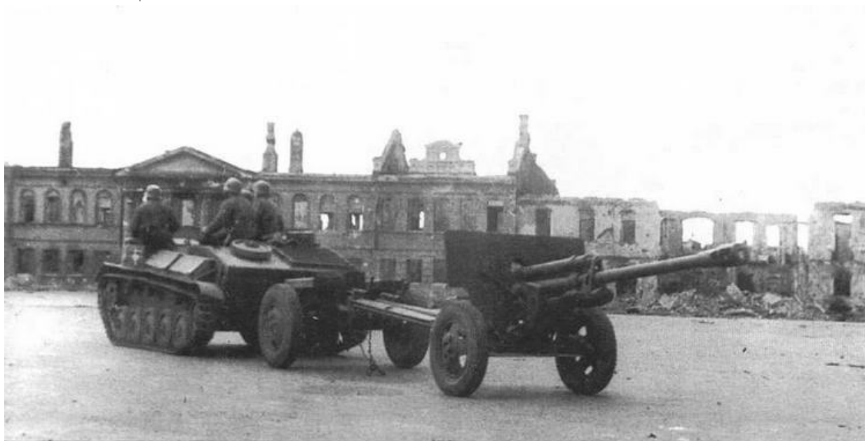
Тягач — трофейный советский танк Т-70 без башни — буксирует трофейную же советскую 76-мм пушку ЗИС-3. Ростов-на-Дону, 1942 год
