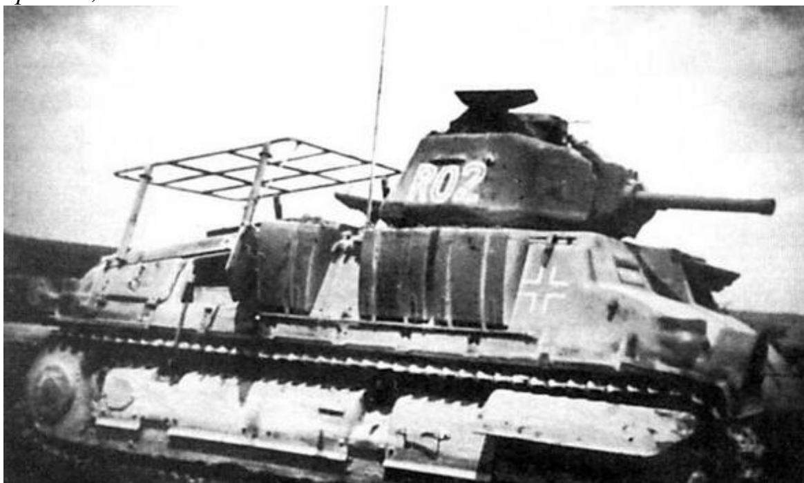
Командирский танк, оснащенный второй радиостанцией (ее рамочная антенна закреплена на крыше МТО). Вместо орудия установлен его деревянный макет. Франция, 1941 год
