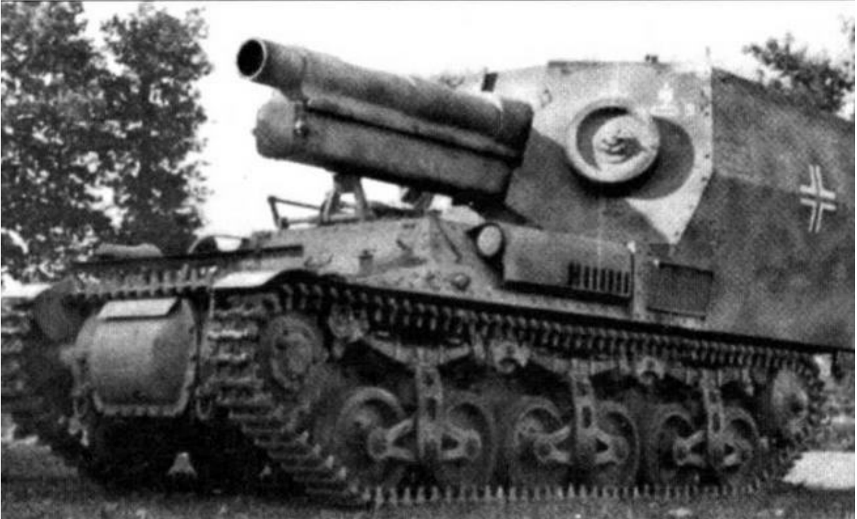
150-мм самоходная гаубица 15-см-sFH 13/1 на базе артиллерийского тягача Lorraine-S(f). На передних стенках броневой открытой сверху рубки навешены запасные опорные катки
