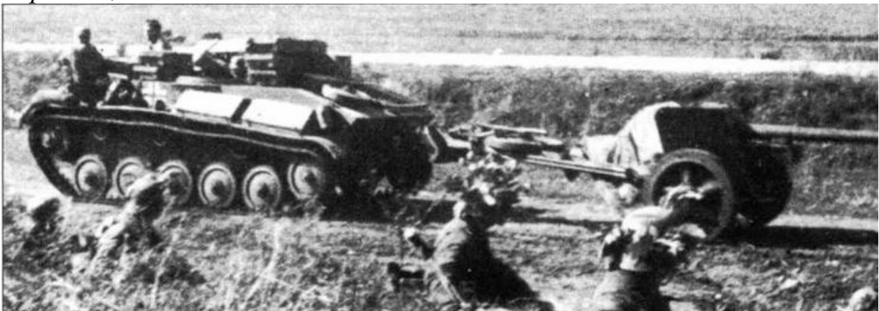
Переделанный в тягач легкий танк Т-70 буксирует 75-мм противотанковую пушку Рак 40
