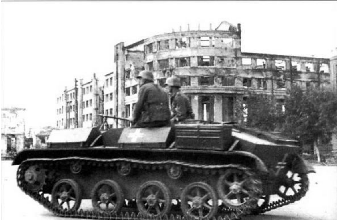
Этот, лишенный башни, трофейный Т-60 используется как легкий бронетранспортер, вооруженный пехотным пулеметом MG34. Воронеж, лето 1942 года
