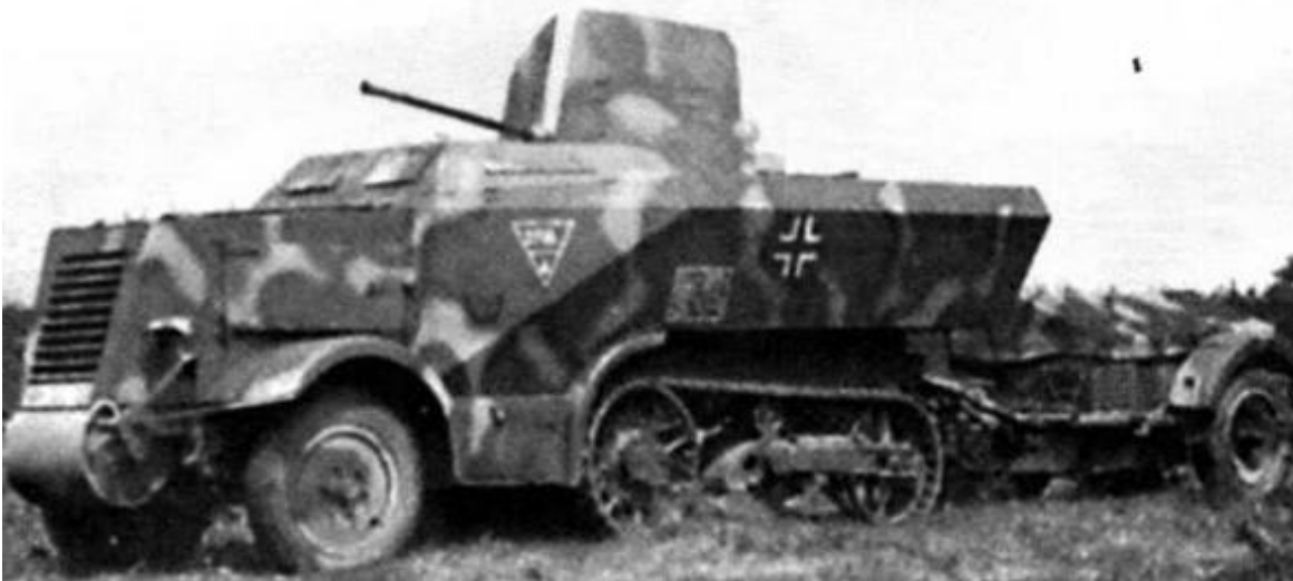
Зенитная самоходная установка на базе U304(f), вооруженная 20-мм автоматической зенитной пушкой Flak 38. Машина буксирует прицеп с боеприпасами
