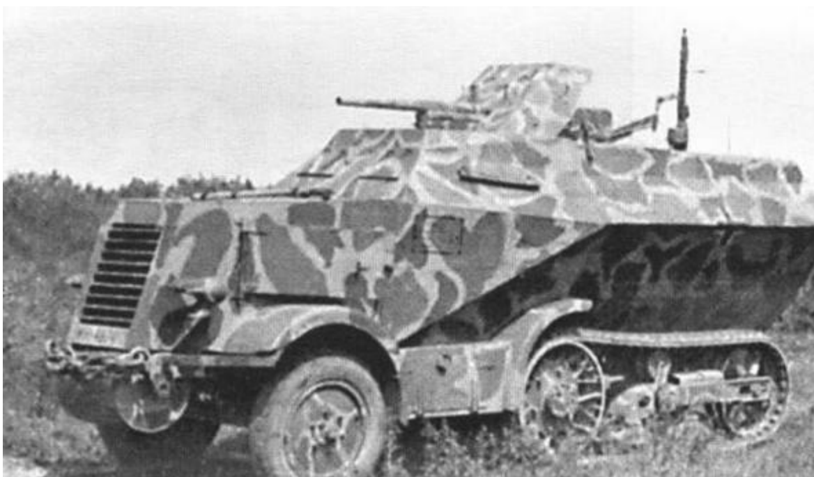
Машина командира роты, вооруженная 37-мм противотанковой пушкой Рак 36 и пулеметом MG34 на зенитной установке
