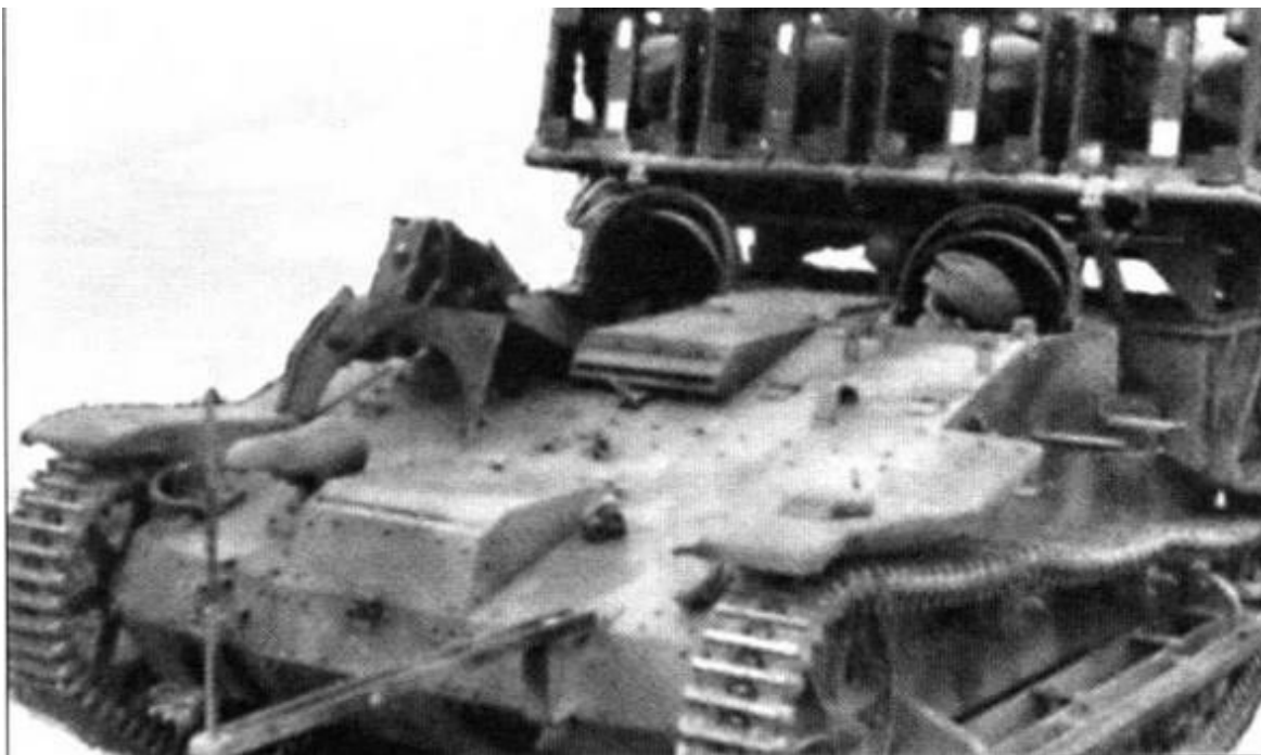
Самоходная пусковая установка для 280- и 320-мм реактивных снарядов на шасси трофейного французского легкого тягача Renault UE(f). Второй вариант установки предусматривал крепление пусковых рам по бортам корпуса машины
