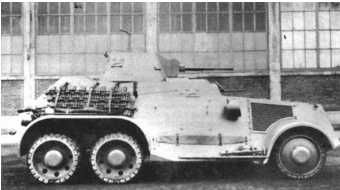
Тяжелые бронеавтомобили Landsverk 181 и 182 внешне были очень похожи, отличаясь друг от друга в основном формой решеток и жалюзи моторного отсека
