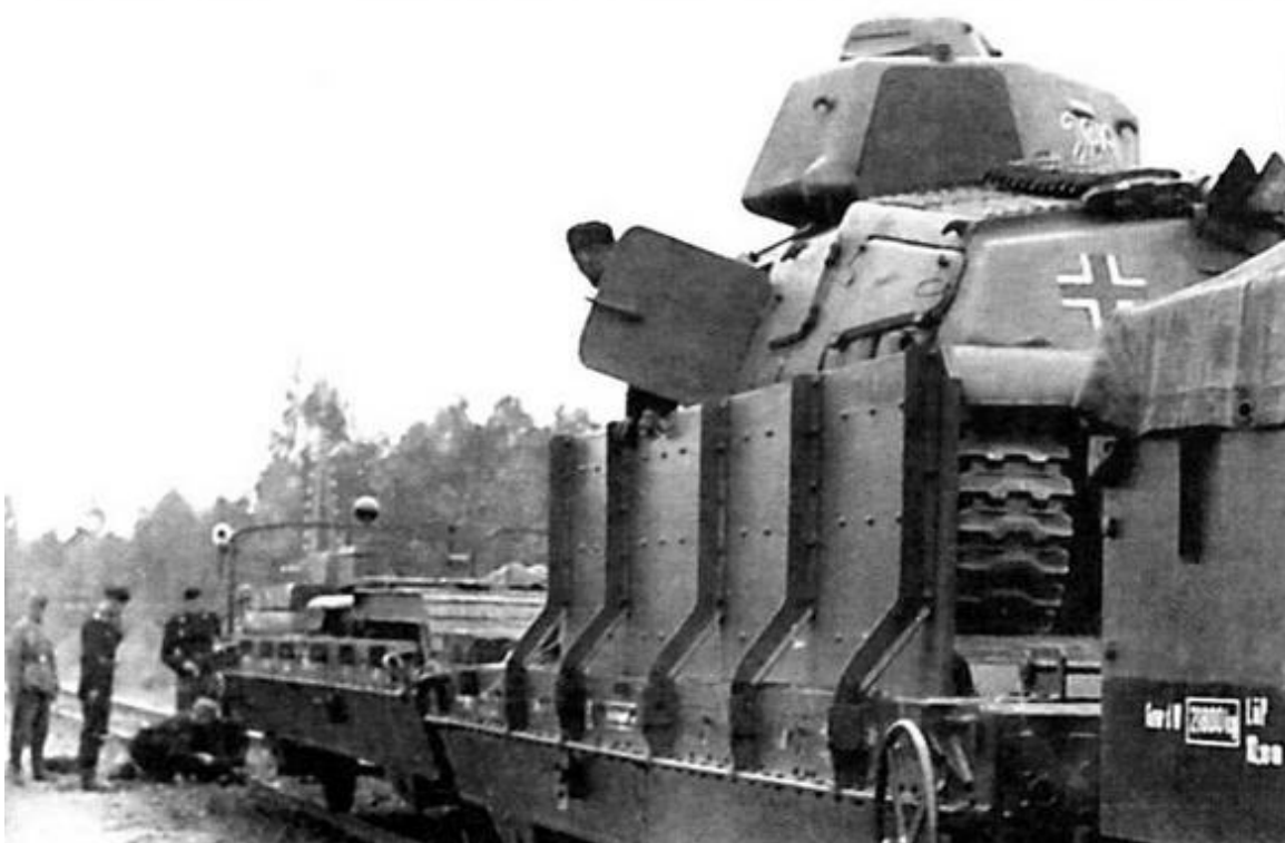
Танк S35 на платформе бронепоезда № 28. Хорошо видно броневое прикрытие ходовой части танка
