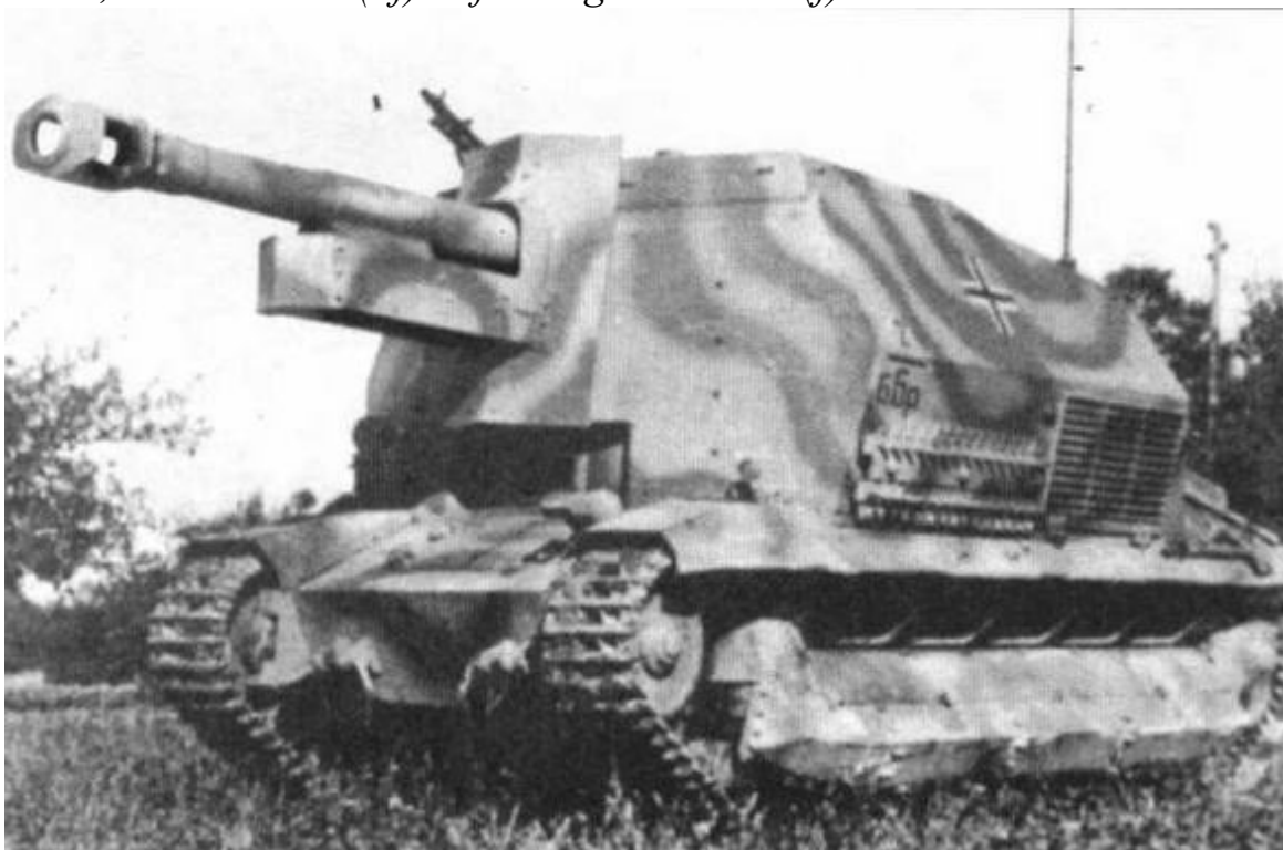
105-мм самоходная гаубица на базе трофейного французского танка FCM.
