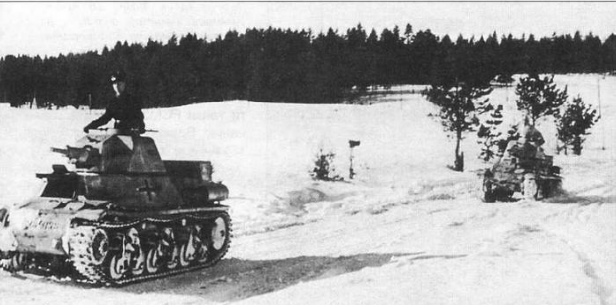
Танки 38Н(ф) 2-го батальона 202-го танкового полка во время учебных занятий во Франции. 1941 год. На всех машинах куполообразные командирские башенки заменены люками с двухстворчатыми крышками, установлены немецкие радиостанции
