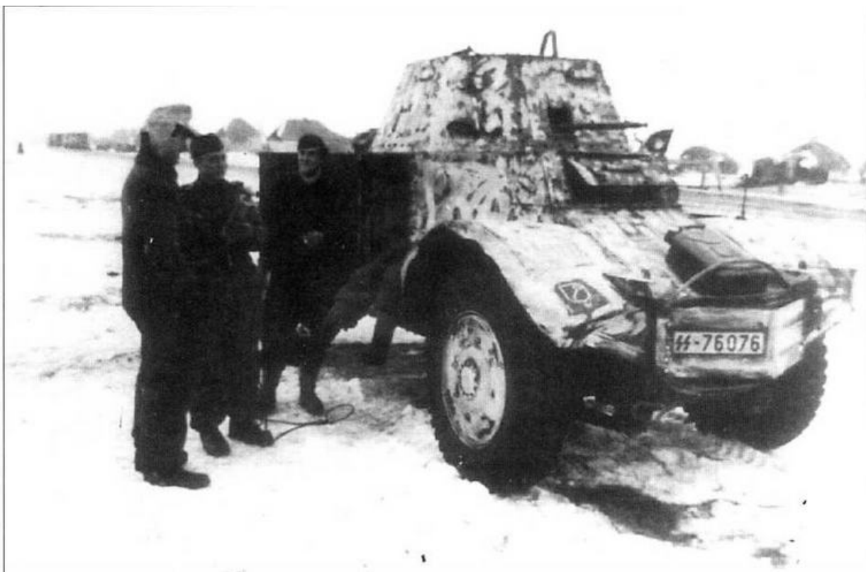
Радиомашина на базе Panhard 178(f) из состава 1-й танковой дивизии СС «Лейбштандарт Адольф Гитлер». Вместо башни машина оснащена неподвижной рубкой, в лобовом листе которой установлен пулемет МС34
