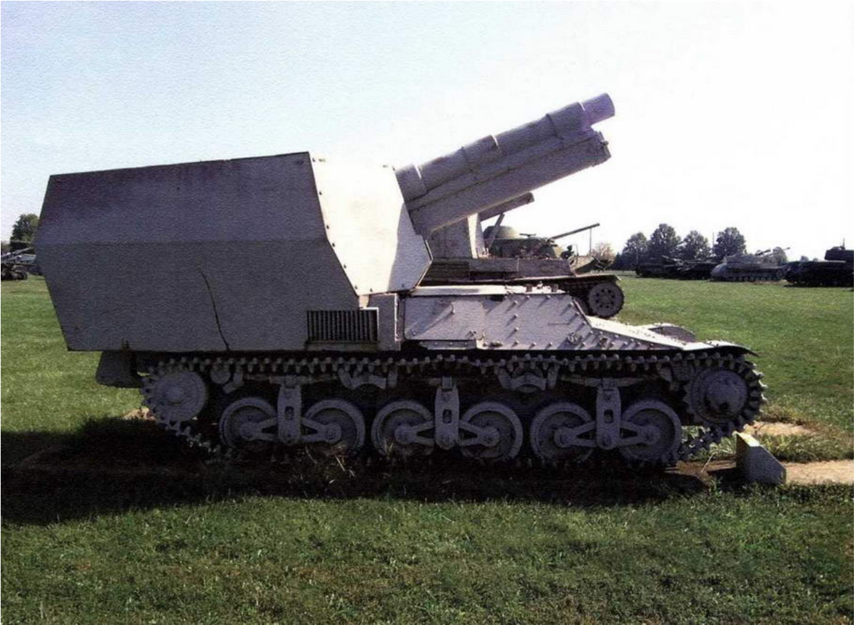
150-мм самоходная гаубица 15-см-sFH 13/1 на базе артиллерийского тягача Lorraine-S(f). Военный музей на Абердинском полигоне, США, 2006 г.
