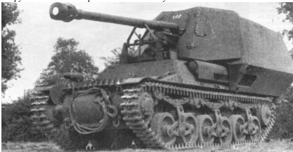
75-мм самоходная противотанковая пушка на базе артиллерийского тягача Lorraine-S(f). В войсках эти системы получили
