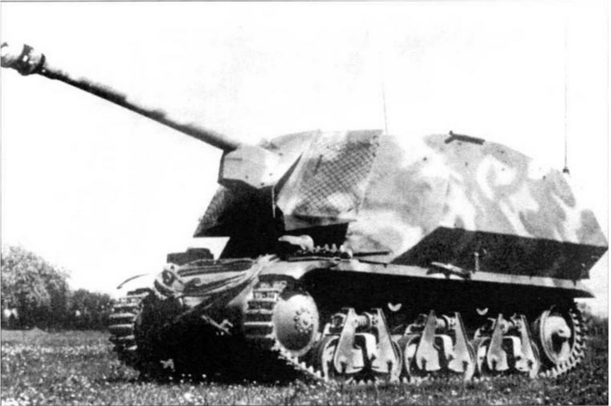
Самоходно-артиллерийская установка Marder I, вооруженная 75-мм противотанковой пушкой Pak 40
