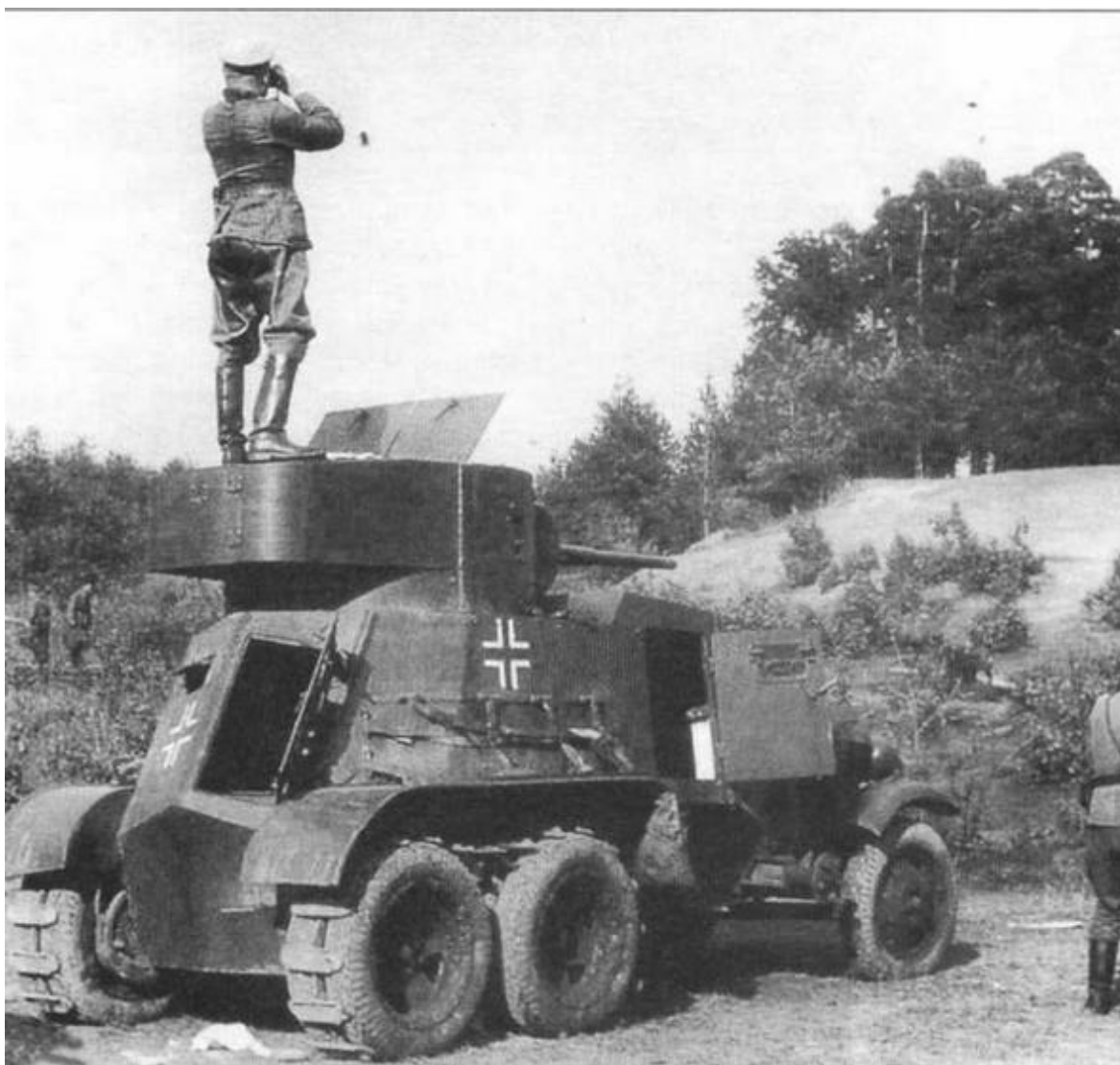
Немецкий офицер использует в качестве наблюдательного пункта башню трофейного бронеавтомобиля БА-3. 1942 год. На колеса задних мостов надеты гусеницы «Оверолл»
