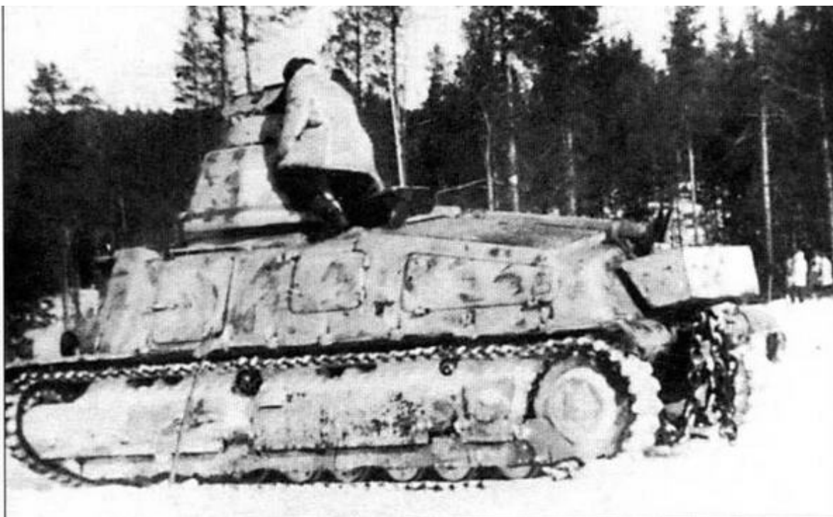
Выкрашенный в белый цвет средний танк 35S(f) из состава 211-го немецкого танкового батальона. Оповестительным знаком для машин этого батальона была цветная полоса, нанесенная по периметру баини
