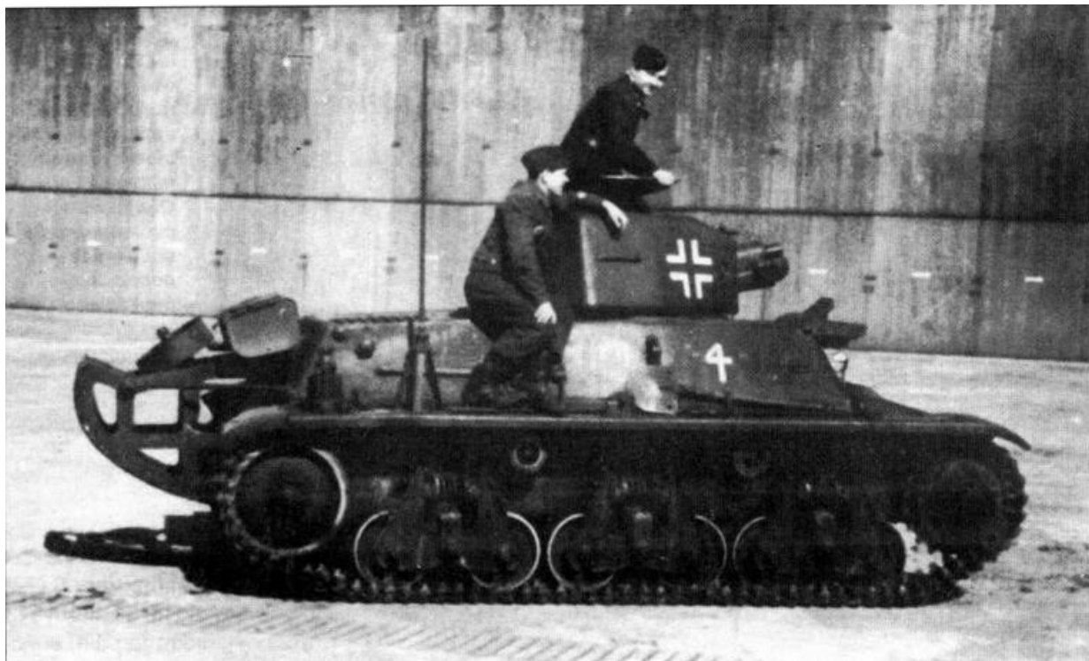
Трофейный танк 38H(f) одной из частей Люфтваффе. Машина вооружена 37-мм пушкой SA18, оборудована «хвостом» и радиостанцией
