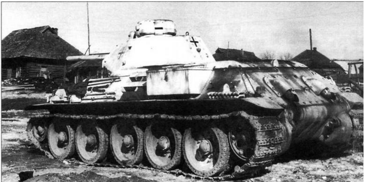
Вместо большого люка на крыше башни этого танка Т-34 установлена командирская башенка, заимствованная у танка Рз.НІ
