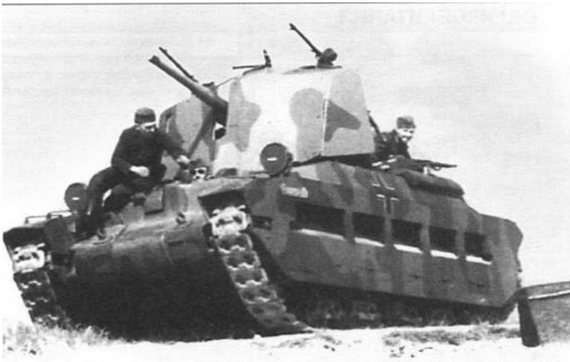
Трофейная «Матильда», переделанная в САУ, вооруженную 50-мм танковой пушкой
