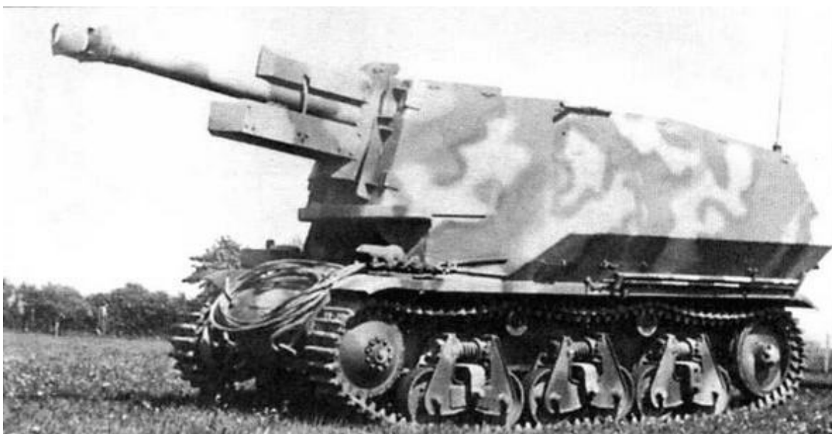
105-мм самоходная гаубица leFH 18 на шасси легкого танка 38H(f)
