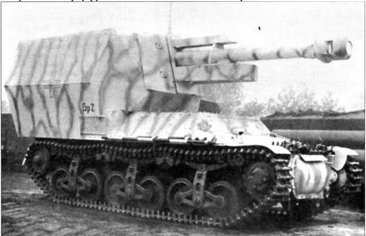
150-мм самоходная гаубица 15-см-sFH 13/1 на базе артиллерийского тягача Lorraine-S(f). На передних стенках броневой открытой сверху рубки навешены запасные опорные катки
