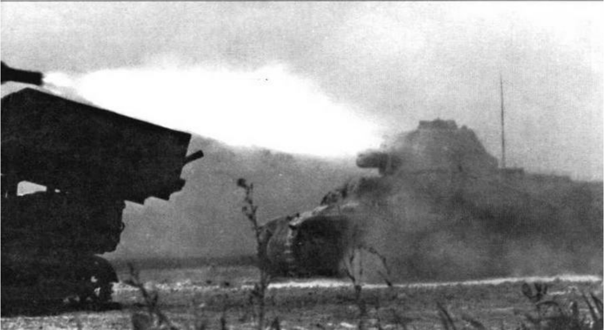
В 205-м танковом батальоне 11 танков 384(f) были оборудованы пусковыми рамами для 280- и 320-мм реактивных снарядов. На фото слева запечатлен момент выстрела
