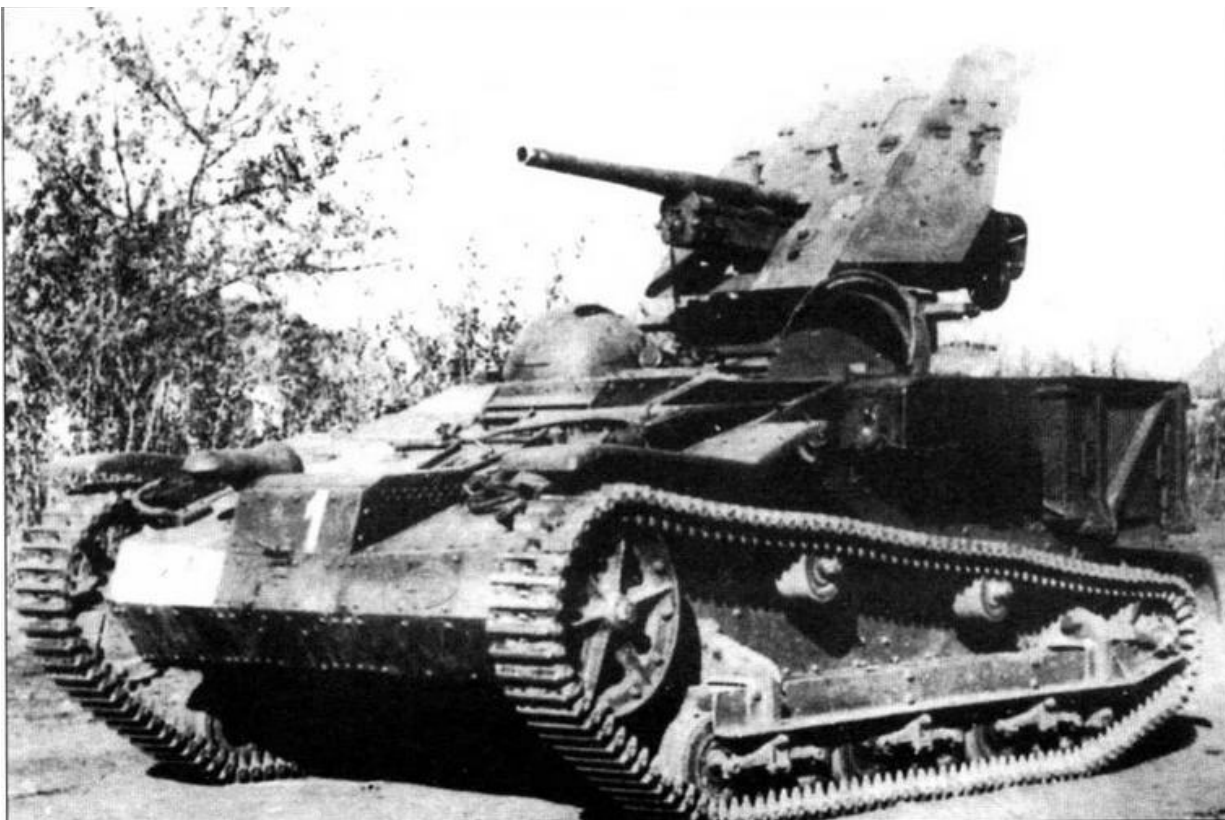
Наиболее удачный вариант переделки французского легкого тягача Renault UE(f) — самоходная артиллерийская установка, вооруженная 37-мм противотанковой пушкой Раk 36
